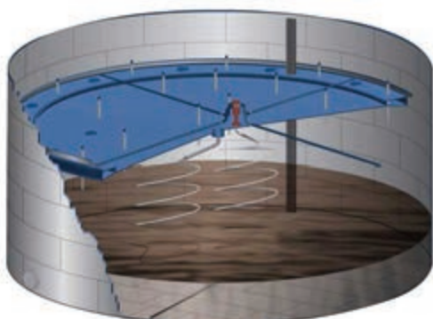
شکل ۴-۱۷- مخازن سقف شناور بیرونی
