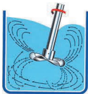
شکل ۳-۲۸- قرار دادن همزن خارج از مرکز و افزایش آشفتگی سیال
