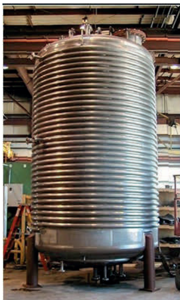
شکل ۵-۴- راکتور ناپیوسته صنعتی با سامانه گرمایی
