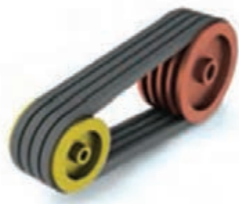
شکل ۲۷- مکانیزم چرخ و تسمه (دو پولی و چند تسمه کنار هم)
