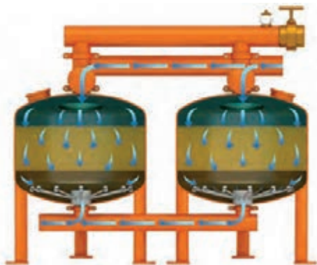
شکل ۶۰- روش تصفیه شنی و تمیز کردن شن‌ها
