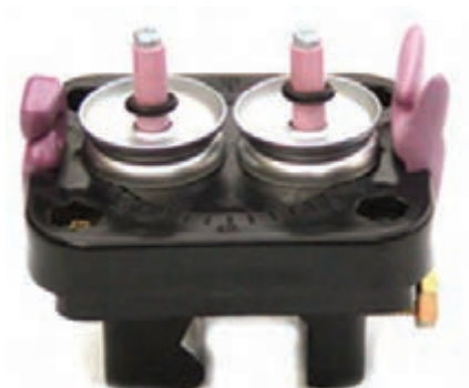
شکل ۳۶ - دستگاه کشیدگی نخ با صفحه و فنر
