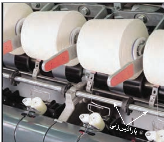
شکل ۳۰ - پارافین زدن به نخ
