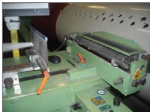
شکل ۱۴- ساپورت در چله پیچی بخشی
