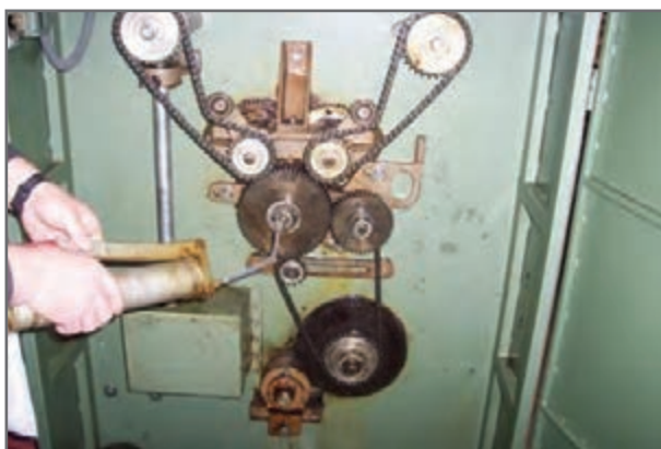
شکل ۱۷- روغن کاری و گریس کاری زنجیرها
