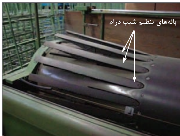
شکل ۲۱- تنظیم درام شیب‌دار
