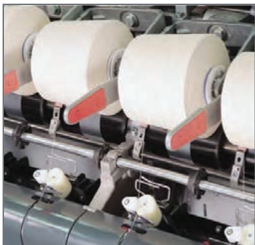
شکل ۲۵ - راهنمای متحرک پیچش نخ (تراورس)
