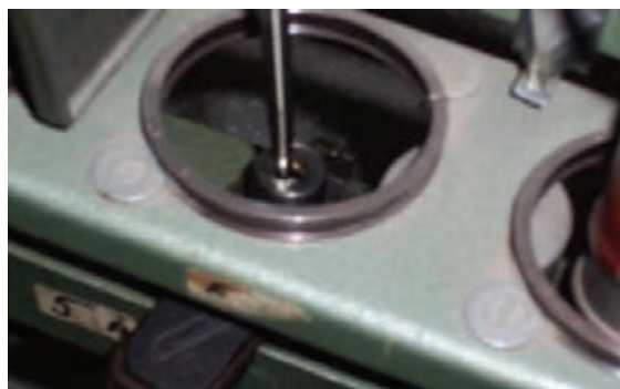
شکل ۱۶ - روغن کاری یاتاقان دوک
