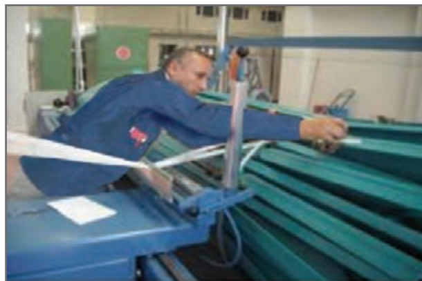
شکل ۲۲- وصل کردن نخ‌ها به میخ روی درام
