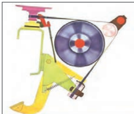
شکل ۲۹ - تجهیزات ترمز گرفتن دوک
