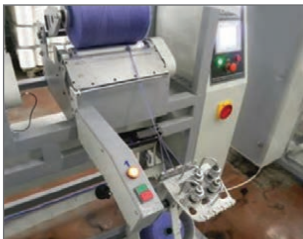
شکل ۴ - پولکی‌های کشیدگی نخ
