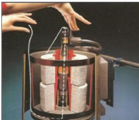
شکل ۲۱ - دو بوبین نخ یک لا داخل کاسه
