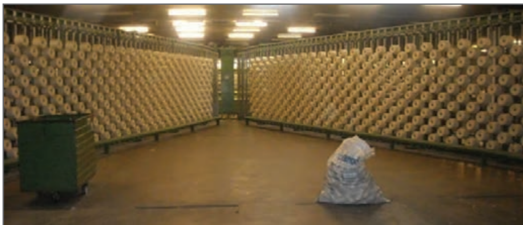
شکل ۲۳- قفسه V شکل بوبین
