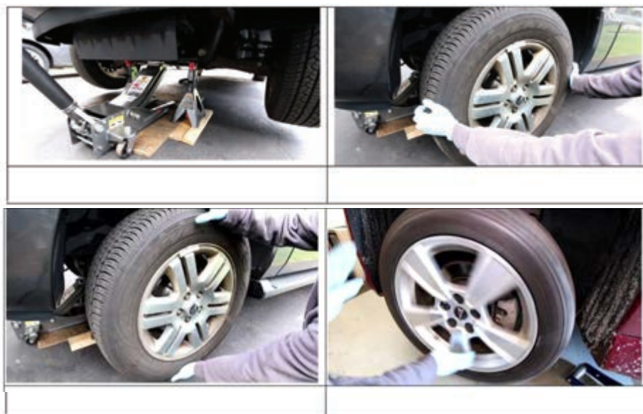
شکل ۱۷- مراحل بررسی بلبرینگ یا رولبرینگ چرخ خودرو در حالت ایستا
