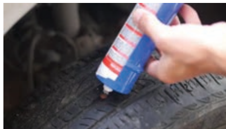
شکل ۲۷- مراحل پنچرگیری تایر بدون تیوب
