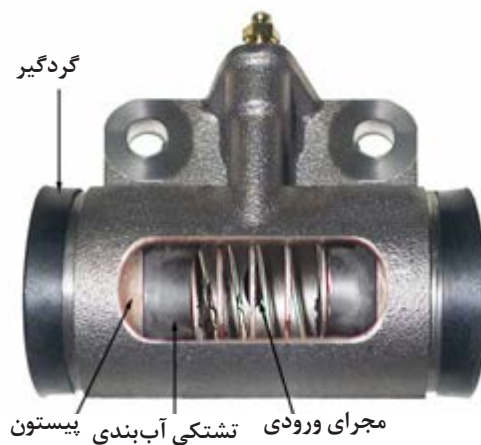
شکل ۳۸- سیلندر ترمز (کفشکی)
