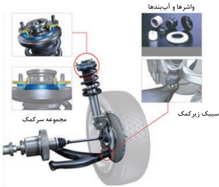
شکل ۳۲- برخی نقاط قابل تعمیر تعلیق مک فرسون
