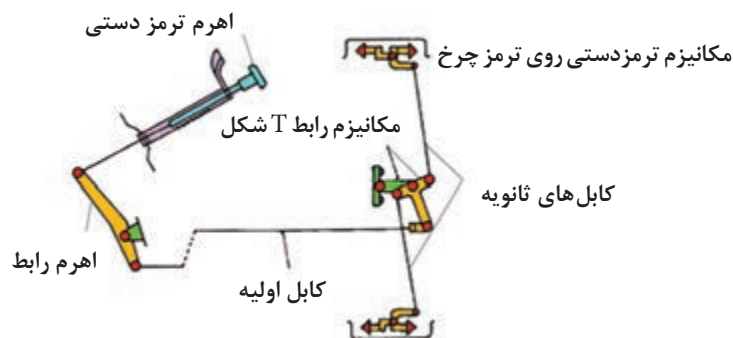
شکل ۲۱- مکانیزم ترمز پارک کابلی با واسط T شکل
