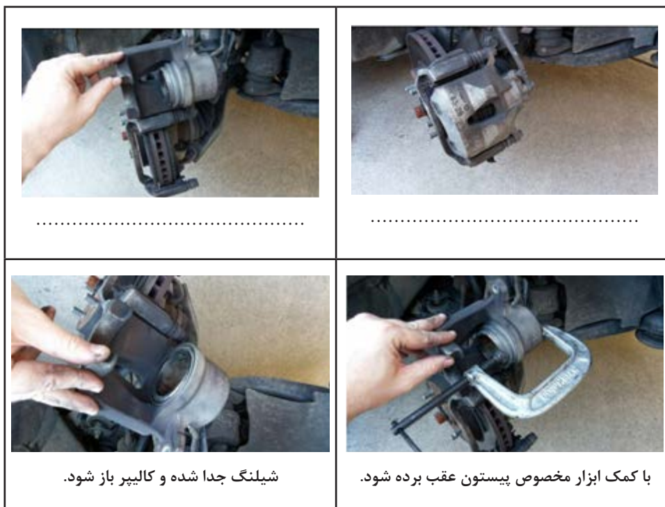
شکل ۳۳- مراحل باز کردن کالیپر ترمز
