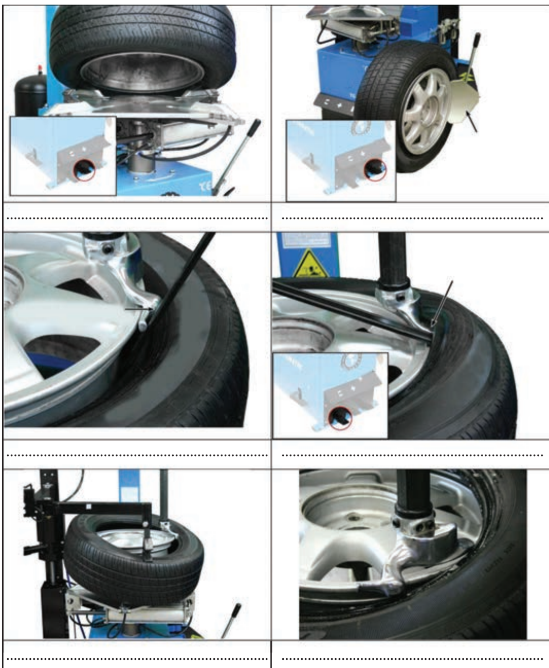
شکل ۳۴- مراحل استفاده از دستگاه لاستیک در آر پنوماتیکی
