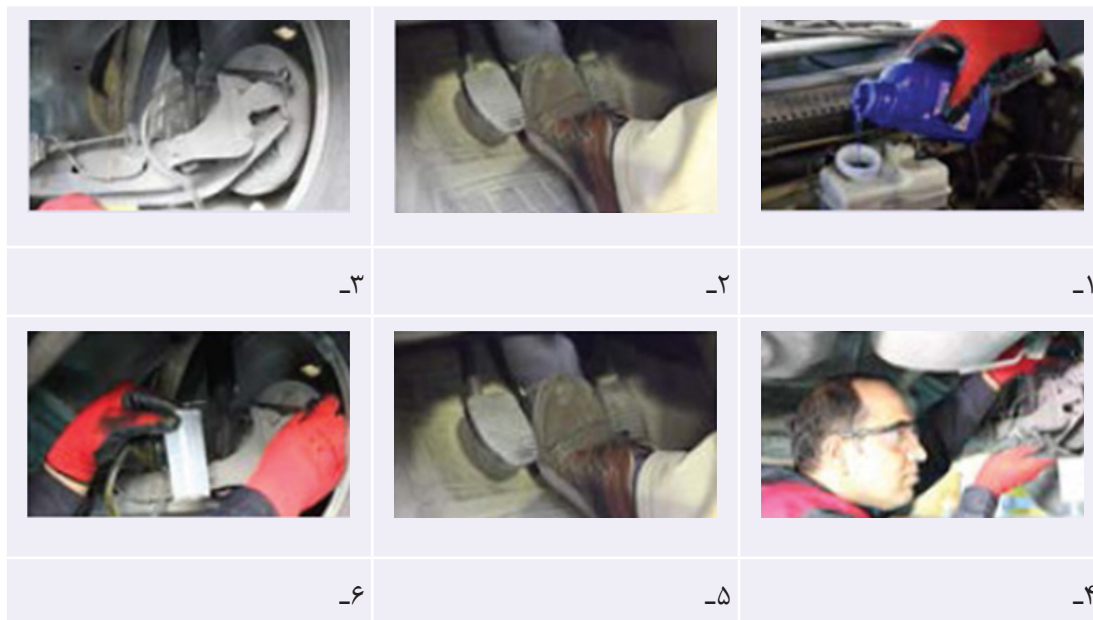
شکل ۱۹- مراحل هواگیری دستی مدار هیدرولیک ترمز
