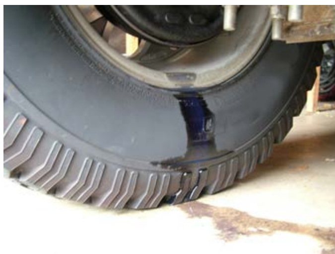
شکل ۴۱- وجود مایع اطراف چرخ عقب
