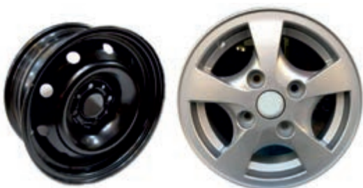
شکل ۱۰- رینگ آلومینیومی و فولادی
