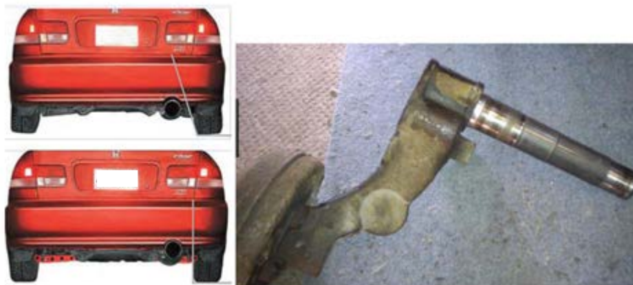
شکل ۴۳- خرابی بوش‌ها و تأثیر آن روی چرخ
