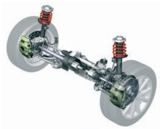
شکل ۲۶- سیستم تعلیق غیر فعال
