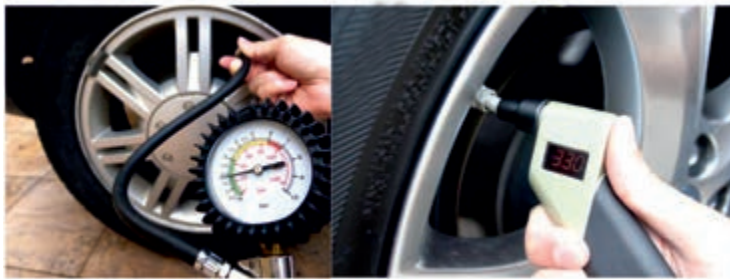
شکل ۲۱- شیوه بررسی و تنظیم فشار باد تایر
