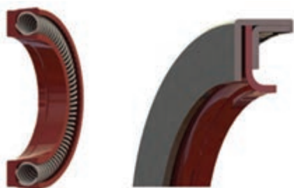
شکل ۹- کاسه نمد بدون فنر و با فنر
