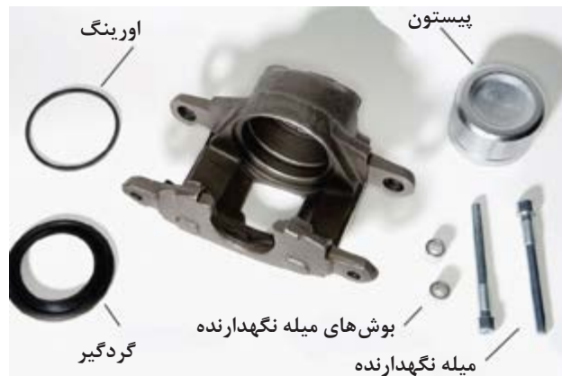
شکل ۳۶- اجزای مجموعه هیدرولیکی کالیپر ترمز
