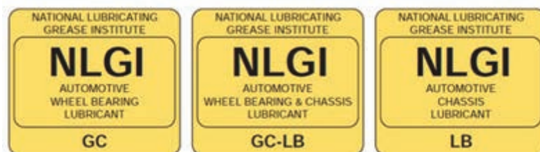
شکل ۱۲- برخی نمادهای گریس مورد استفاده در خودرو
