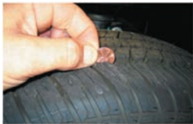
شکل ۱۷- نحوه اندازه‌گیری تقریبی شیار تایر
