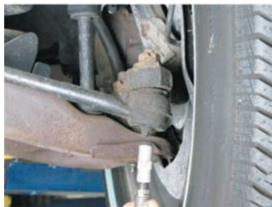
شکل ۳۳ - روش گریس کاری سیبک
