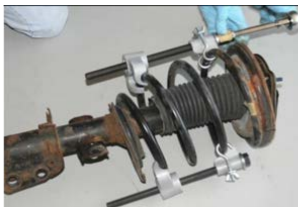
شکل ۳۳- برخی نکات باز کردن سیستم تعلیق مک فرسون
