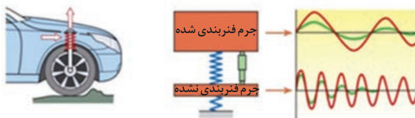
شکل ۲۴- عملکرد سیستم فنربندی تعلیق
