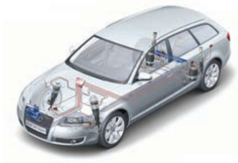
شکل ۲۸- سیستم تعلیق فعال
