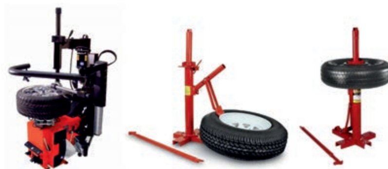
شکل ۳۳- دستگاه لاستیک درآر دستی و پنوماتیکی
