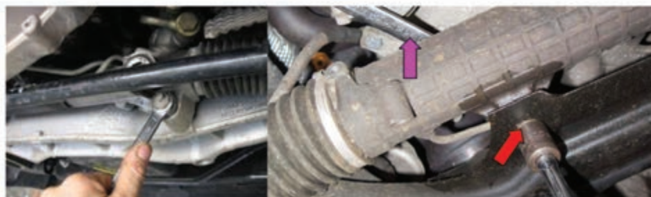
شکل ۲۰ - سفت کردن اتصالات جعبه فرمان
