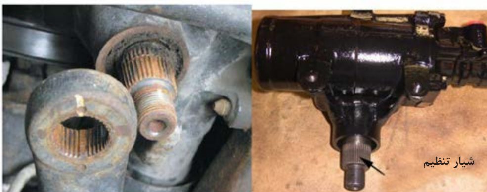
شکل ۳۲- هزار خار محور خروجی جعبه فرمان
