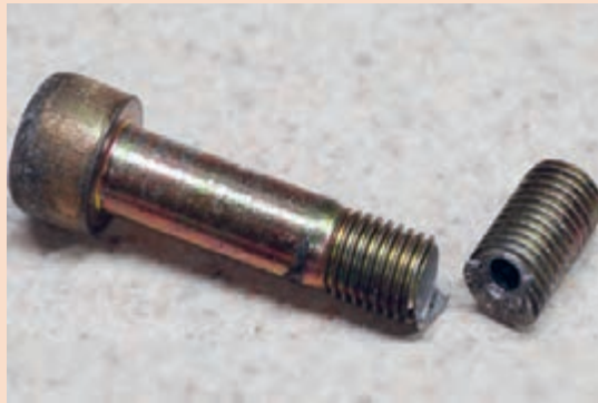
شکل ۳۰-۵ یک پیچ بریده شده بر اثر بارگذاری پیچشی
