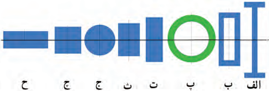
شکل ۵-۲۳ انواع سطح مقطع در خمش
