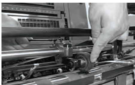
شکل ۳۲- تنظیم فشار قرقره
