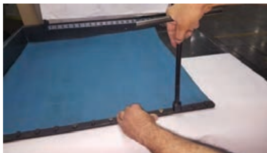
شکل ۶۰- نصب گیره لاستیک
