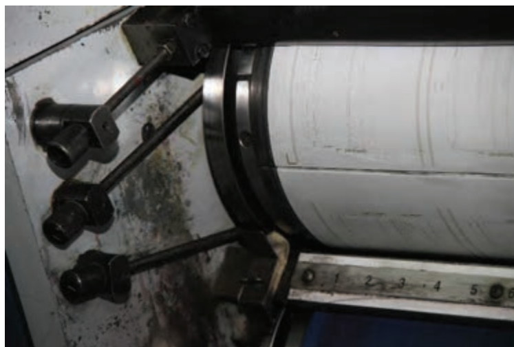
شکل ۵۳- شیار سیلندر (لبه‌های پلیت)
