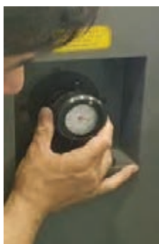
شکل ۳۸- گیج تغییر زاویه سیلندر ترانسفر
