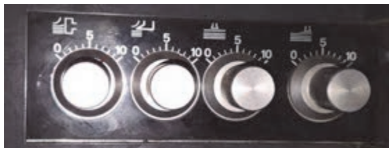
شکل ۱۹- شیرهای تنظیم باد
