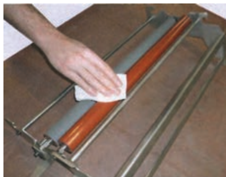
شکل ۳۰ - تمیز کردن نوردهای فیوزر
