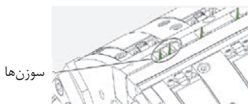
شکل ۳۸- سوزن‌های روی سیلندر
