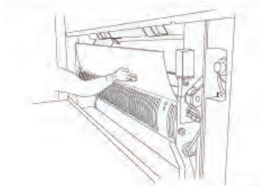
شکل ۷۳- نصب آستراگون به وسیله پلیت
