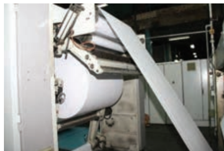
شکل ۹- سیستم عملکرد تغذیه بدون توقف (Splicer)
