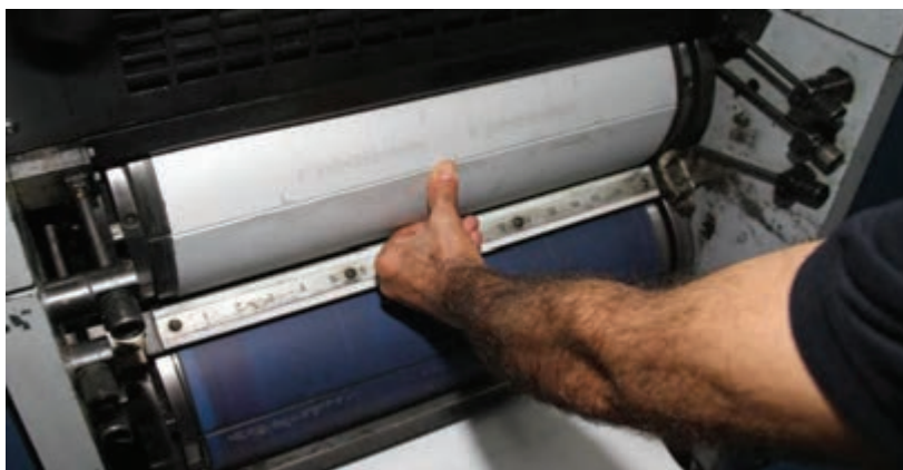
شكل ۷۱- قرارگيري ته كار پليت در شيار سيلندر
