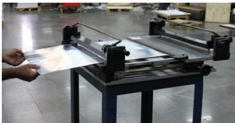
شکل ۶۲- قرار دادن پلیت در دستگاه خم‌کن
