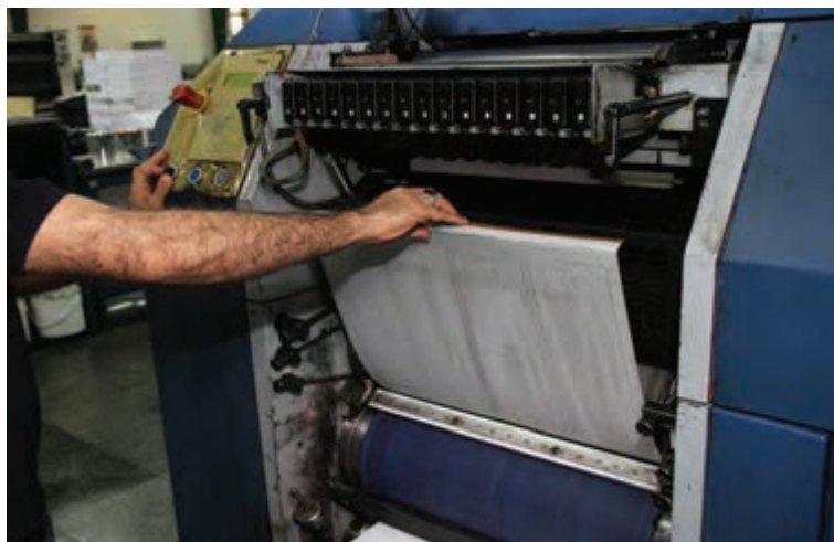
شکل ۵۶- نگاه‌داشتن پلیت برای بازکردن از روی سیلندر
