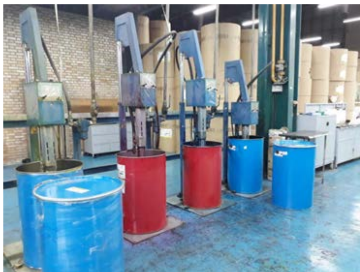
شکل ۷۷- مکانیزم تغذیه خودکار مرکب
