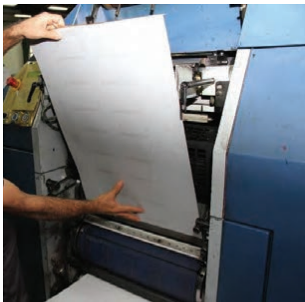
شکل ۶۹- قرار دادن لب کار در شیار سیلندر
