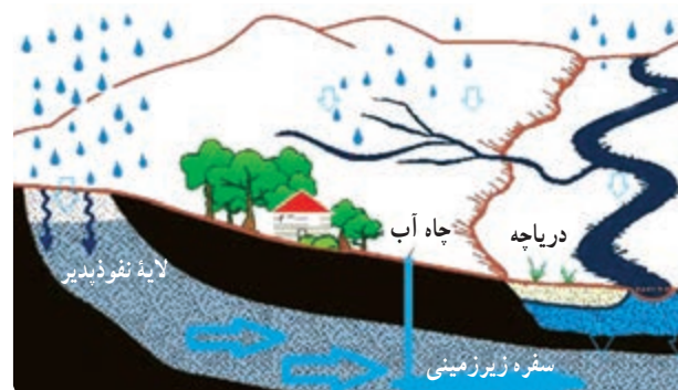
شکل ۴۴-۱- چگونگی شکل‌گیری سفره‌های آب زیرزمینی
