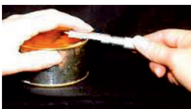
شکل ۴- اندازه‌گیری عرض دوخت
