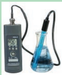
شکل ۱۲- pH متر دستی
