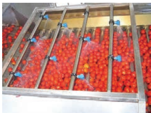
شکل ۶- شست‌وشو با پاشش آب
