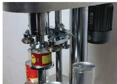
شکل ۵- دستگاه دربندی مضاعف
