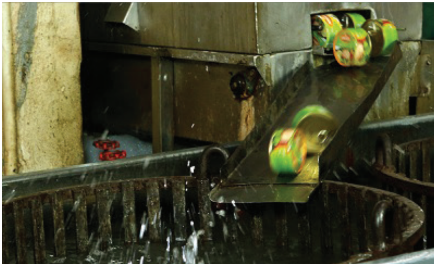
شکل ۲- وارد شدن قوطی‌های فلزی به سبدهای اتوکلاو
