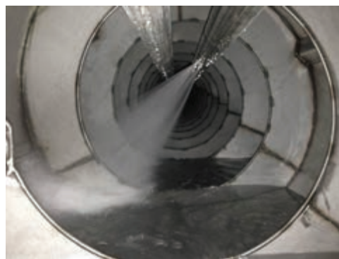
شکل ۵- شست‌وشوی افشانی با استوانه گردان
