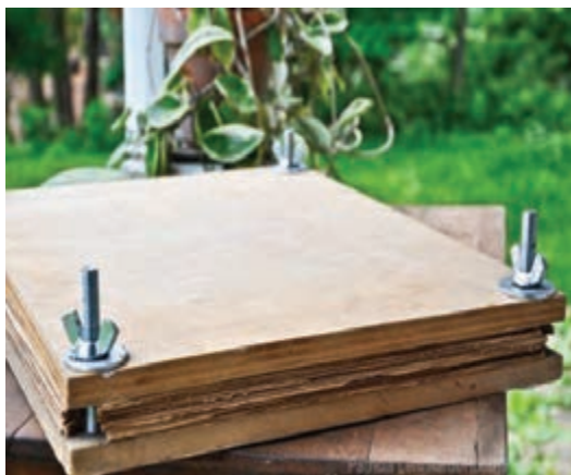
شکل ۱۷- تخته پرس مخصوص خشک کردن نمونه‌های گیاهی
