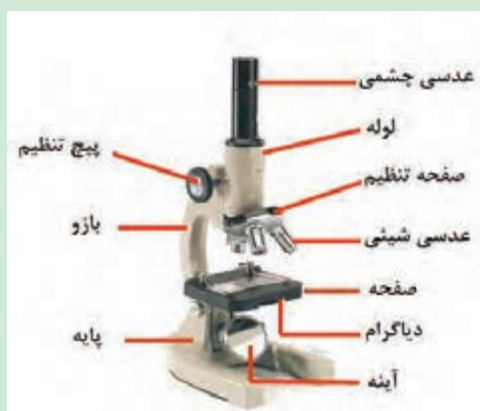
شکل ۲۳- اجزای مختلف نوعی میکروسکوپ
