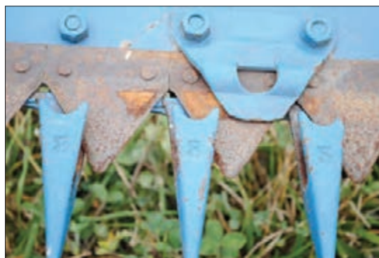
شکل ۱۰- موقعیت انگشتی و تیغه در دروگر شانه‌ای
