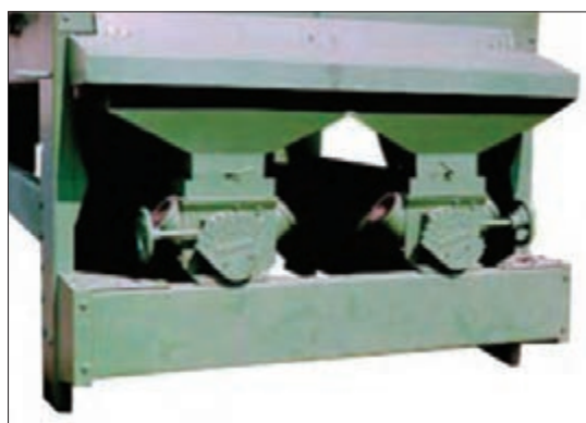
شکل ۳۶- تنظیم کننده‌های استوانه حفره‌دار
