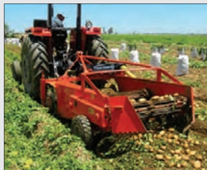
شکل ۱۷- برداشت سیب‌زمینی با سیب‌زمینی‌کن نقاله‌ای
