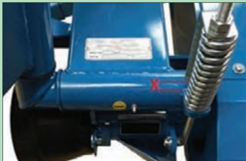
شکل ۲۱- شاخص تنظیم کشش تسمه دروگر استوانه ای
