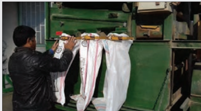
شکل ۳۷- نصب کیسه‌های بارگیری روی کیسه‌بندها
