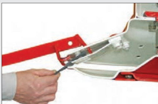
شکل ۲۲- شکل شماتیک از تعویض تیغه دروگر استوانه ای
