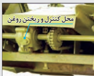
شکل ۴۷- جعبه دنده دوکفه ای
