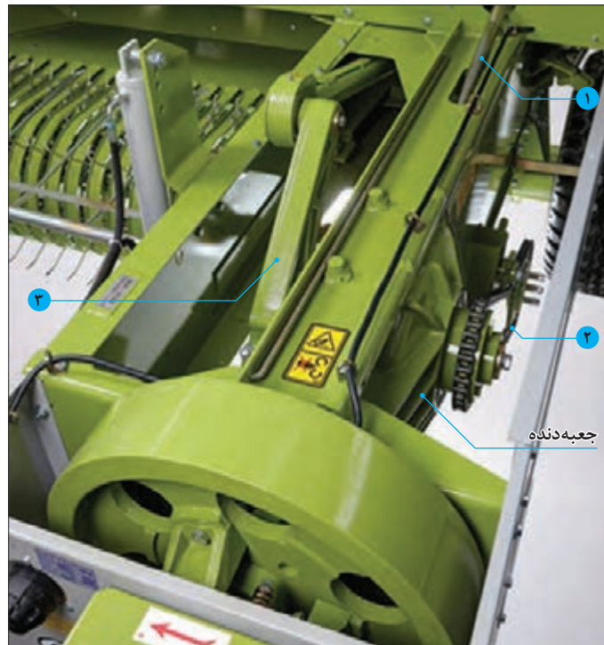
شکل ۸۲- مسیر انتقال توان در بسته‌بند
