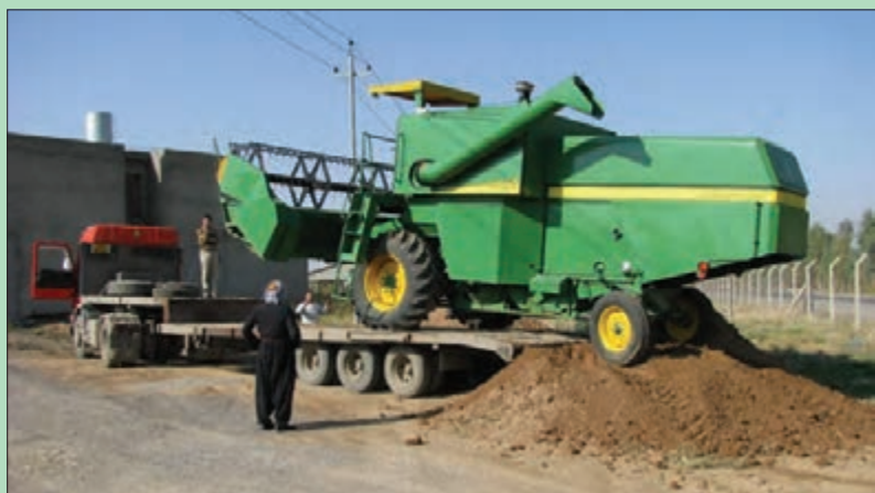
شکل ۳۵- نحوه قرار گرفتن کمباین روی یدک کش
