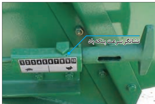
شکل ۴۴- اهرم تنظیم سرعت پنکه
