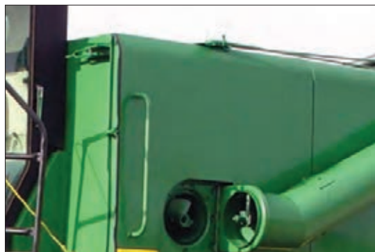
شکل ۲۸- نقاله تخلیه دانه از مخزن
