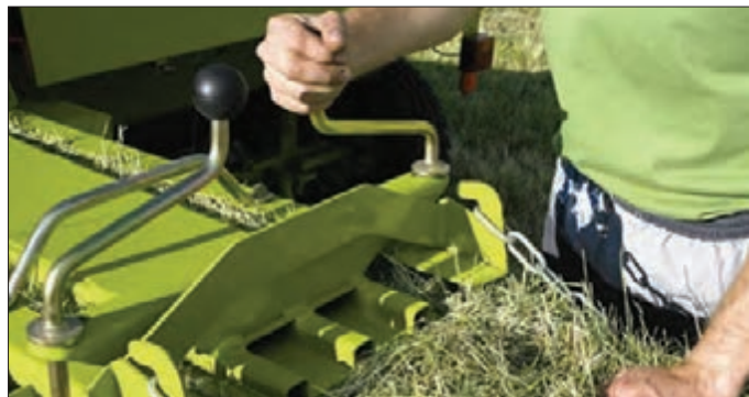
شکل ۱۰۱- تیرک‌های فشاردهنده و تنظیم آن
