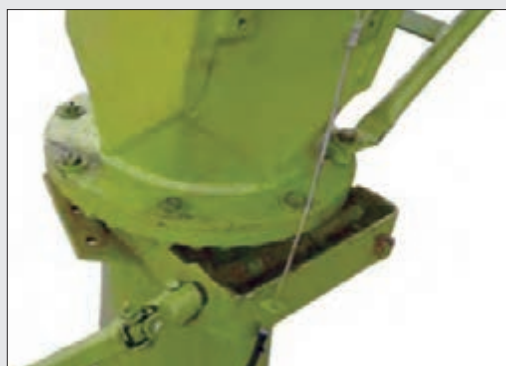
شکل ۴۰- چرخ دنده دوران لوله
