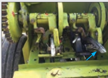
شکل ۹۳- تحویل نخ به نخ گیر
