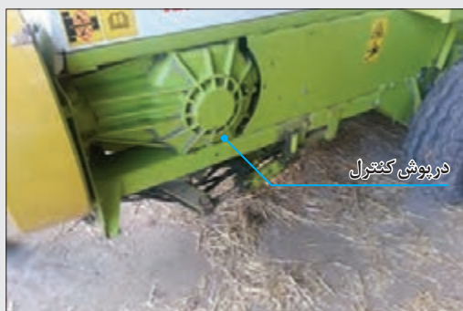
شکل ۸۴- جعبه دنده بسته‌بند
