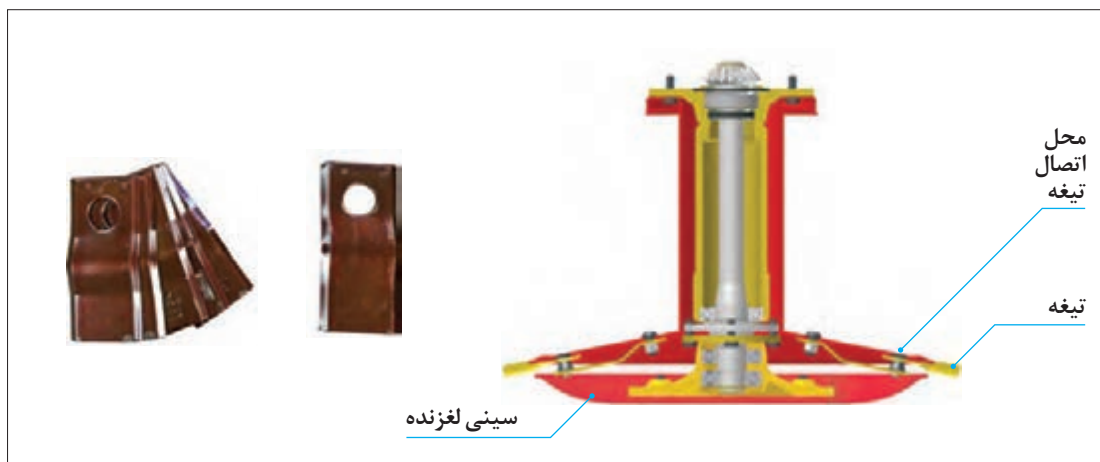
شکل ۴- تیغه و محل قرارگیری آن روی استوانه
