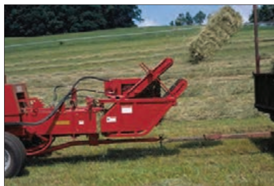
ب) بسته‌بند مجهز به بسته پرتاب کن
