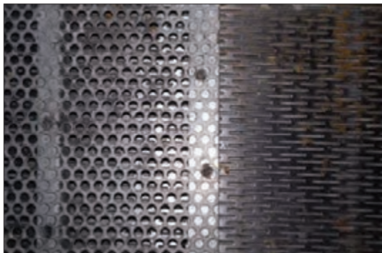
شکل ۳۱- دو نمونه غربال با سوراخ‌های متفاوت
