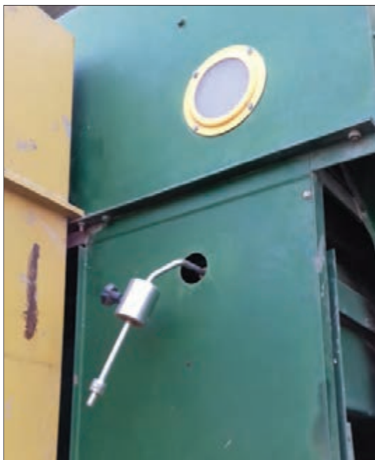
شکل ۳۳- وزنه تنظیم ضربه زن غربال بالایی
