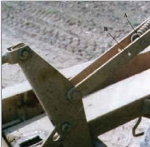
شکل ۳۷- تنظیم فنر شناور
