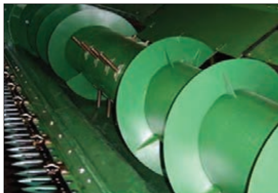
شکل ۸- نقاله پیچی واحد برش
