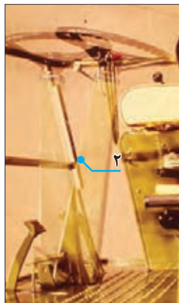
شکل ۳۶- نشانگر تنظیم ارتفاع برش
