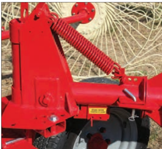
شکل ۶۰- فنرهای شناوری شانه خورشیدی
