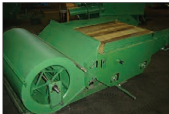
شکل ۲۳- واحد تمیز کننده
