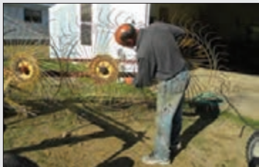
شکل ۵۷- بررسی انگشتی‌ها
