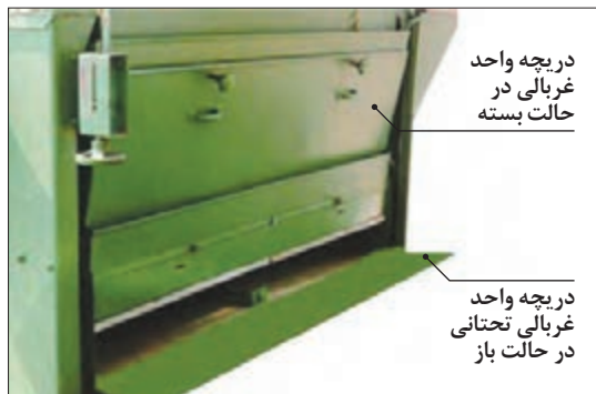
شکل ۳۲- دریچه‌های تعویض غربال‌ها
