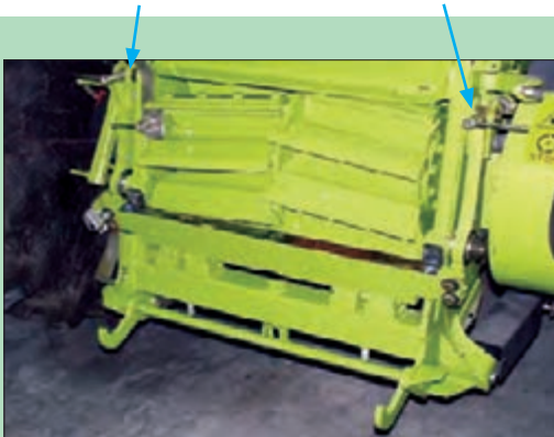
شکل ۲۸- اهرم‌های تنظیم تیغه ثابت در چاپر خودگردان
