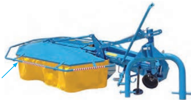
شکل ۶- حفاظایمینی دروگر استوانه‌ای
