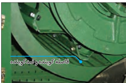
شکل ۴۳- تنظیم فاصله کوبنده
