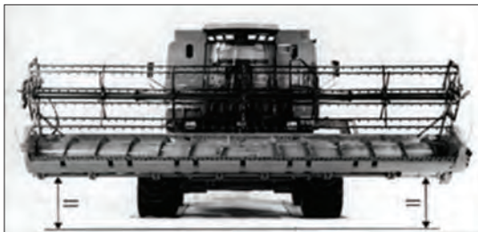
شکل ۳۷- اندازه‌گیری تراز بودن پلاتفرم
