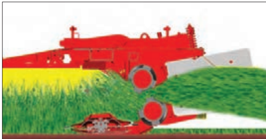
شکل ۵۶- دروساقه کوب و طرز کار آن
