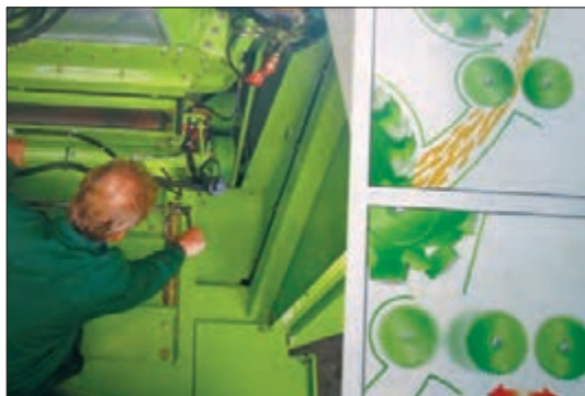
شکل ۲۱- خارج کردن بلال خردکن از مدار
