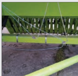
شکل ۹۱- مسیر نخ کردن بسته‌بند و جایگاه سوزن
