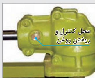
شکل ۴۶- جعبه دنده زانویی تیغه درو
