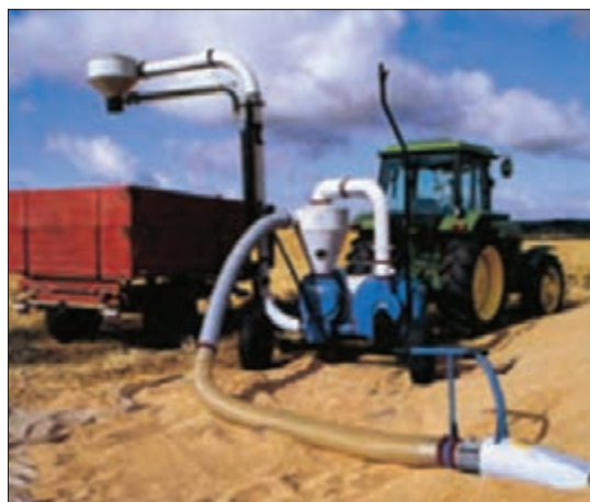
شکل ۲۹- نقاله بادی و طرز کار آن
