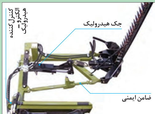
شکل ۱۷- دروگر شانه‌ای با سیستم محرک ارتعاشی
