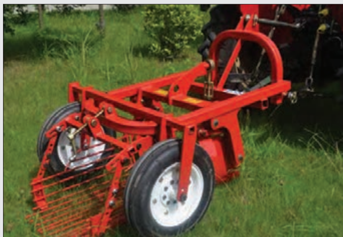
شکل ۱۳- اتصال سیب زمینی کن لرزان به تراکتور
