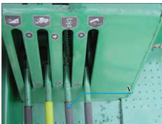
شکل ۳۹- اهرم تنظیم سرعت پروانه چرخ و فلک
