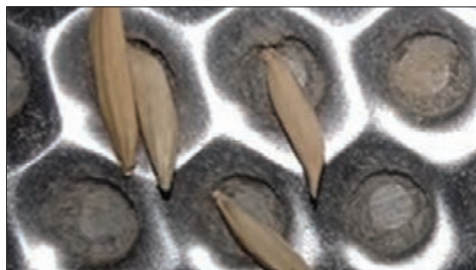
شکل ۱۶- قرار گرفتن دانه‌ها در سوراخ‌های استوانه حفره‌دار
