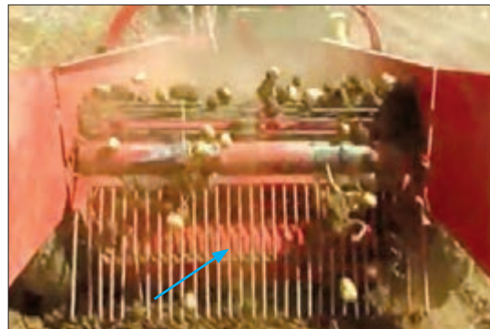
شکل ۵- غلتک تسطیح‌کن
