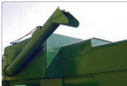
شکل ۲۷- لوله تخلیه
