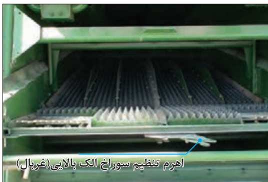
شکل ۲۴- الک بالایی تمیز کننده
