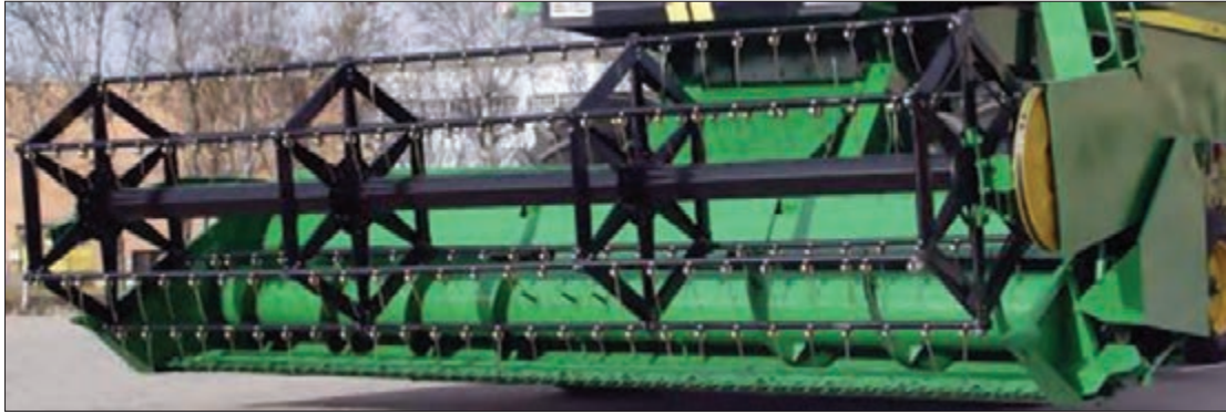
شکل ۱۰- پلاتفرم مجهز به چرخ و فلک انگشتی‌دار
