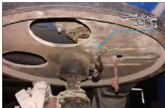
شکل ۳۴- پیچ تنظیم کورس غربال کابلی
