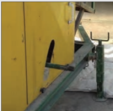
شکل ۳۸- پایه نگهدارنده ماشین بوجاری تراکتوری
