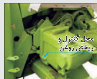
شکل ۴۵- جعبه دنده باردهی غلتک‌های تغذیه
