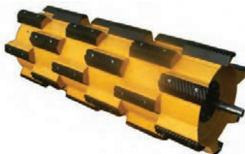
شکل ۱۷- کوبنده سایشی
