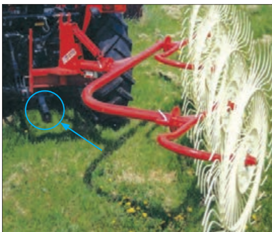
شکل ۵۹- اتصال شانه خورشیدی به تراکتور
