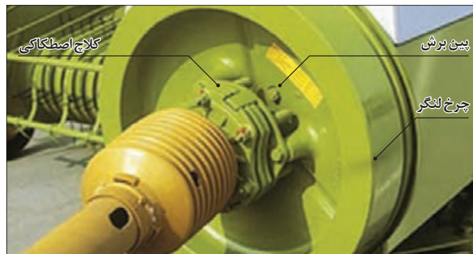
شکل ۸۰- چرخ لنگر و کلاچ ایمنی
