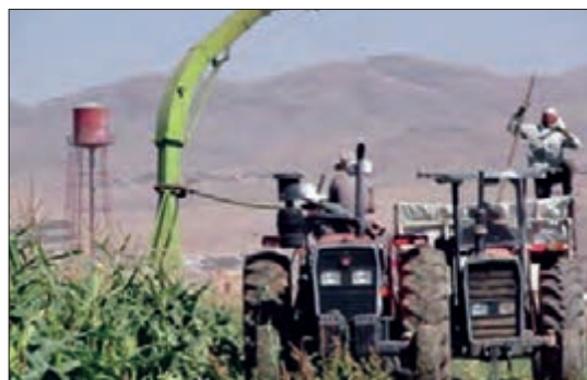
شکل ۳۲- تناسب لوله تخلیه با ماشین حمل
