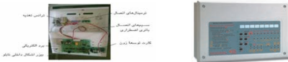
شکل ۱۷- اجزای داخلی تابلوی اصلی
