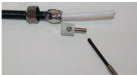
۱- سوزنی اتصال را برداشته و پیچ آن را چند دور باز کنید.
