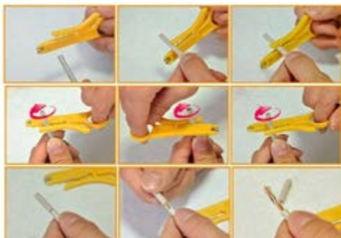
شکل ۷ - روکش برداری کابل
