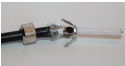
۵- سوزنی را در محل خود قرار داده تا انتها فشار دهید و پیچ آن را محکم ببندید.
