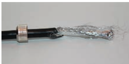
۳- سیم های پوسته خارجی را به سمت عقب جمع کنید و گیره را به طرز صحیح داخل کابل قرار دهید.
