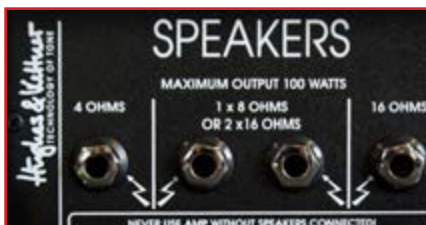
شکل ۲۰- امپدانس خروجی بلندگو
