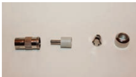
۱- اجزای یک اتصال آنتن TV پیچی الف) بدنه خارجی (ب) سوزنی (ج) گیره د) پیچ بدنه خارجی
