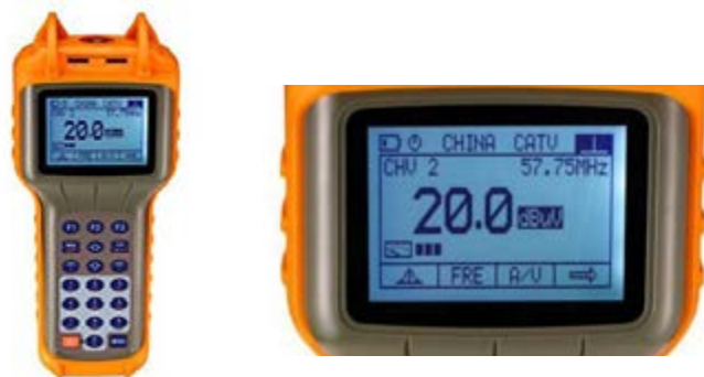
شکل ۲۴- اندازه‌گیری سیگنال خروجی آنتن توسط سیگنال سنج
