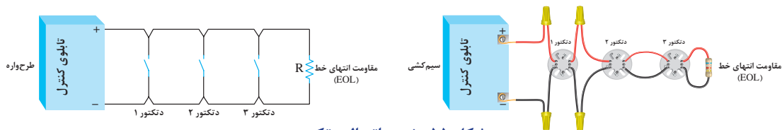
شکل ۵۵- نحوه اتصال دکتور
