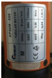
شکل ۱۳- قطر موتور درون نصب برابر ۹۲ میلیمتر است
