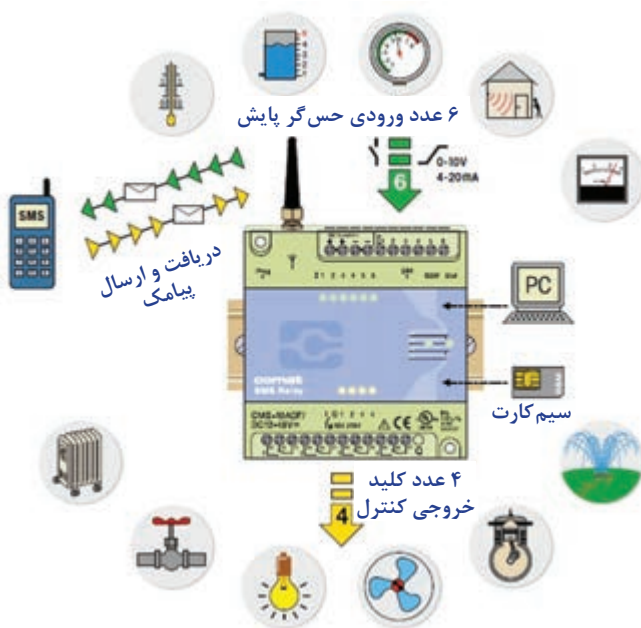
شکل ۱۷- کاربردهای متنوع سامانه کنترل پیامکی
