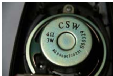
شکل ۹- توان بلندگو و امپدانس
