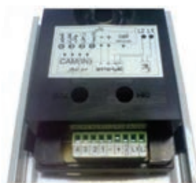
شکل ۲۵- محل تنظیم صدای بلندگو و میکروفون
