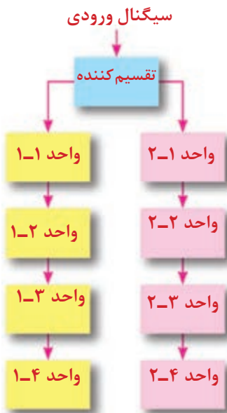
شکل ۳۰- مدار آنتن مرکزی در یک ساختمان ۴ طبقه
