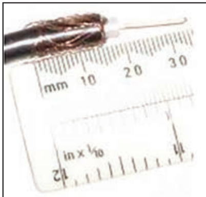
۴- عایق زیر را نیز روکش برداری کنید.
