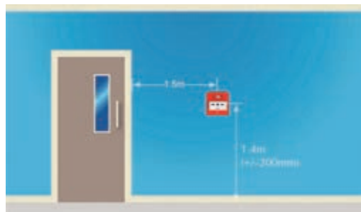
شکل ۲۱- محل و ارتفاع نصب شستی
