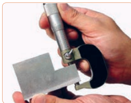
شکل ۱۶-۲ چگونگی در دست گرفتن میکرومتر
