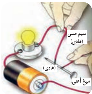
شکل ۱۹-۱- برقراری جریان الکتریکی در هادی
