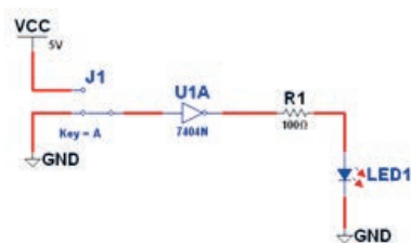
شکل ۵۹-۶- مدار گیت منطقی NOT
