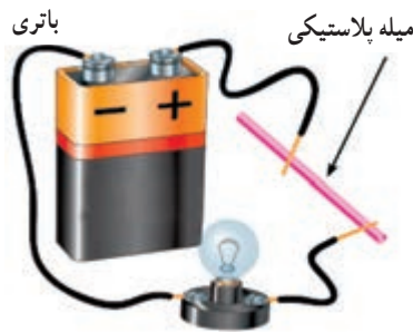
شکل ۲۰-۱- برقرار نشدن جریان الکتریکی در عایق
