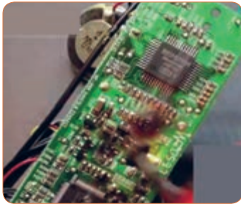
شکل ۵-۵ - قطعاتی از برد سوخته است.
