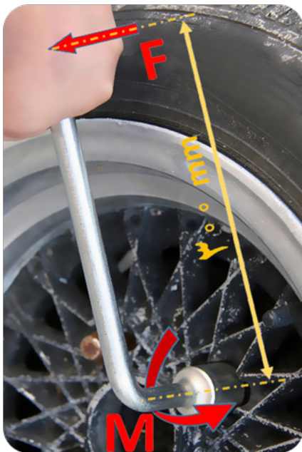
باز کردن پیچ چرخ خودرو توسط آچار چرخ
