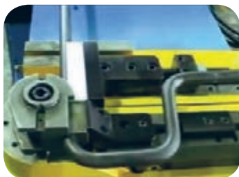
خم کاری لوله
