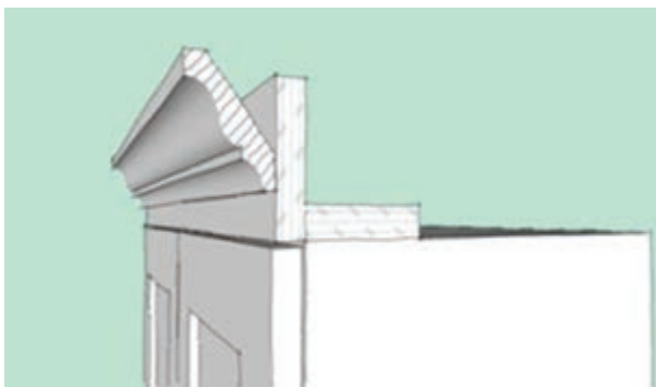
شکل ۳۵- روش نصب تاج در کابینت‌های چوبی
