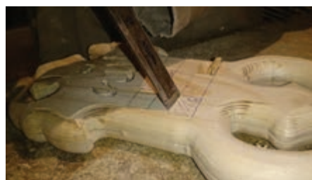
شکل ۲۳- مغارکاری مفصل‌ها به صورت غلط
