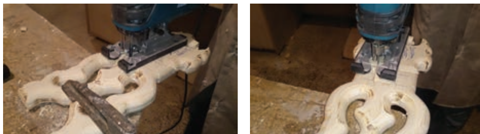
شکل ۲۶- برش طولی مفصل با اره عمودبر
