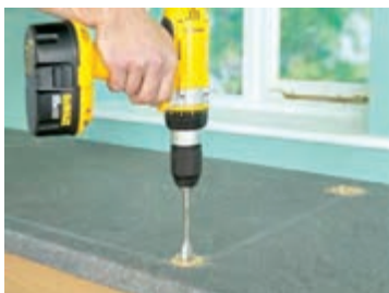
شکل ۱۰۰ - سوراخ کاری صفحه جهت عبور تیغه اره عمودبر
