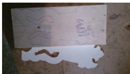
شکل ۱۶- انتقال طرح شابلون روی چوب
