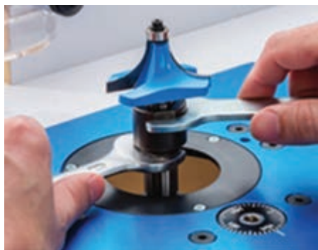
شکل ۹۲ - قرار دادن تیغه در کولت و محکم کردن آن با آچار
