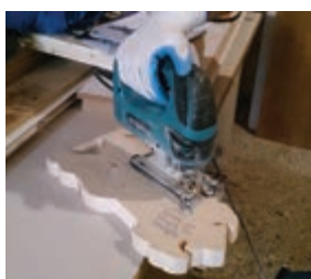
شکل ۱۷- عملیات برش کاری با اره عمودبر
