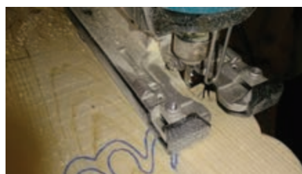
شکل ۱۶- انتقال طرح شابلون روی چوب
