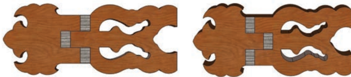
شکل ۲۰- تقسیم‌بندی خطوط عرضی رحل: پشت قطعه کار (سمت چپ) و جلو قطعه کار (سمت راست)
