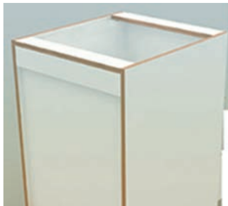
شکل ۲۸ - نصب یکی از قیدهای فیتینگ پشت کابینت دیواری
