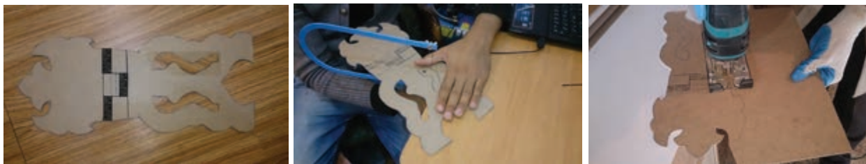
شکل ۱۵- تهیه شابلون رحل چوبی به وسیله اره عمودبر و اره کمائی (مویی)
