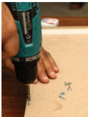
شکل ۵۶ - بستن کف جعبه با پیچ
