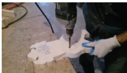
شکل ۱۸- عمل سوراخ کاری وسط رحل با دریل دستی
