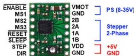
تصویر ۳۱- درایور استپ موتور A4988
