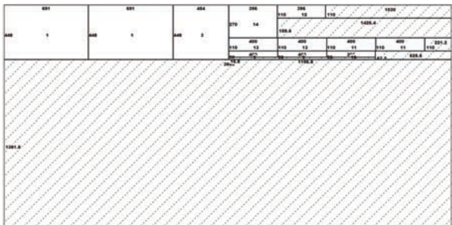
شکل ۲۸- نقشه چیدمان ورق رنگ طوسی ۱۶ میلی متر با ابعاد ۳۶۶×۱۸۳ سانتی متر
