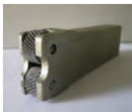
شکل ۲-۴۳: انواع نگه‌دارنده قرقه آج‌زنی
