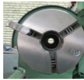
الف: استقرار فک روی پیچ ارشمیدس
