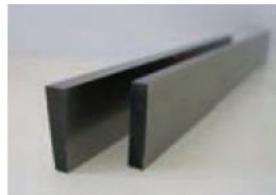
شکل ۲-۳۵: رنده شیار تراشی
