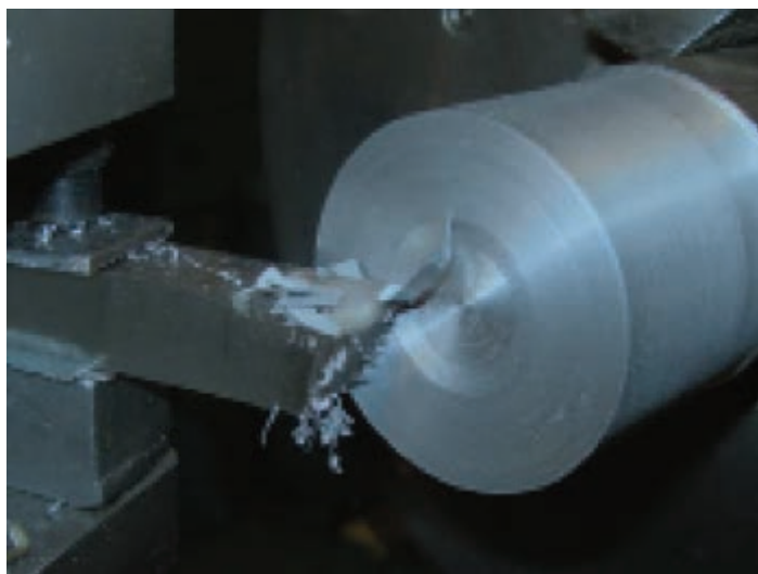
شکل ۲-۲۹: تراشکاری قطعات کوتاه
