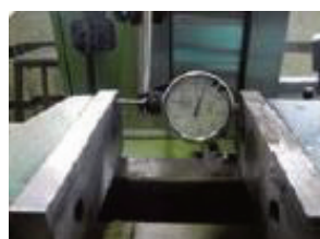
تنظیم گیره به کمک ساعت اندازه گیری
