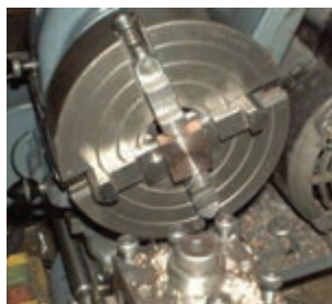
ج: بستن قطعه با مقطع مستطیل در صفحه نظام با فک های تکرر
