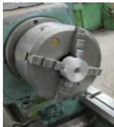
ب: بستن قطعه گرد در چهار نظام
