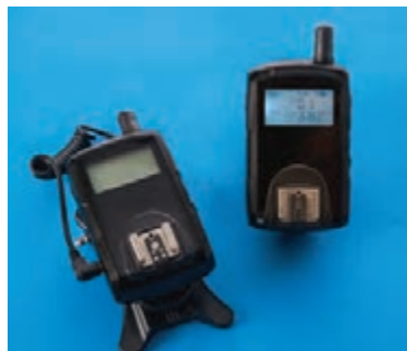
▲ رادیو تریگر TTL، مدل با باتری | تصویر ۱۳۰
