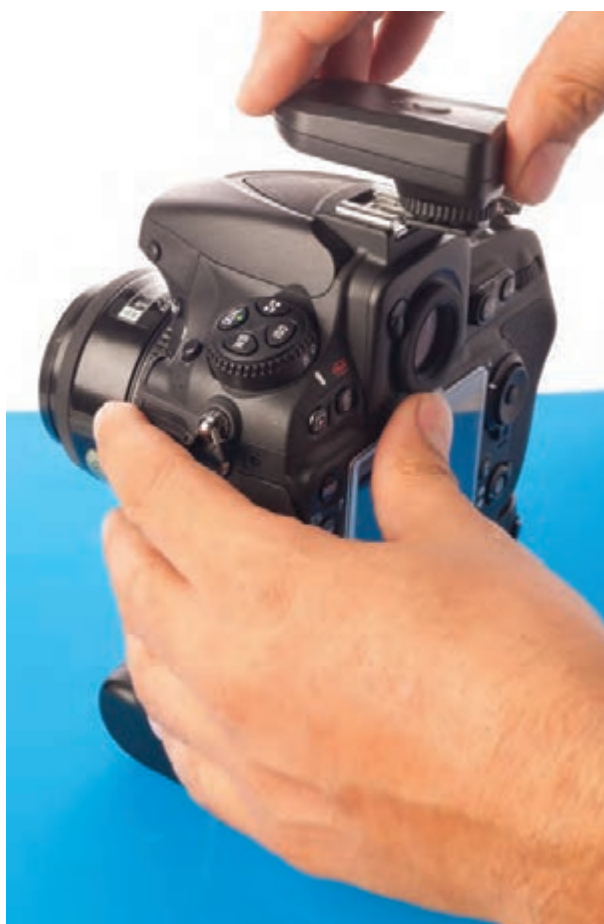
▲ اتصال ریموت فرستنده به دوربین | تصویر ۱۳۵
