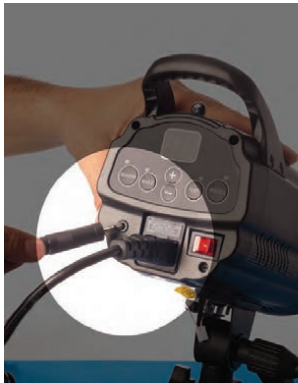
▲ اتصال سیم سینکرون رادیوتریگر به فلاش | تصویر ۱۳۶
