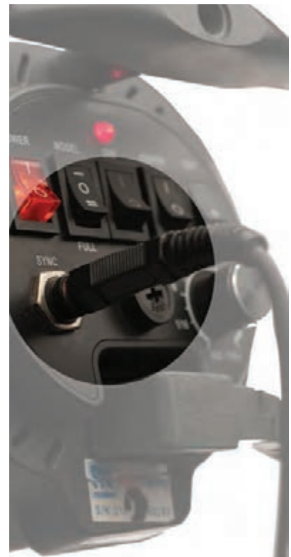
تصویر ۱۹۶ | اتصال سیم سینکرون به فلاش
