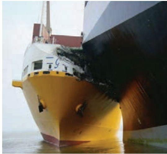
شکل ۴- بیشترین تصادم کشتی‌ها از طریق سینه کشتی به وقوع می‌پیوندد.
