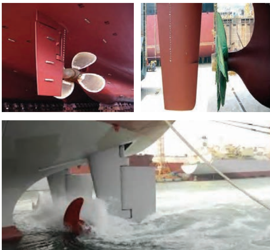
شکل ۱۲- تیغه سکان و چگونگی قرار گرفتن آن در قسمت انتهایی پاشنه کشتی
