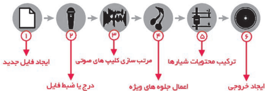
شکل ۱۱-۲- جریان کاری در نمای Multitrack View
