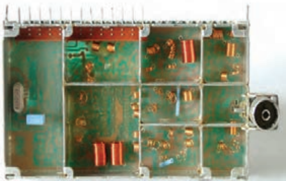
شکل ۲-۴۳- سیم‌پیچ‌های داخل تیونر
