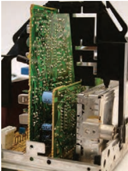
شکل ۴-۱۲۵- مدول RGB روی برد
