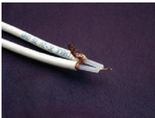
شکل ۱-۶۳- سیم کابل نباید دو تکه باشد.
