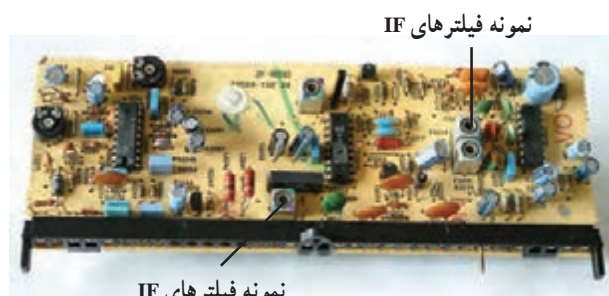
شکل ۲-۱۶۵- نمونه فیلترهای IF که نباید هسته‌ی آن‌ها تغییر داده شود.
