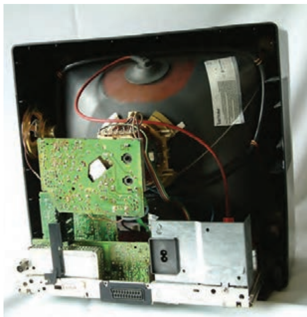
شکل ۴-۳۵- تلویزیون بدون قاب پشت
