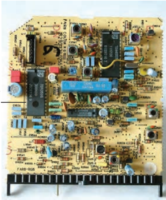
شکل ۴-۱۳۰- محل نصب آی‌سی ۹۵۳۱
