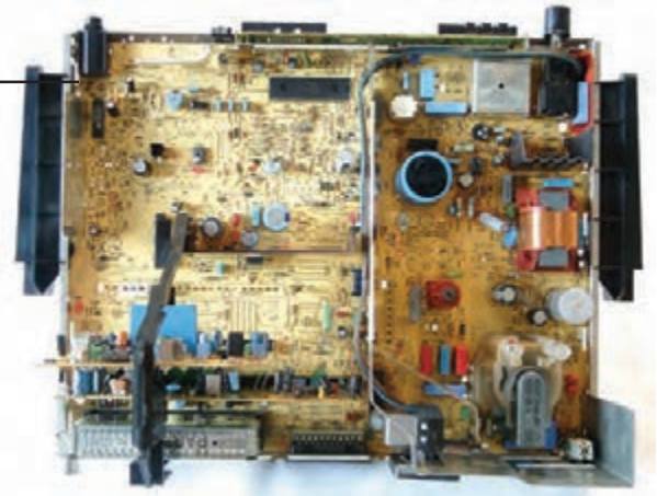
شکل ۳-۲۶- محل نصب آی سی ۳۶۵ در برد اصلی
