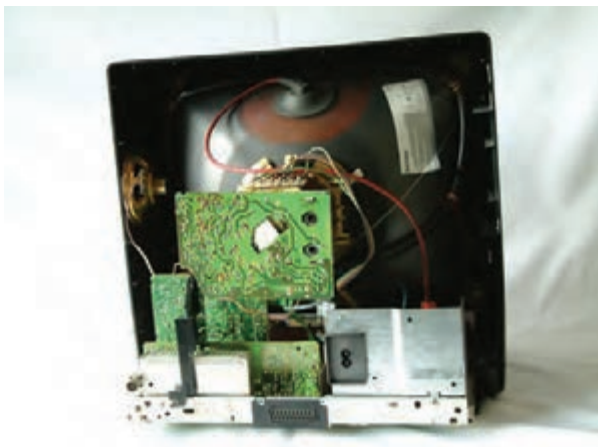
شکل ۲-۴۴- تلویزیون بدون قاب پشت
