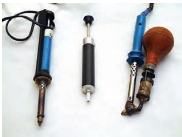
شکل ۴-۷۹- قلع کش حرارتی و پیستونی
