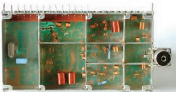
شکل ۳۷-۲- قطعات تیونر
