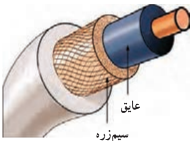
شکل ۴۲-۱ دی الکتریک و زره
