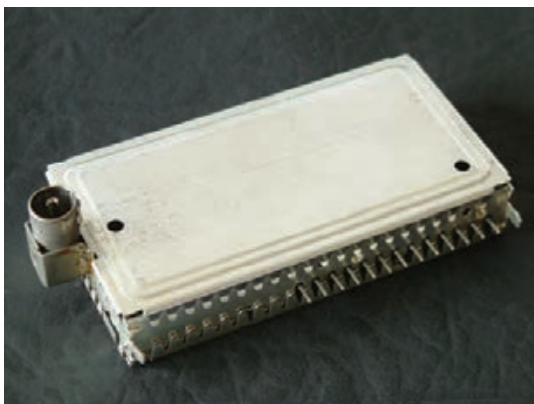
شکل ۲-۲۶: تیونر و پایه‌های آن
