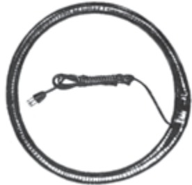
شکل ۱-۱۹۸ سیم پیچ مغناطیس زدای دستی
