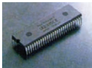
شکل ۱۰۹-۲ یک آی‌سی PROM
