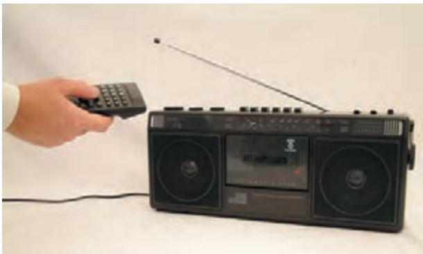
شکل ۳-۴۸- تست کنترل از راه دور توسط رادیو
