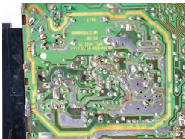
شکل ۱۳۷-۱- بخشی از مدار که برق ۲۲۰ ولت وجود دارد.
