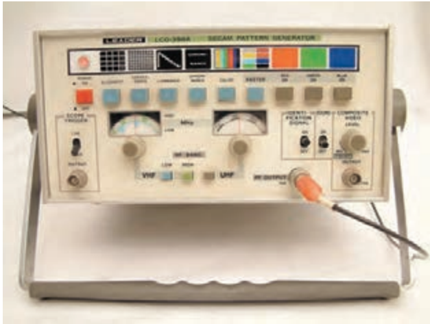
شکل ۳-۱۸- نمونه‌ای از پترن ژنراتور
