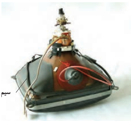
شکل ۱-۲۰۰ محل قرار گرفتن سیم پیچ مغناطیس زدا
