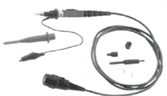
شکل ۱۳۸-۱- پراب با ضریب \times 10 برای اندازه گیری ولتاژ بالا
