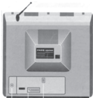
شکل ۲-۲۱۹- محل قرار گرفتن سوکت اسکارت
