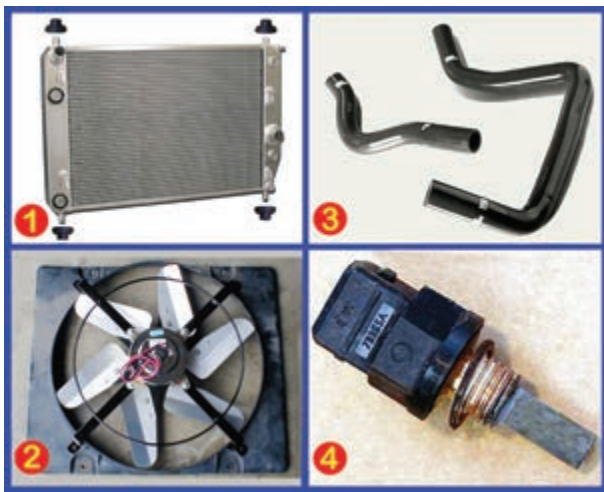
شکل ۲-۶- اجزای مدار خنک کاری
