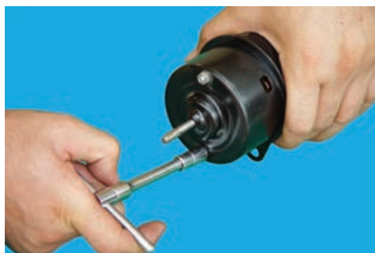
شکل ۴-۴۴- باز کردن پیچ‌های پوسته‌ی موتور
