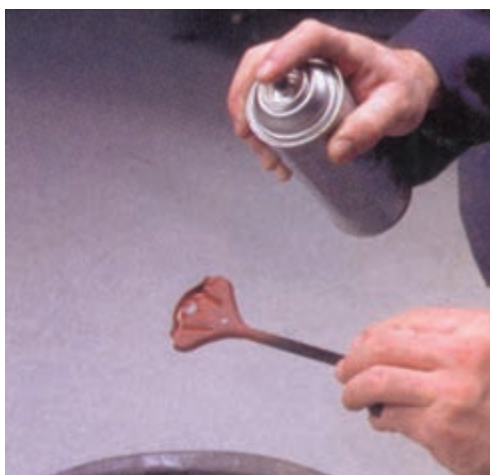
شکل ۹۳-۱- اسپری ضدخوردگی روی بست نگه‌دارنده‌ی باتری
