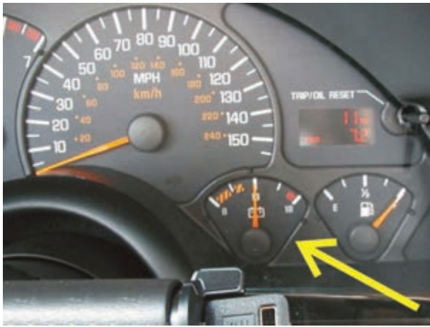
شکل ۳-۷ نشان‌دهنده‌ی وضعیت باتری
