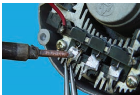
شکل ۵۶-۷- جدا کردن سیم‌های استاتور از یک‌سوکننده
