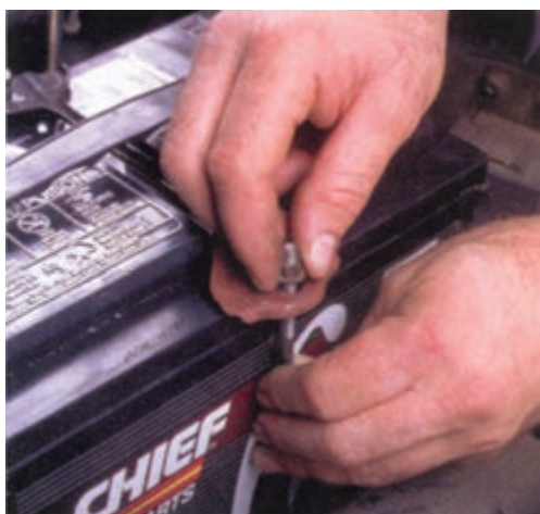
شکل ۹۴-۱- بستن باتری روی خودرو
