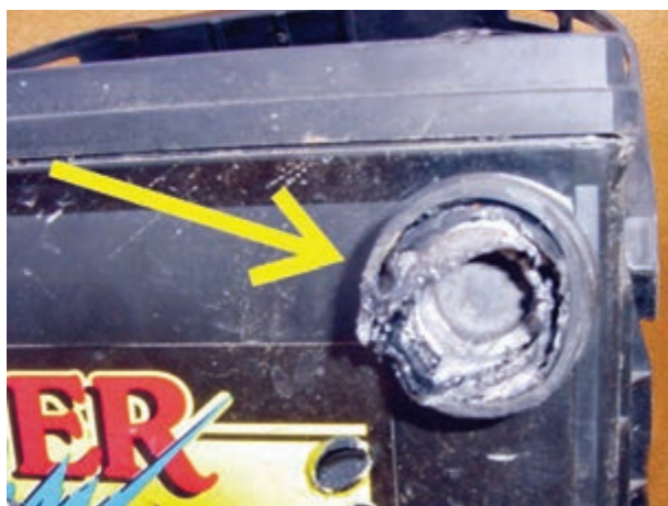
شکل ۳۶-۲- معیوب بودن ترمینال باتری
