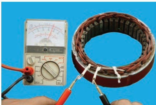
شکل ۷۹-۷- آزمایش سالم بودن سیم پیچ استاتور
