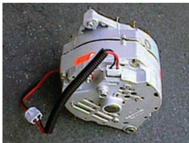
شکل ۳-۱۶- آلترناتور مجهز به آفتامات الکترونیکی
