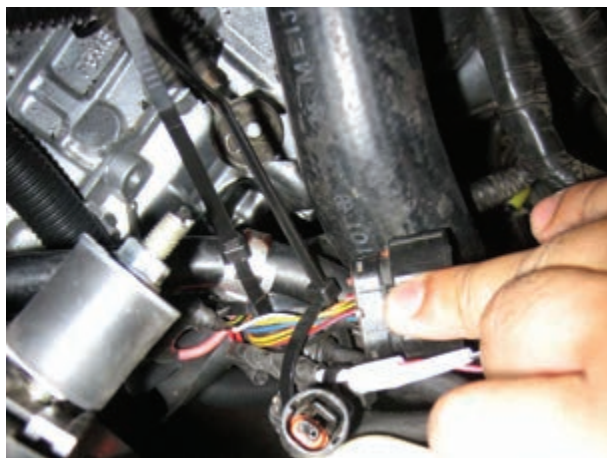
شکل ۴۵-۵- بررسی اتصالات الکتریکی سیم‌کشی
