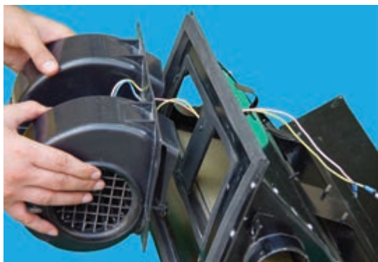
شکل ۴-۳۷- جدا کردن محفظه‌ی موتور از بخاری
