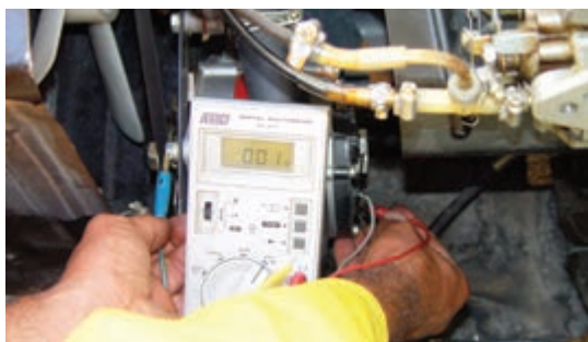
شکل ۷-۷۲ - اتصال ولت‌متر بین ترمینال B و بدنه
