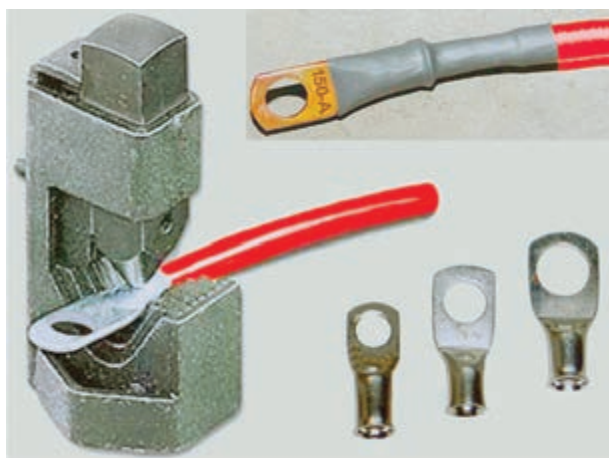
شکل ۸۰-۸- اتصال بست به کابل باتری
