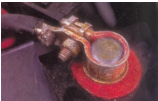
شکل ۱-۹۷- گریس زدن بست قطب‌ها
