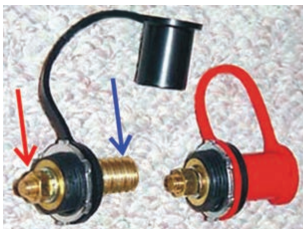
شکل ۱۴-۲- واسطه‌ی اتصال ترمینال باتری
