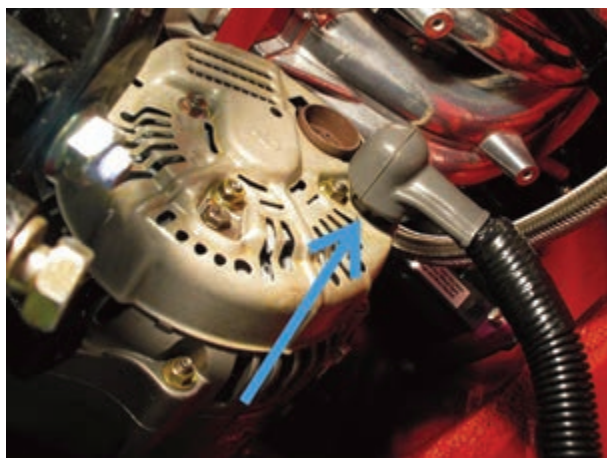
شکل ۳-۲۴- عایق اتصال الکتریکی ترمینال آلترناتور
