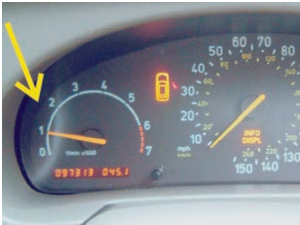
شکل ۷-۱۰۰- حالت دور آرام موتور
