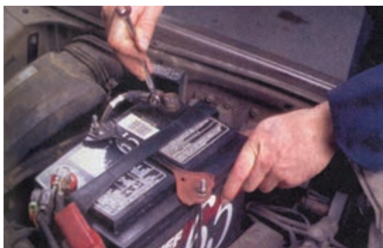
شکل ۱-۹۵- اتصال کابل‌های مثبت و منفی باتری
