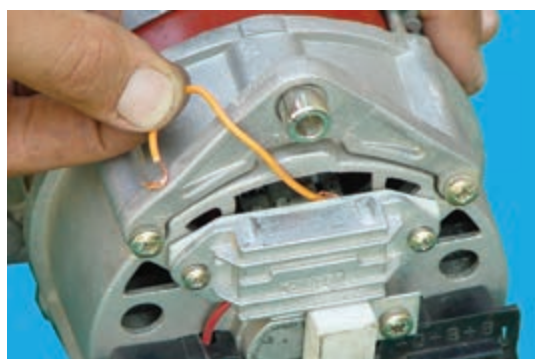
ب - اتصال بدنه کردن سیم متصل به زغال منفی
