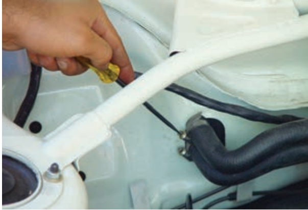
شکل ۴-۳۱- باز کردن لوله‌های آب رادیاتور بخاری
