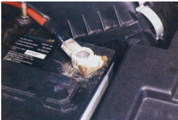
شکل ۳۱-۸ سولفات‌شدن اتصال قطب باتری
