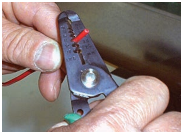
شکل ۴-۶۴- جدا کردن عایق سیم‌ها
