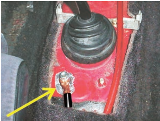
شکل ۲-۲۵- اتصال بدنه‌ی باتری در داخل اتاق خودرو
