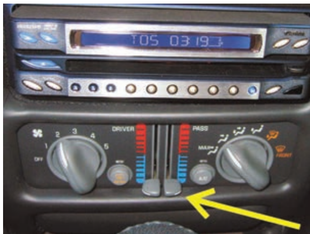
شکل ۴-۵۴- اهرم‌های تنظیم هوای ورودی
