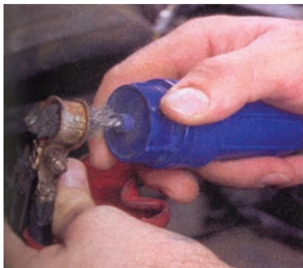
شکل ۹۱-۱ - پاک کردن بست‌های باتری با برس سیمی
