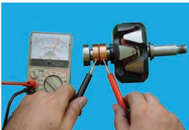
شکل ۷۵-۷- آزمایش سالم بودن سیم پیچ روتور
