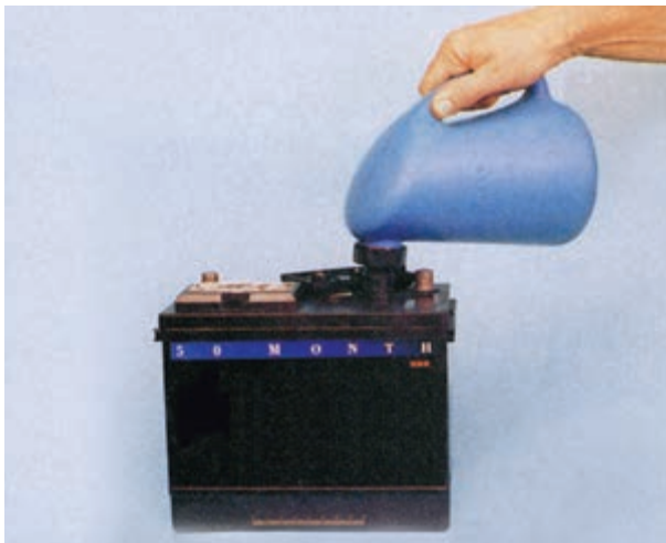
شکل ۱-۲۷ - پر کردن خانه‌های باتری نو با الکترولیت
