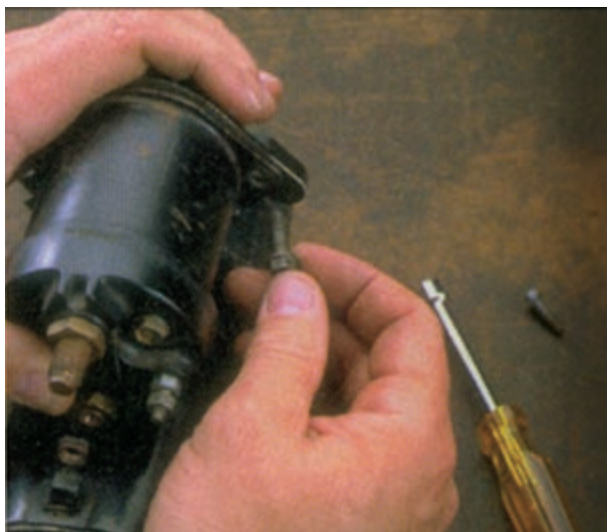
شکل ۸-۵۳ - بیرون آوردن پیچ‌های اتومات
