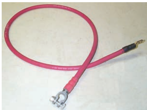
شکل ۳۲-۲- کابل اتصال مثبت باتری
