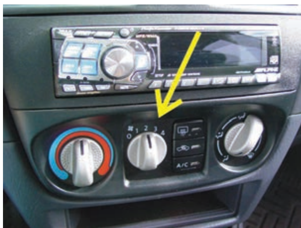
شکل ۴-۵۲- سوئیچ فن چهار وضعیت
