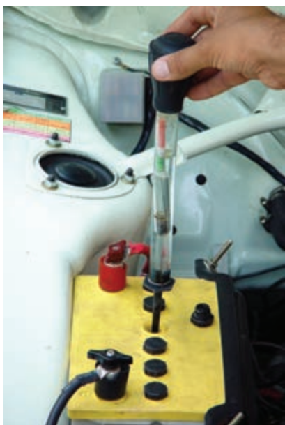
شکل ۸-۲۸- بررسی دشارژ باتری
