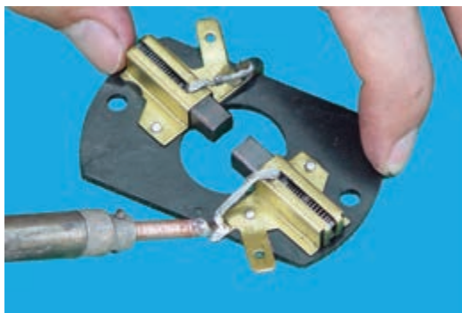
شکل ۴۸-۴ لحیم کردن زغال نو به جای زغال کهنه
