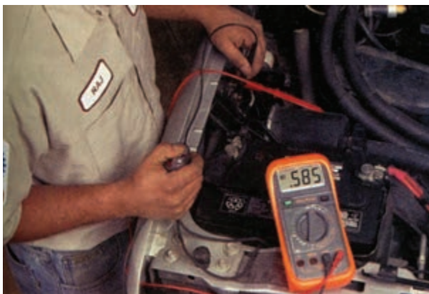
شکل ۸-۴۴- اندازه‌گیری افت ولتاژ پلاتین‌های سولونویید استارتر
