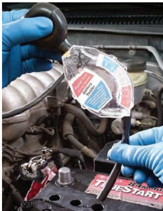
شکل ۱-۶۴- آزمایش چگالی الکترولیت داخل خانه‌های باتری
