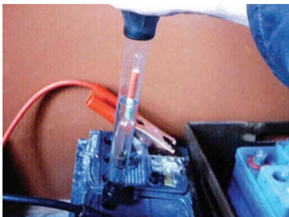
شکل ۱-۶۲- کنترل غلظت الکترولیت
