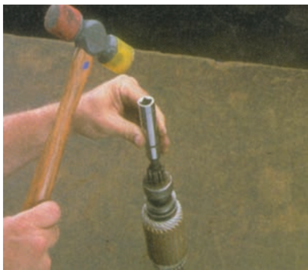
شکل ۸-۵۹ – ضربه زدن با چکش روی خار
