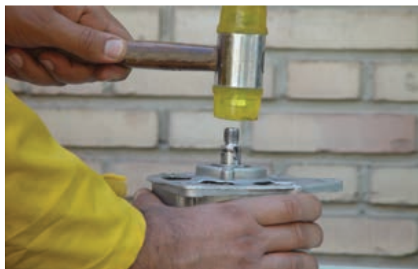
شکل ۶۳-۷ - بیرون آوردن روتور از درپوش
