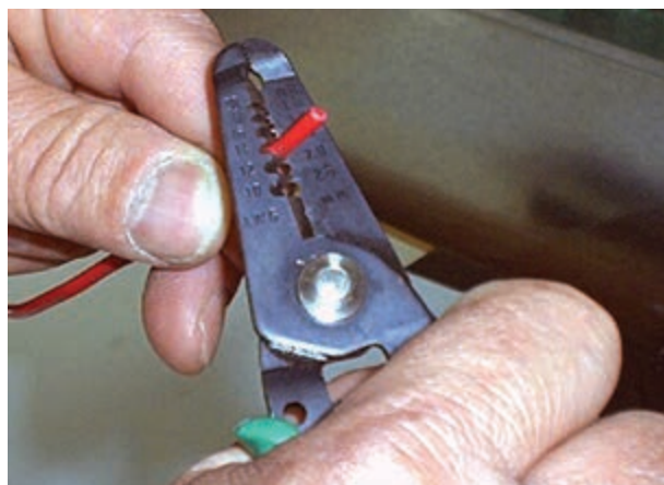
شکل ۶-۳۰- جدا کردن عایق سیم
