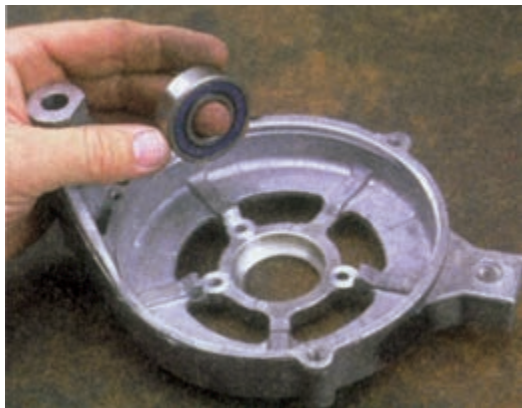
شکل ۷۰-۷ - خارج کردن بلبرینگ و آزمایش آن
