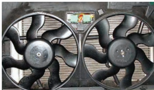
شکل ۵-۱۴- فن‌های نصب شده در روی رادیاتور یک نوع خودرو
