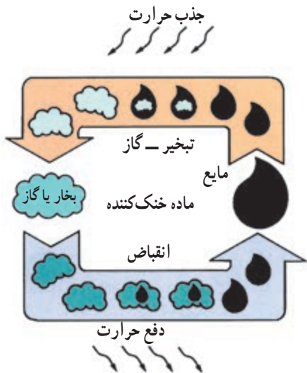
شکل ۵-۳- مراحل تغییر ماده خنک کننده
