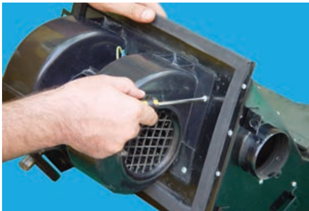
شکل ۳۶-۴- باز کردن پیچ‌های محافظه‌ی موتور
