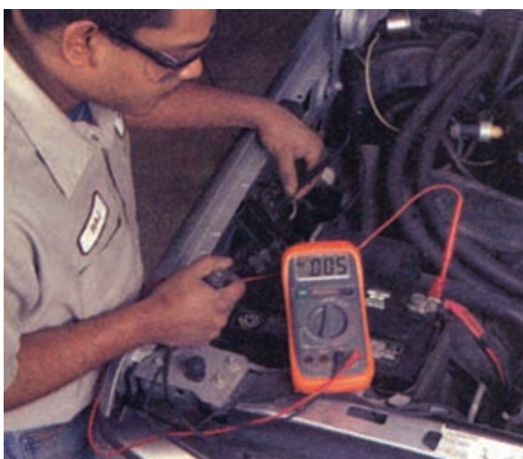
شکل ۸-۴۱- اندازه‌گیری افت ولتاژ کابل متصل به رله
