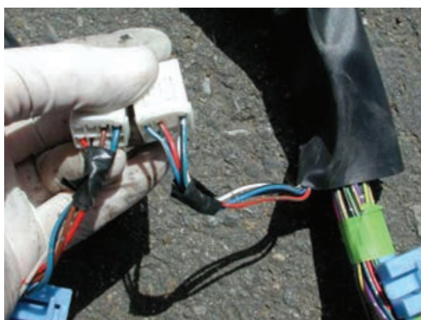
شکل ۳-۲۳- مقایسه و تطبیق سوکت‌های کلاف سیم‌کشی
