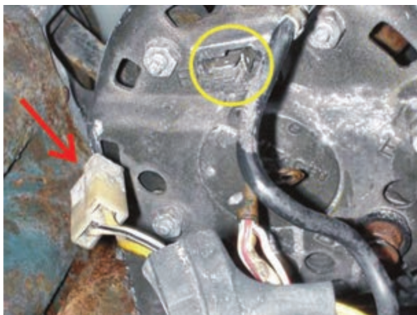
شکل ۳-۳۵- جدا کردن کاتوجویی سیم کنشی لامپ شارژ
