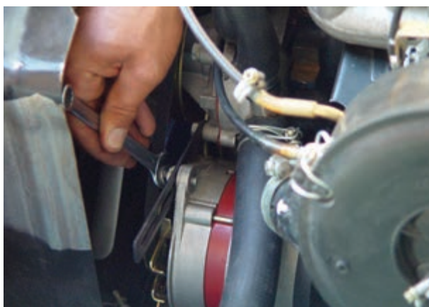
شکل ۴۹-۷ باز کردن پیچ کشش تسمه پروانه
