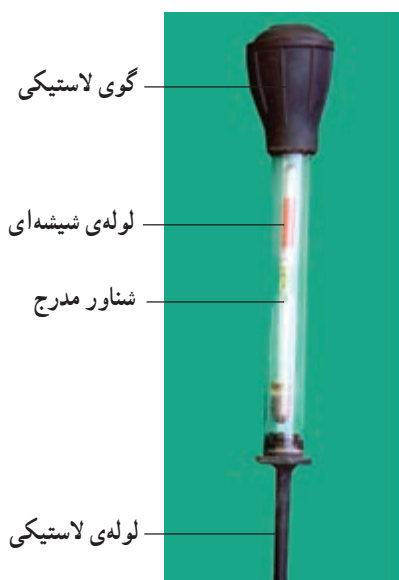
شکل ۱-۱۴- دو نوع هیدرومتر یا چگالی سنج
