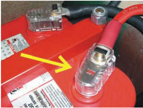
شکل ۱۹-۲- مورد استفاده تلق محافظ قطب‌های باتری
