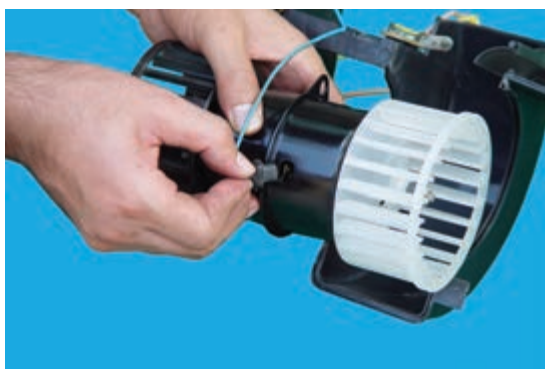
شکل ۴-۴۱- جدا کردن سیم از زغال‌ها
