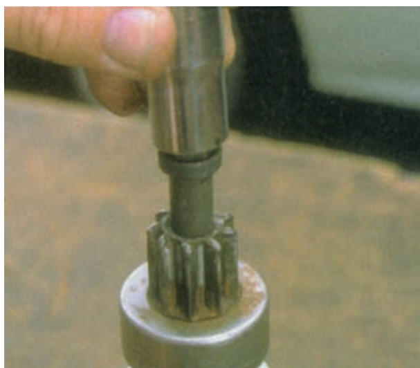
شکل ۸-۶۰ – خارج کردن حلقه رینگی از شیار شافت
