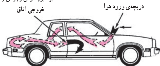
شکل ۱۱-۴- مسیر عبور جریان هوای گرم در خودرو
