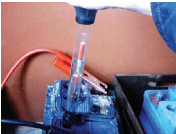
شکل ۱-۵۳- کنترل غلظت الکترولیت
