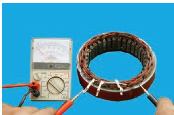
شکل ۷-۷۸ - آزمایش اتصال بدنه نبودن سیم پیچ استاتور
