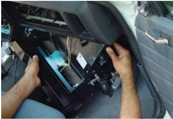
شکل ۳۴-۴- خارج کردن بخاری از محل نصب آب
