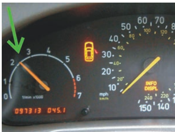
شکل ۲۹-۳ دور موتور در وضعیت آزمایش
