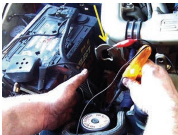
شکل ۴۳-۵- نحوه ی آزمایش سالم بودن سیم کشی
