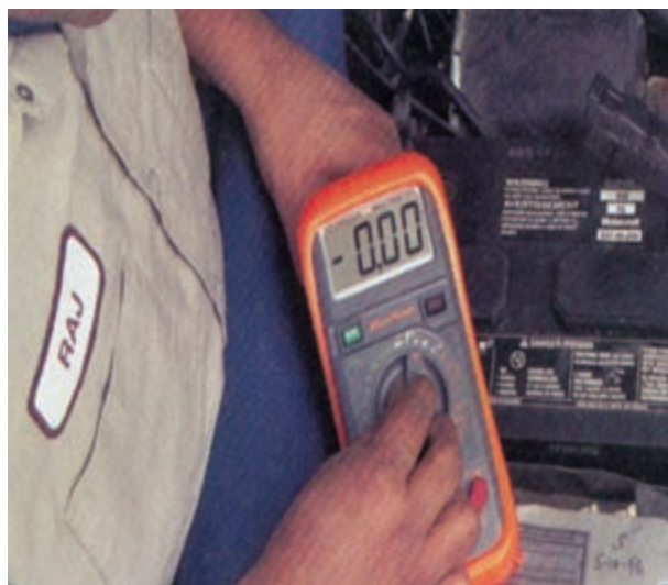
شکل ۸-۳۵- تنظیم مولتی متر روی شاخص ولتاژ
