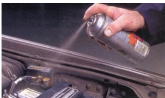
شکل ۱-۹۶- پاشیدن محلول ضد خوردگی روی بست
