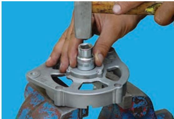
شکل ۶۹-۷ - بیرون آوردن بلبرینگ
