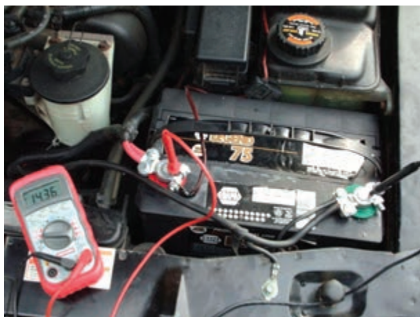
شکل ۱-۶۶ – اندازه گیری ولتاژ باتری
