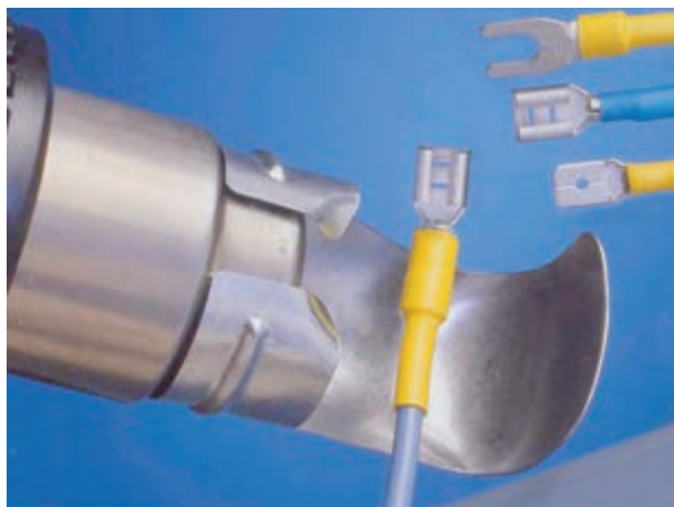
شکل ۷۹-۸- عایق‌کاری اتصال سرسیم به سیم
