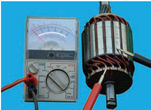
شکل ۸-۶۷- آزمایش اتصال کوتاه شدن آرمیچر
