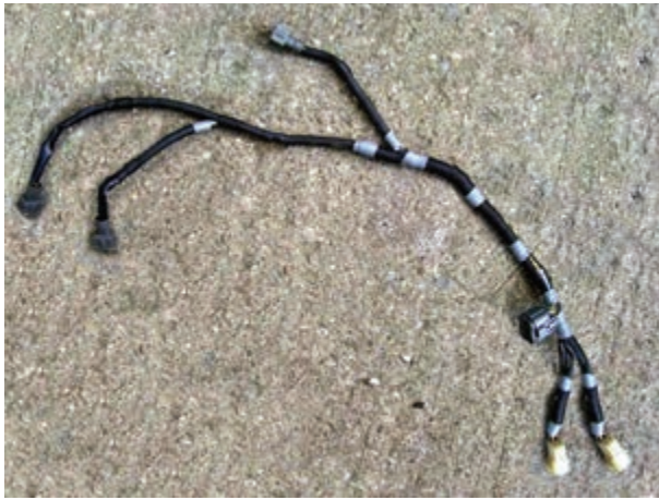
شکل ۱۲-۳- دسته سیم مدار شارژ
