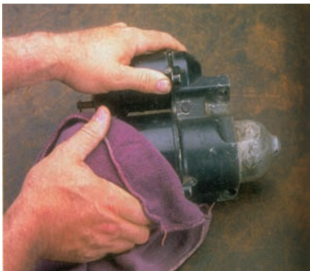
شکل ۸-۵۰ - تمیز کردن استارت
