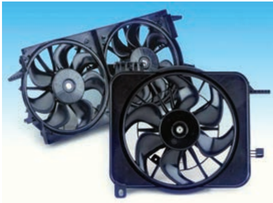
شکل ۶-۶ فن‌های الکتریکی مورد استفاده در خودروها
