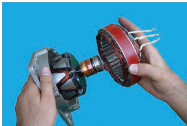
شکل ۶۲-۷ - جدا کردن استاتور
