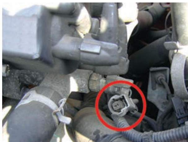
شکل ۱۶-۶ جدا کردن سوکت اتصال
