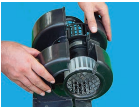
شکل ۴-۴۰- جدا کردن محفظه‌ی نگهدارنده‌ی موتور
