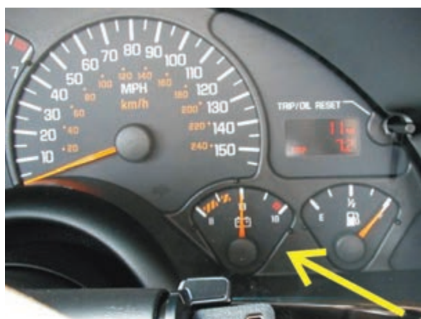
شکل ۱-۷۸ – نشان‌دهنده‌ی وضعیت شارژ باتری
