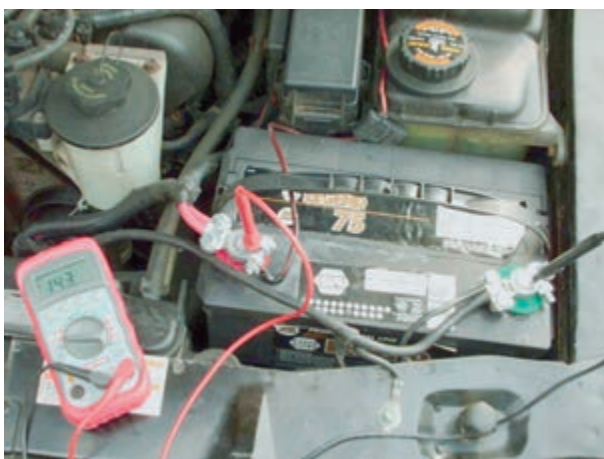
شکل ۷-۱۰۲- اندازه‌گیری ولتاژ شارژ
