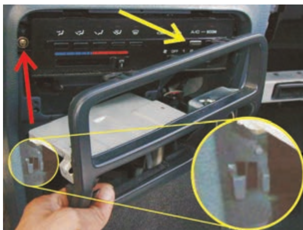
شکل ۳۸-۵- باز کردن قاب سوئیچ‌ها
