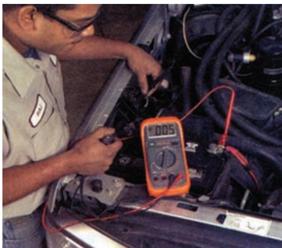
شکل ۸-۴۰- اتصال سیم منفی ولت‌متر به ورودی رله
