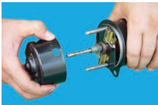
شکل ۴۵-۴ جدا کردن پوسته‌ی موتور
