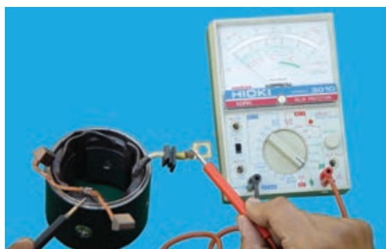
شکل ۸-۷۵- آزمایش اتصال بدنه‌ی بالشتک
