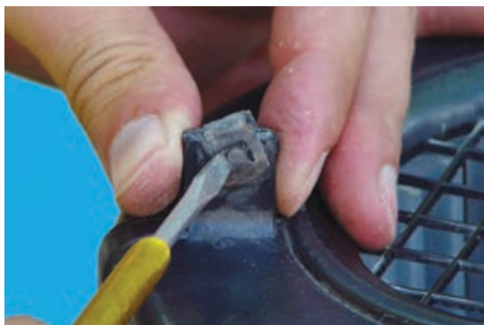
شکل ۴-۳۸- باز کردن ضامن خار
