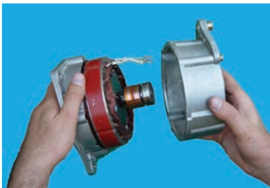
شکل ۶۱-۷ - جدا کردن درپوش‌های آلترناتور
