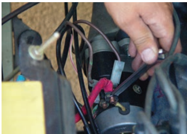
شکل ۸-۴۸- جدا کردن اتصالات الکتریکی استارت
