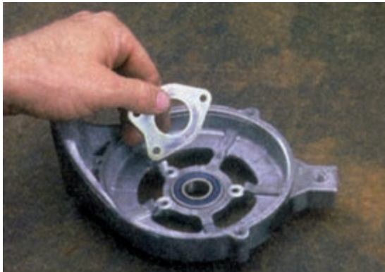
شکل ۶۸-۷ - در آوردن نگه‌دارنده‌ی بلبرینگ
