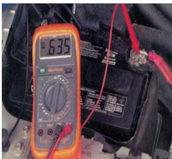
شکل ۸-۳۷ – اندازه‌گیری افت ولتاژ جریان ورودی کابل استارتر
