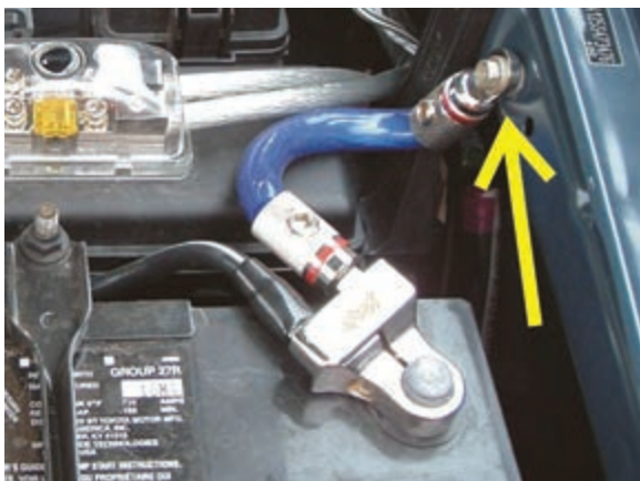
شکل ۲-۲۴ اتصال کابل منفی باتری به بدنه
