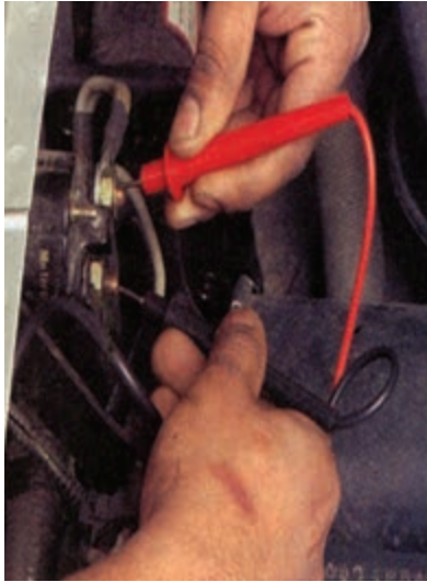
شکل ۸-۴۲- اتصال فیض‌های ولت‌متر به اتومات استارتر
