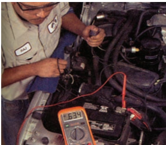
شکل ۸-۳۹- آزمایش افت ولتاژ باتری به خروجی رله
