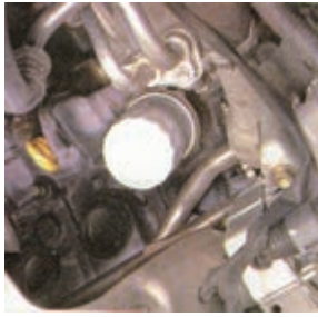
شکل (۲-۶۰) کنترل فیلتر از نظر نشتی
