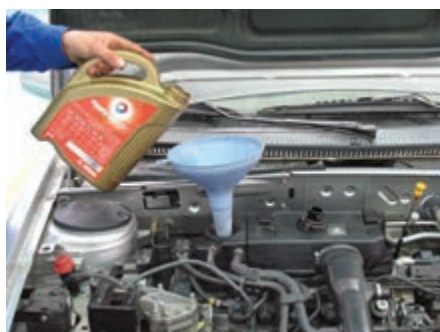
شکل (۲-۵۸) شارژ با روغن توصیه شده
