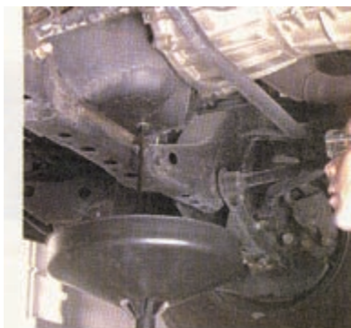
شکل (۲-۵۲) تخلیه روغن در ظرف مناسب
