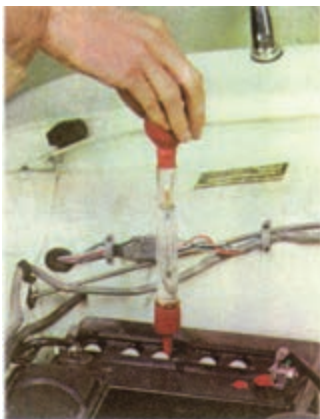
شکل (۲-۸۸) اندازه گیری غلظت مایع باتری
