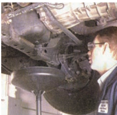
شکل (۲-۵۵) کنترل تخلیه شدن کامل روغن
