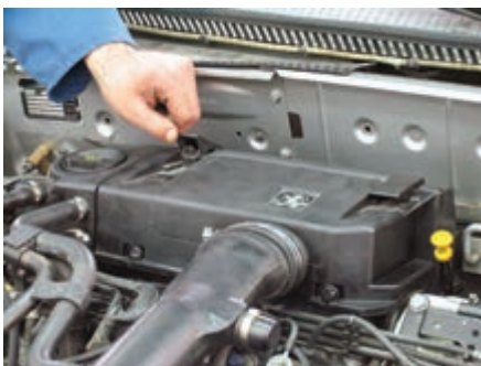
شکل (۲-۶۳) بازکردن در هواکش
