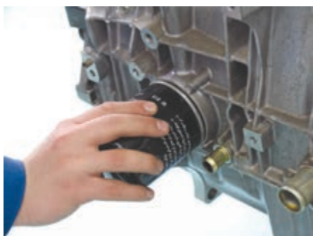
شکل (۲-۵۴) نصب و محکم کردن فیلتر
