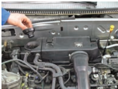
شکل (۲-۵۰) بازکردن درب قالباق موتور
