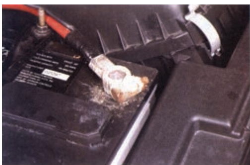
شکل (۲-۸۱) سولفاته شدن بست باتری
