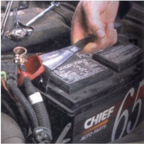
شکل (۲-۸۳) خارج کردن باتری
