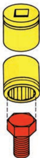
شکل (۱-۱۷) نحوه درگیری آچار بوکس
