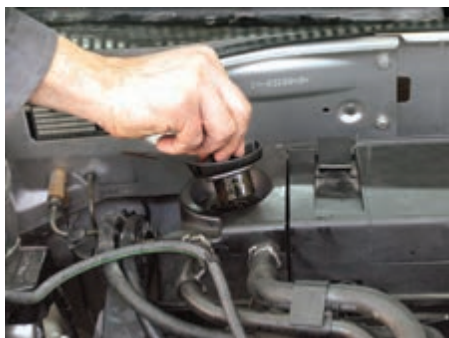
شکل (۴۵- ۲) بازکردن در قالباق موتور
