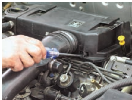
شکل (۲-۶۵) نصب در پوش محافظه فیلتر هوا
