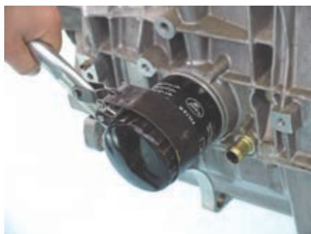
شکل (۴۸- ۲) بازکردن فیلتر با ابزار مخصوص
