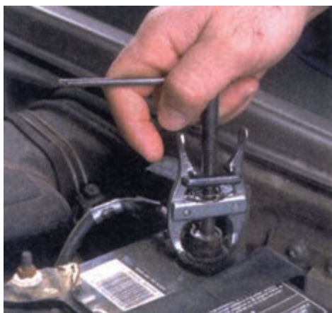
شکل (۲-۸۲) باز کردن بست باتری
