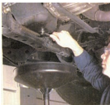
شکل (۲-۵۷) بستن پیچ تخلیه با گشتاور مناسب
