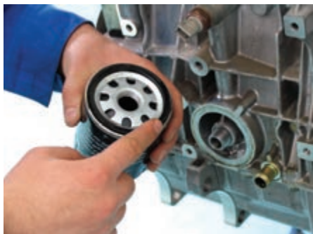
شکل (۲-۵۳) کنترل دندانان و واشر لاستیکی فیلتر
