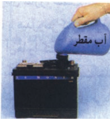
شکل (۲-۸۹) اضافه کردن مایع باتری
