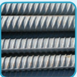
شکل ۱۷-۱- میلگرد با رویه آجدار
