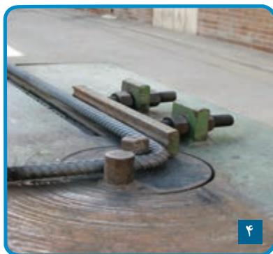
شکل ۳-۶۴ - خم کردن میلگرد
