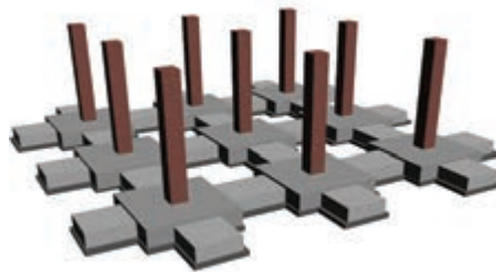
شکل ۱۸-۲- پی کلاف شده
