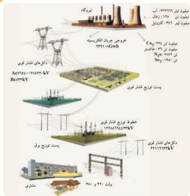
مراحل تولید و انتقال جریان الکتریسیته به واحدهای مصرفی
