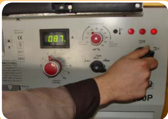
کلیدهای مختلف روی صفحه اصلی رکتی‌فایر جوشکاری
