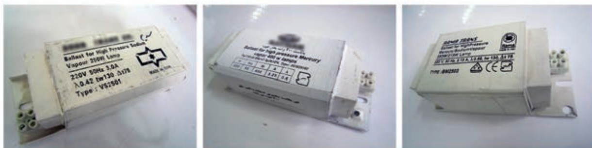
شکل ۲-۲۸ - بالاست لامپ‌های تخلیه در گاز
