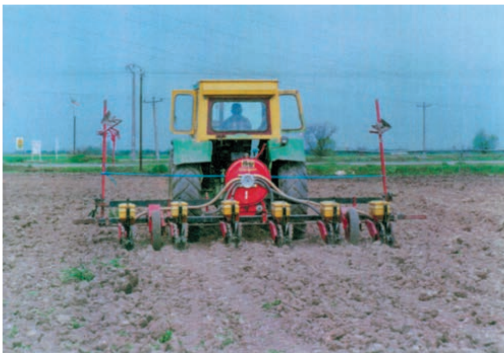
شکل ۴-۶- کاشت آفتابگردان با بذرکار پنوماتیکی
