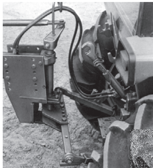
شکل ۲-۷۵- برقراری اتصال بازوها و اتصال هیدرولیکی
