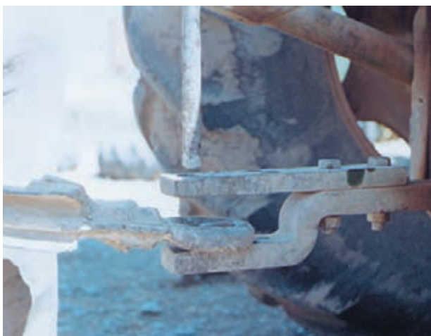
شکل ۳۶-۱- باز کردن پی نورد از تراکتور
