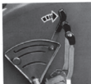
شکل ۲-۶- اهرم اصلی هیدرولیک تراکتور JD۳۱۴۰ در وضعیت بالا
