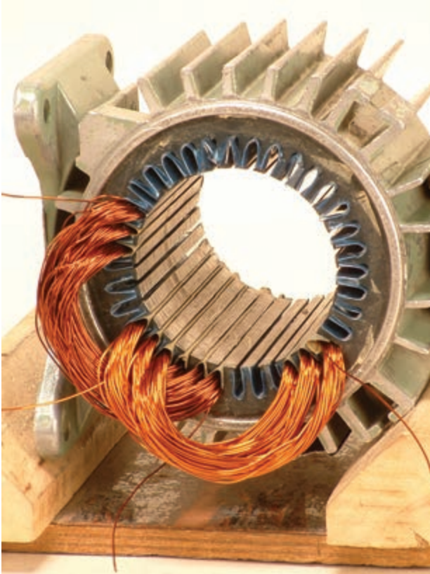
شکل ۲-۲۲- شروع گروه کلاف سوم از شیار شماره ۱۳
