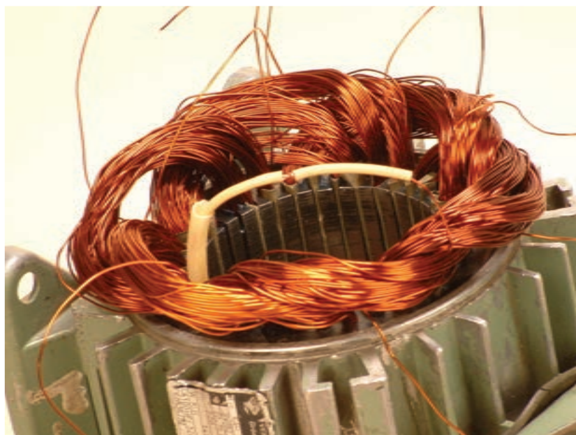
شکل ۳-۹- هدایت وارنیش‌ها به محل لحیم شده
