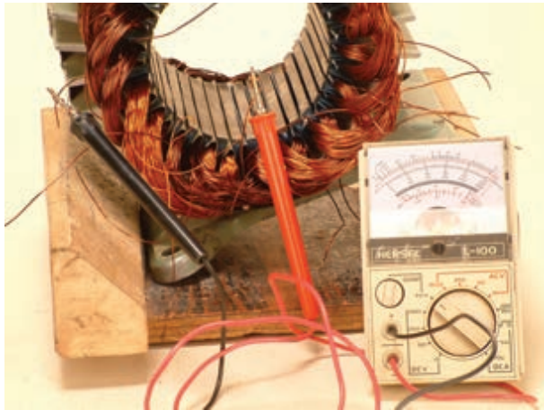
شکل ۳-۴- آزمایش ارتباط کلاف‌های گروه کلاف شماره ۱
