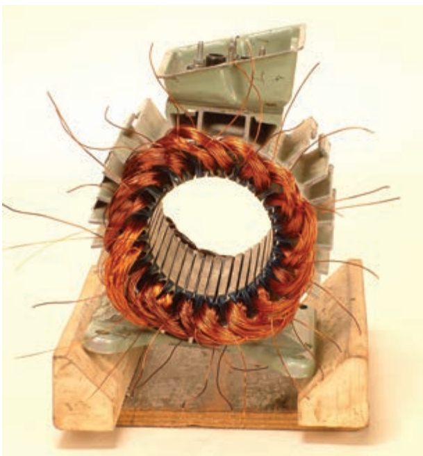
شکل ۱۳-۳- شماره گذاری شیارها
