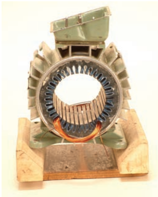
شکل ۲-۱۱- استقرار کامل یک کلاف در داخل شیارهای استاتور
