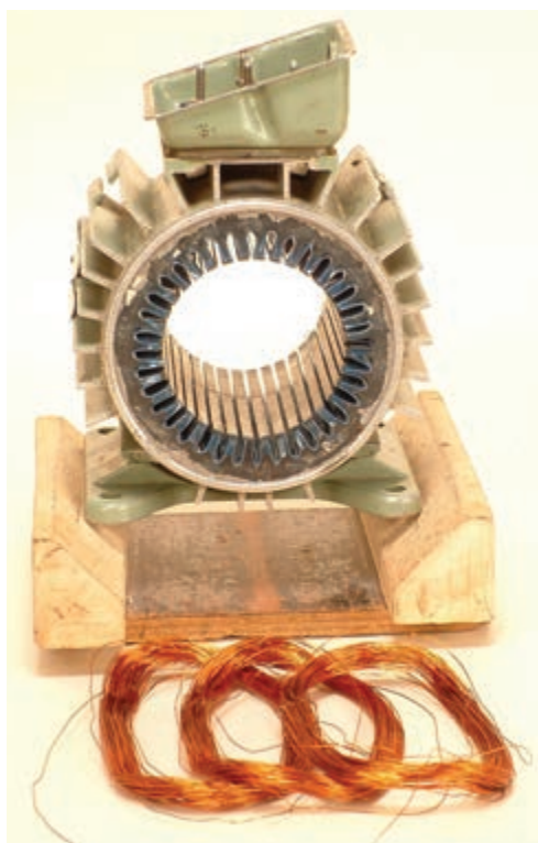
شکل ۲-۵- موقعیت کلاف‌ها در مقابل استاتور، قبل از جاگذاری آنها در داخل استاتور
