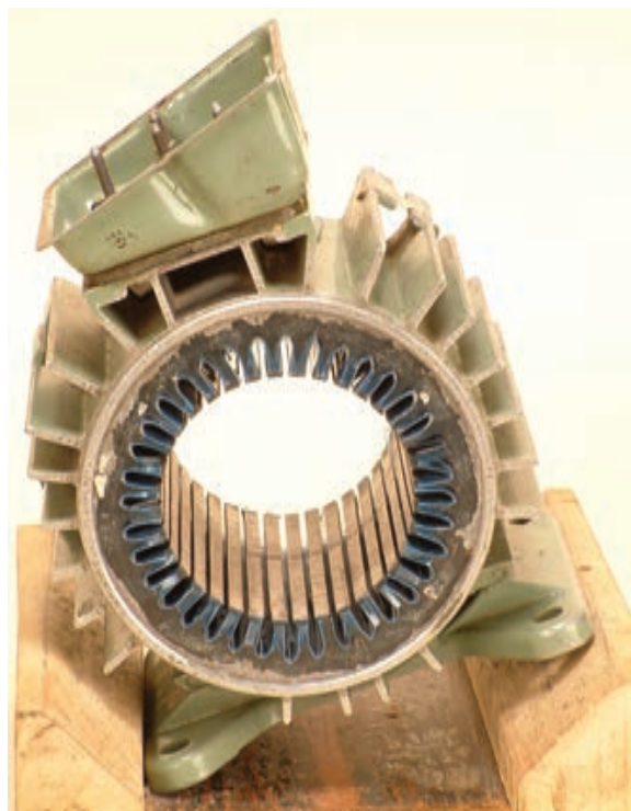
شکل ۱۳-۲- انتخاب شیار شروع و مسیر کلاف‌گذاری
