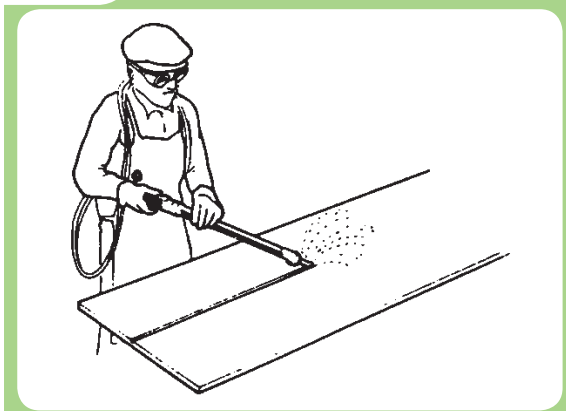
اجرای عملیات برشکاری با مشعل دستی
