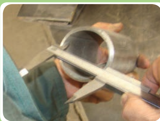
اندازه گیری قطر داخلی لوله توسط کولیس
