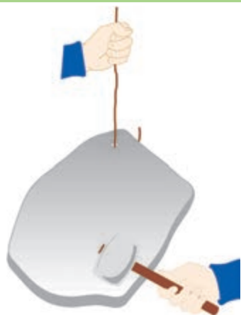
آزمایش ضربه یکی از روش های شناخت کارگاهی فلزات است
