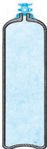
کپسول فولادی مخصوص برای ذخیره اکسیژن
