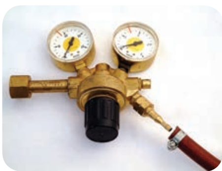
اتصال شیلنگ به رگولاتور گاز
