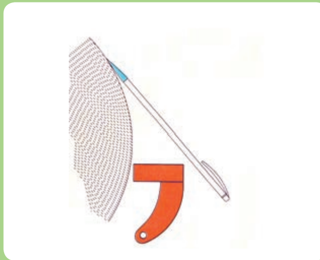
تیز کردن سوزن خط کش
