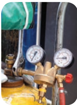
محکم کردن اتصالات رگولاتور به کپسول گاز
