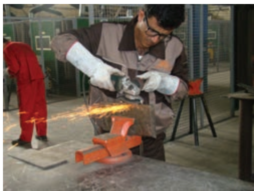
تشخیص نوع فولاد بر اساس آزمایش جرقه
