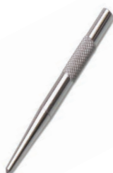
سنبه نشان برای نشانه گذاری روی قطعات فلزی
