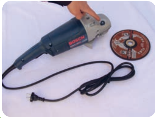
کلید مخصوص قفل کردن محور سنگ
