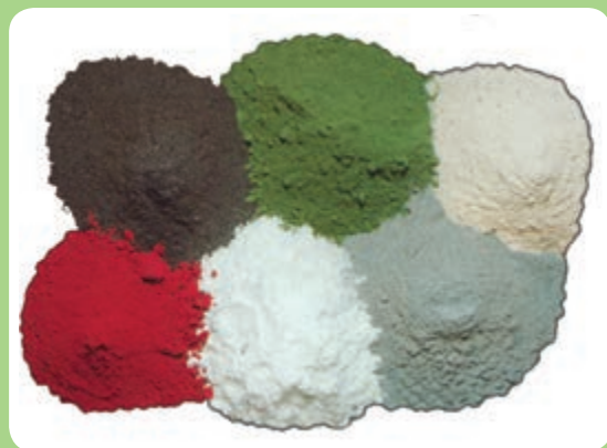
مواد پودری تشکیل دهنده روپوش الکتروود
