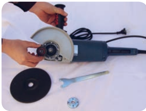
خارج کردن صفحه سنگ و مهره زیر صفحه از روی محور سنگ
