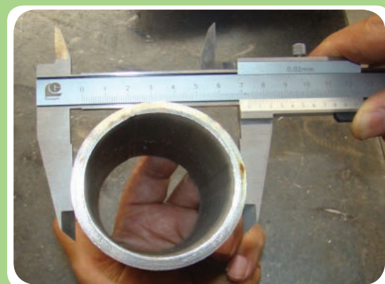
اندازه گیری قطر خارجی لوله توسط کولیس
