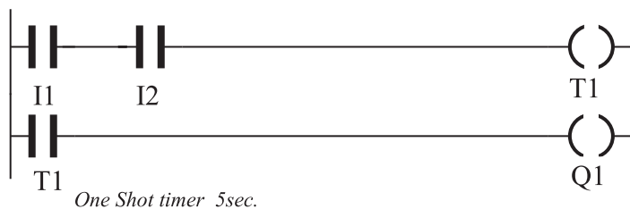
شکل ۹- برنامه نردبانی مدار دستگاه پرس
