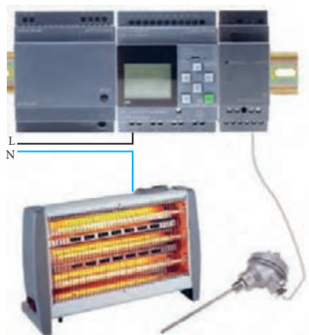
شکل ۵- اندازه‌گیری و کنترل دما با استفاده از رله قابل برنامه‌ریزی
