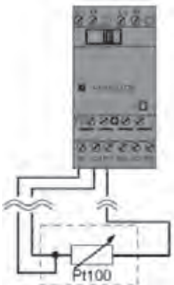
شکل ۷- اتصال حسگر PT100 به کارت دما
