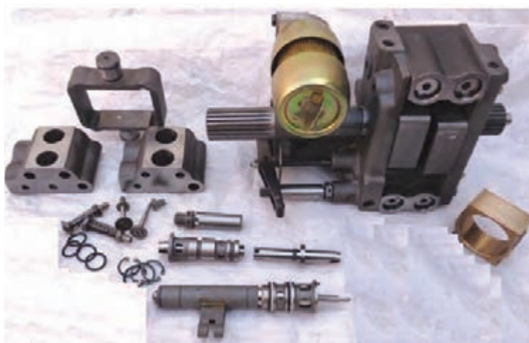
شکل ۴۸- پمپ هیدرولیک MF۲۸۵
