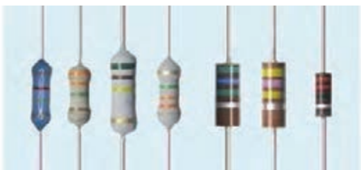
شکل ۲- مقاومت‌های ثابت
