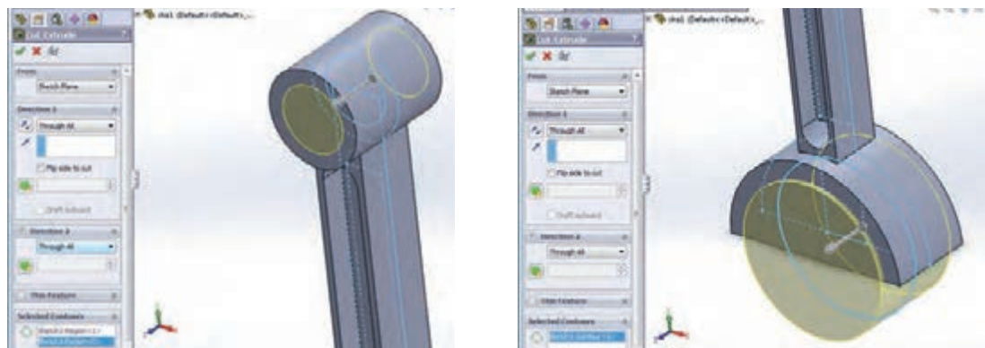
ث- فعال کردن Direction2 و برش به‌روش Through All در هر دو جهت
