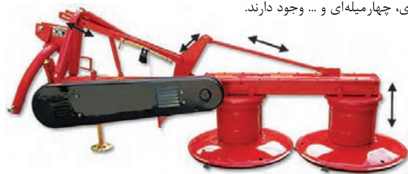
شکل ۴- مکانیزم میله‌ای در دروگر
