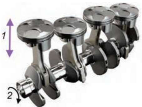
شکل ۱۹- کاربرد مکانیزم لنگ و لغزنده در موتور
