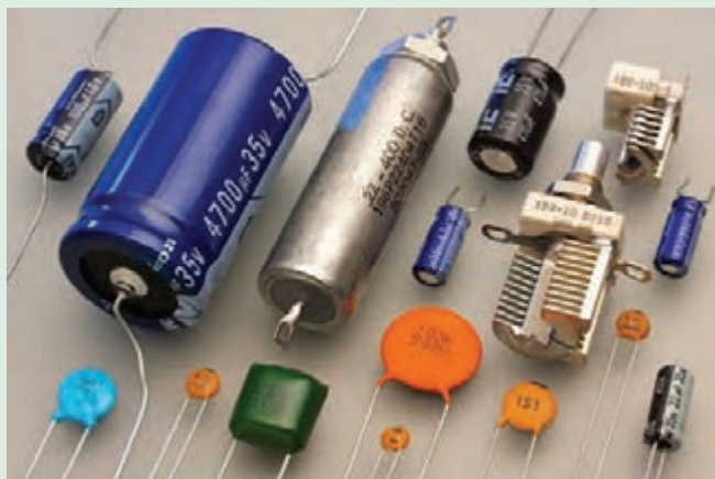
شکل ۶- انواع خازن
