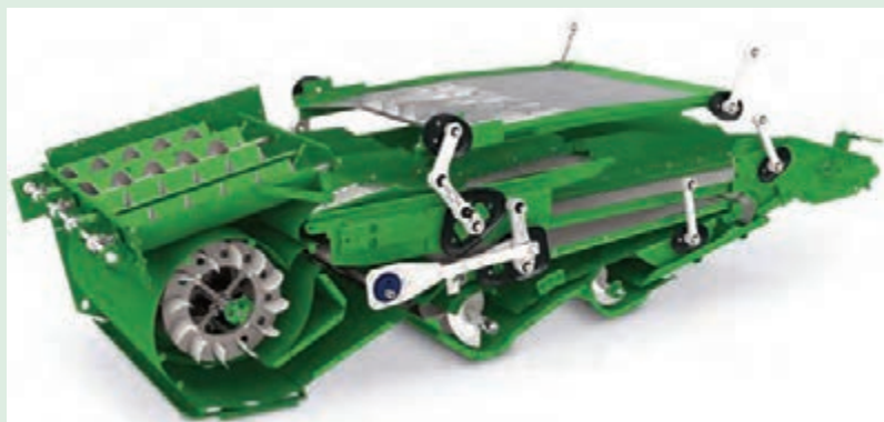
شکل ۶۷ - واحدهای عملیاتی کمباین
