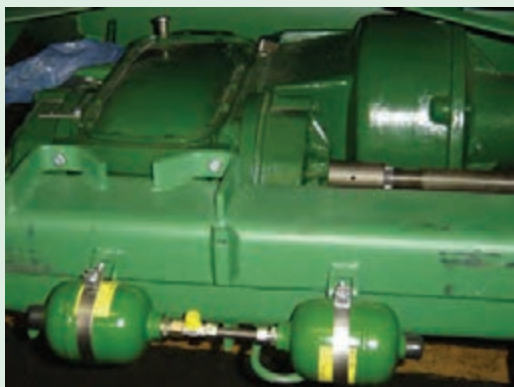
شکل ۳۷- آکومولاتور سیستم تعلیق هد کمباین جاندر ۱۰۵۵
