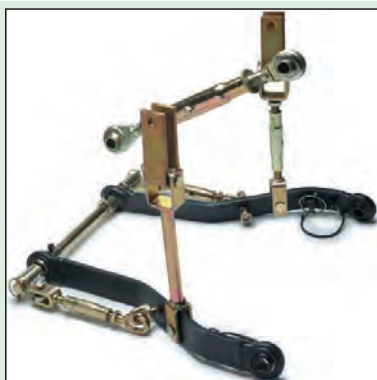
شکل ۶- میله‌ها و مفصل‌های اتصال سه نقطه تراکتور
