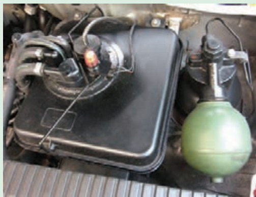
شکل ۳۶- آکومولاتور سیستم تعلیق اتومبیل زانتیا
