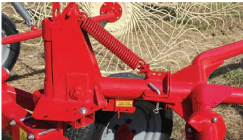
شکل ۱۵- مکانیزم شناوری شانه خورشیدی
