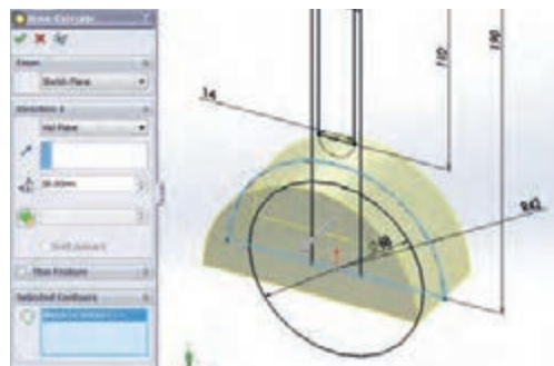
الف - حجم قطعه به روش Mid Plane و به مقدار ۳۸ میلی متر ب - حجم قطعه به روش Mid Plane و به مقدار ۴۲ میلی متر
