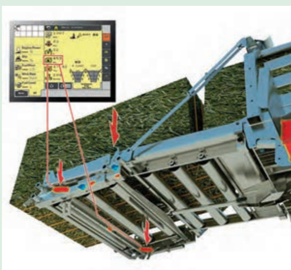
شکل ۴۹- کاربرد لودسل در بسته‌بند مکعبی
