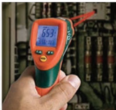
شکل ۲۲- حسگر حرارتی غیر تماسی
