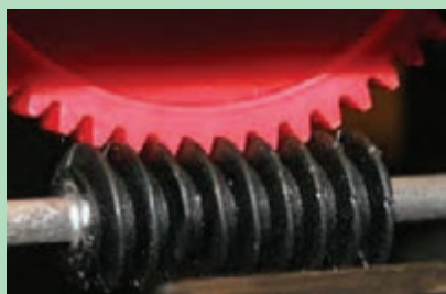
شکل ۵۲- پیچ و چرخ حلزون
