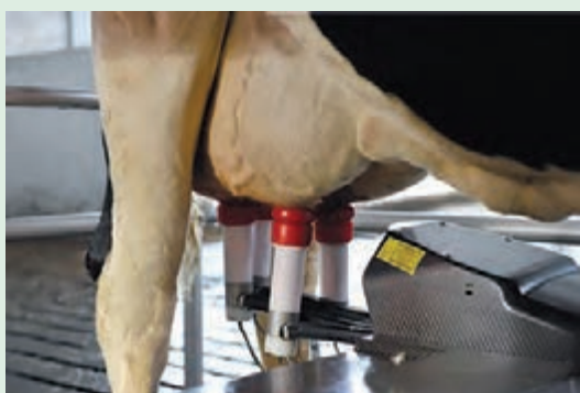
شکل ۵۵- اتصال مکندۀ ربات و آغاز فرایند شیردوشی
