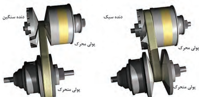
شکل ۶۲- نحوه عملکرد پولی‌های با قطر متغیر
