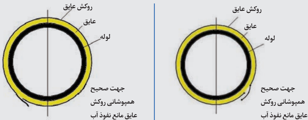
شکل ۶- جهت صحیح روکش عایق
