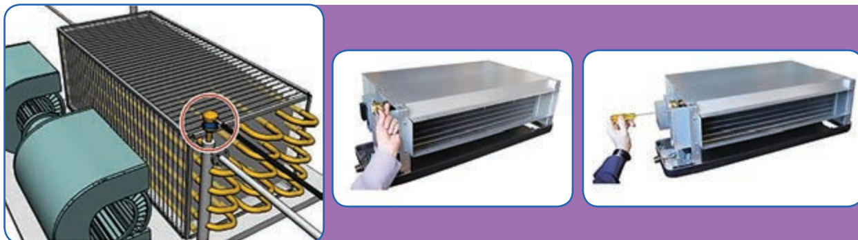
شکل ۲- هواگیری فن کویل
