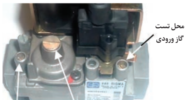
در زیر این درپوش پیچ تنظیم فشار گاز تزریقی است محل تست فشار گاز تزریقی
