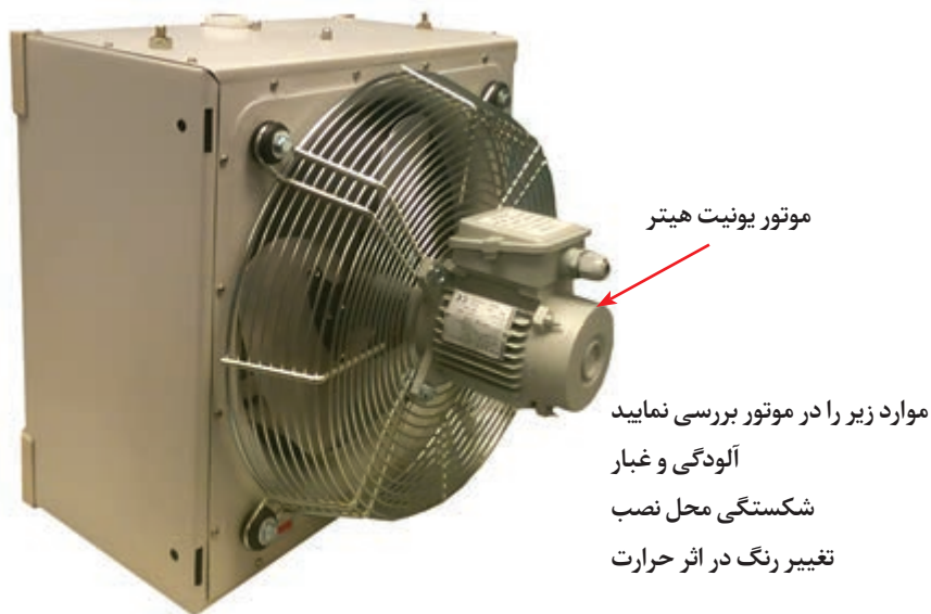
شکل ۱۸- کنترل ظاهری موتور یونیت هیتر
