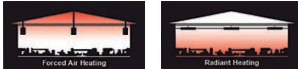
شکل ۷- مقایسه گرمایش تابشی با یونیت هیتر
