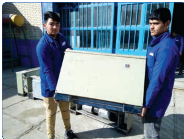
شکل ۱۱- حمل صحیح دستگاه
