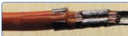
شکل ۱۳- پرس کردن رشته سیم به سر سیم با دستگاه پرس
