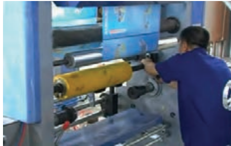
شکل ۶۴- نصب پرس رول سمت اپراتور
