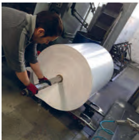
شکل ۳۴- قرار دادن شفت بادی درون بوبین دستگاه
