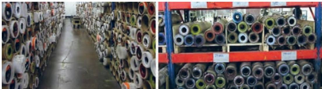
شکل ۹- نگهداری سیلندرها بدون شفت
