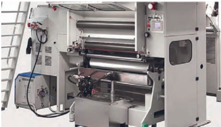
شکل ۴۰- کنترل اتوماتیک گرانیوی مرکب
