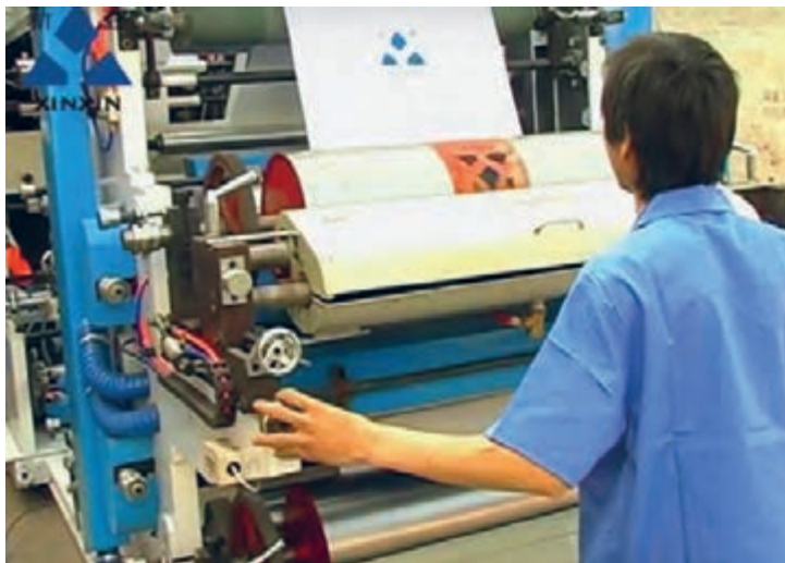
شکل ۲- تنظیم فشار پلیت و سیلندر چاپ
