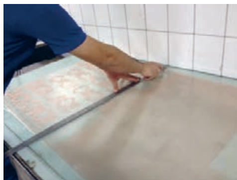
شکل ۹- نحوه برش کلیشه
