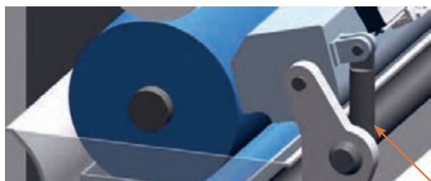
شکل ۸۶- جک تنظیم فشار داکتر بلید
