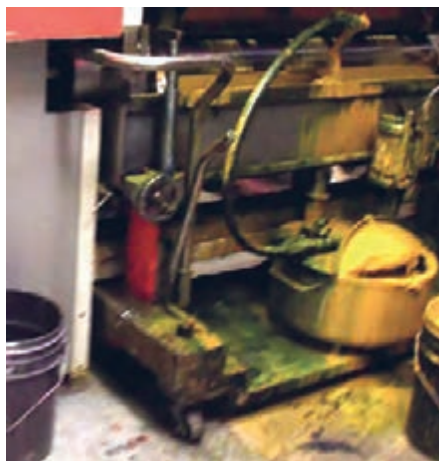
شکل ۴۸- سر ریز شدن مرکب
