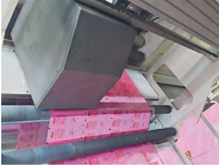
شکل ۱۸- قرار داشتن دوربین روی مسیر حرکت سطح چاپ شونده
