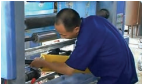
شکل ۶۵- نصب پرس رول سمت موتور
