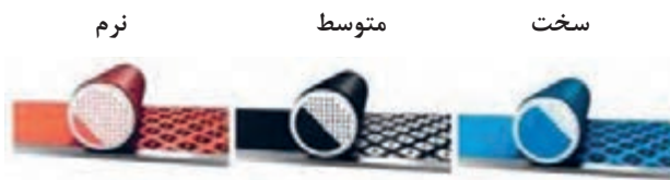
شکل ۱۱- شماتیک فشردگی ذرات فوم چسب پایه
