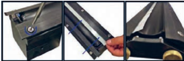
شکل ۹- باز کردن تیغه
