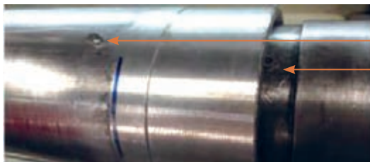
شکل ۱۴- قرار دادن آداپتور روی شفت کلیشه چسبانی
