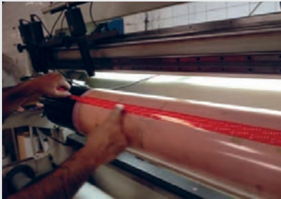
شکل ۲۸- نحوه چسباندن چسب لبه کلیشه
