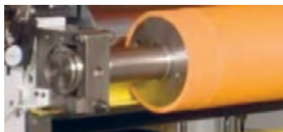
شکل ۵۹- پرس رول با شفت ثابت
