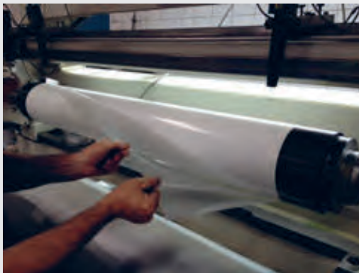
شکل ۱۹- برداشتن لایه محافظ روی چسب
