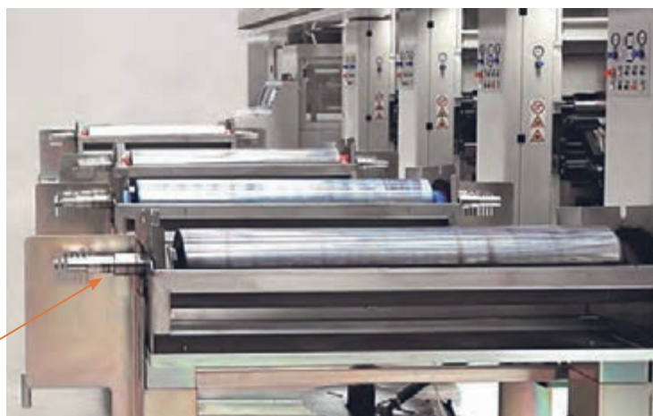
شکل ۴۴- واگن سیلندر جهت نصب در ماشین چاپ
