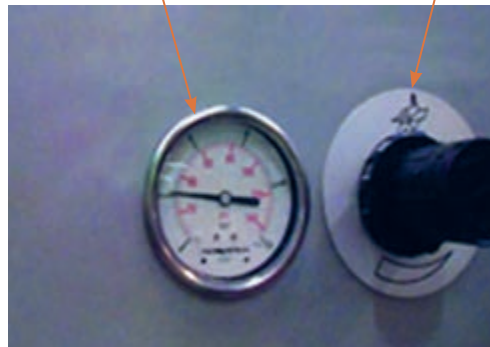
شکل ۶۶- تنظیمات فشار پرس رول طرف موتور
