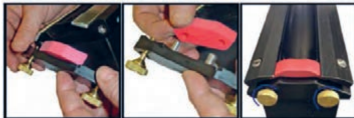
شکل ۱۱- نصب محافظ‌های خروج مرکب
