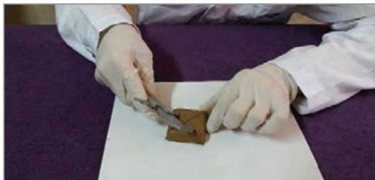
شکل ۸- علامت‌گذاری به وسیله کولیس
