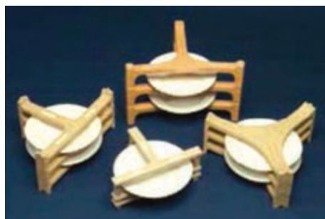
شکل ۴۱- چیدمان بشقاب با سترهای سبک
