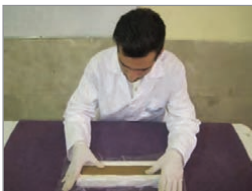
شکل ۳۲- ساخت نمونه‌های مقاومت به پخت
