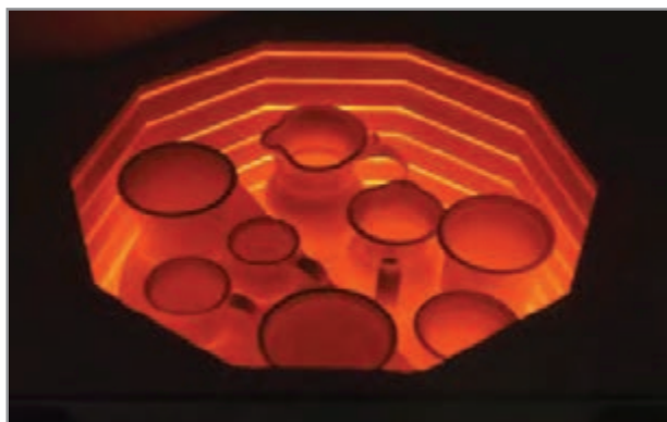
شکل ۲- بدنه‌های سرامیکی در حال پخت
