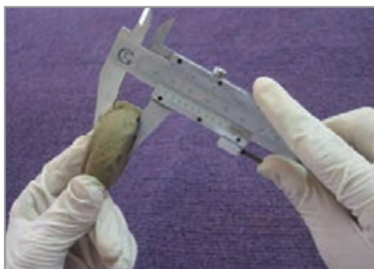
شکل ۶- بررسی ارتفاع ۱۶ میلی‌متر در آزمون ففرکورن
