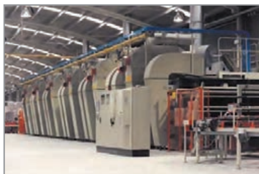
شکل ۱۴- خشک کن تونلی
