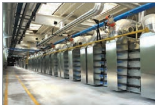
شکل ۱۳- خشک کن پیوسته
