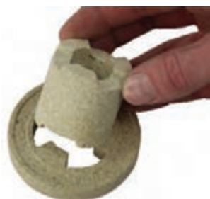
قرار گرفتن اتصال قلعه‌ای بر روی دیسک
