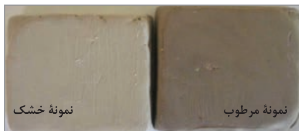
شکل ۲- تأثیر انقباض خشک در کاهش ابعاد نمونه
