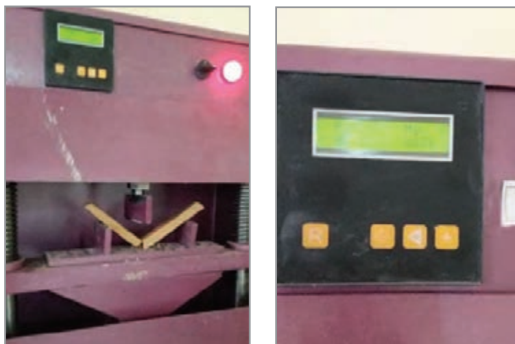
شکل ۲۴- اندازه‌گیری استحکام خمشی خشک نمونه‌ها
