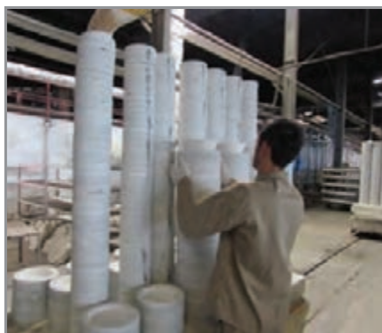
شکل ۴۹- استفاده از ساگار برای چیدمان
