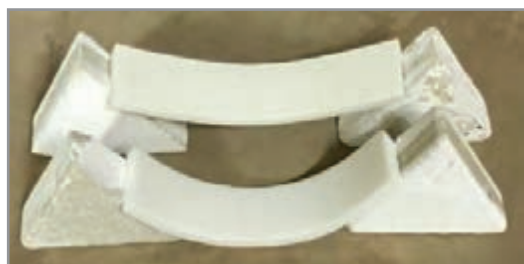
شکل ۳۰- آزمایش مقاومت پخت دو تکیه‌گاهی
