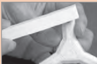
شکل ۵۹ - تمیز کردن نوک پین‌ها
