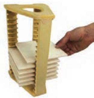
شکل ۵۱ - چیدمان کاشی در چنگک
