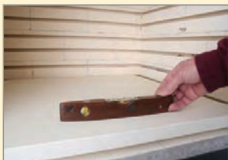
شکل ۲۸- بررسی تراز بودن کف کوره کارگاهی
