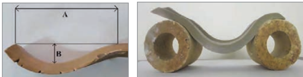
شکل ۳۶- اندازه‌گیری میزان انحنای نمونه مقاومت به پخت
