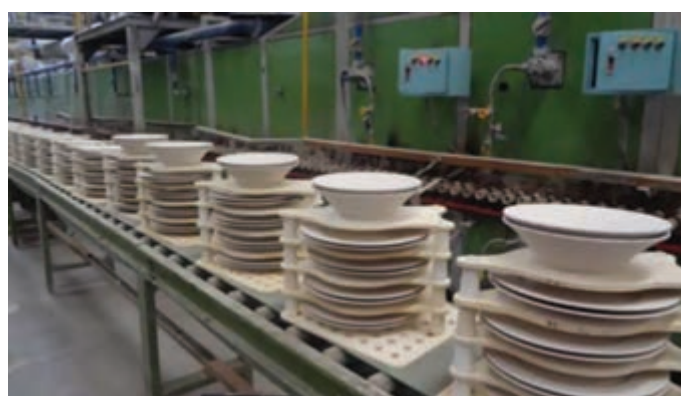
شکل ۴۲- استفاده از سترها برای پخت ظروف
