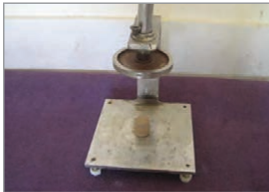
شکل ۶- بررسی ارتفاع ۱۶ میلی‌متر در آزمون ففرکورن
