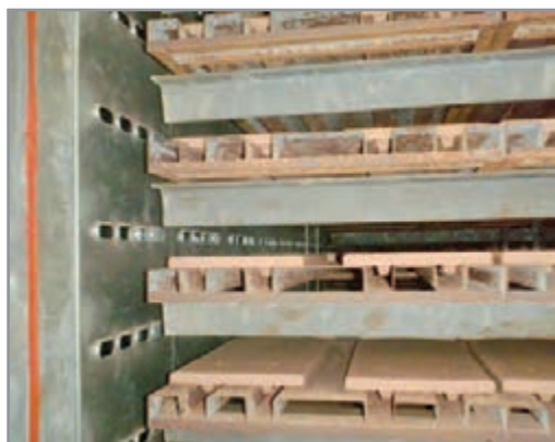
شکل ۱۶- دمش هوا از روزنه ها به قطعه
