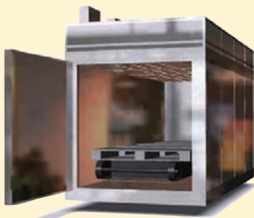
شکل ۱۹- خشک کن ماکروویو
