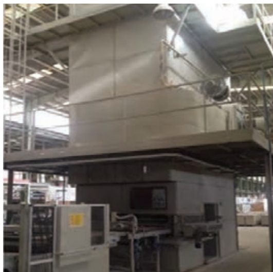
شکل ۱۸- خشک کن عمودی سریع
