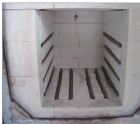
شکل ۱۳- نصب المنت درون شیار
