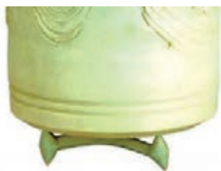
شکل ۵۶- قرار گرفتن قطعه بر روی سه پایه
