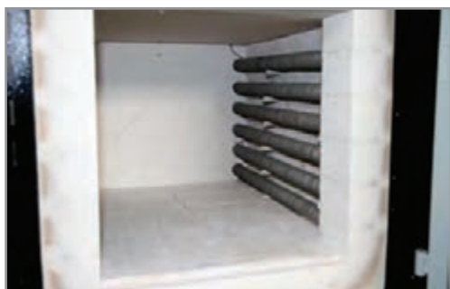
شکل ۱۲- نصب المنت بر روی پایه
