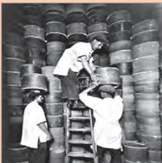
شکل ۶۷ - چیدمان ستونی ساگارها در کوره‌های سنتی
