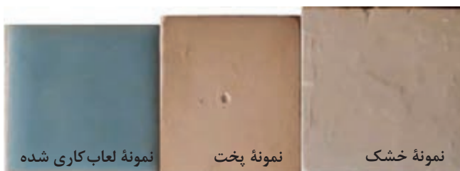
شکل ۱۲- تأثیر انقباض پخت بر ابعاد نمونه
