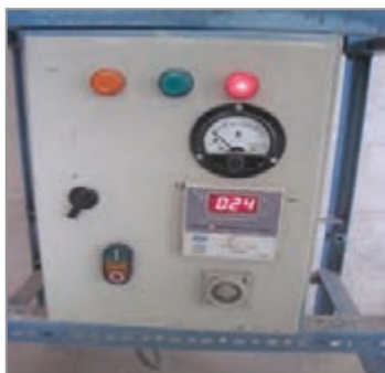
شکل ۳۵- اندازه‌گیری دمای کوره
