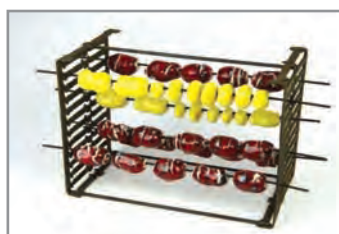
شکل ۶۱ - سیم و پایه سرامیکی
