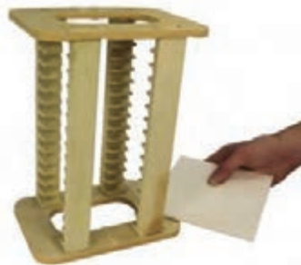
شکل ۵۱ - چیدمان کاشی در چنگک
