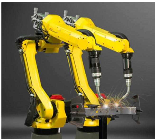
شکل ۳۱: ربات جوشکاری پلاسما
