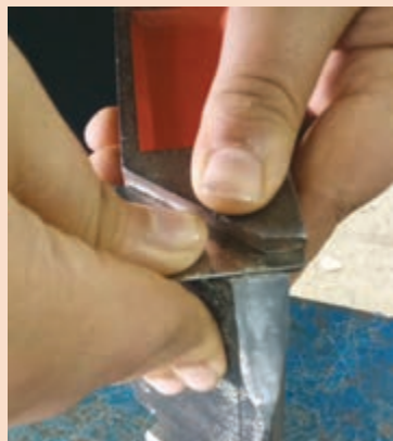
شکل ۱۶-الف) باقی گذاشتن مقداری از ضخامت ورق برای سوهان کاری ب) بررسی صحت زاویه پخ
