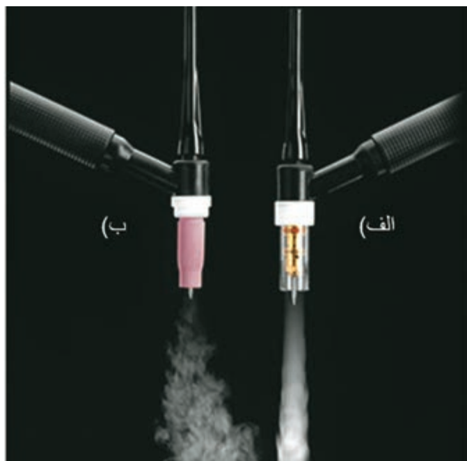
شکل ۱۴- لنز گازی در فرایند TIG
