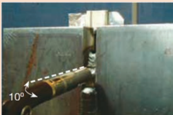
شکل ۲۵- زاویه تورچ و جهت حرکت آن برای انجام پاس دوم
