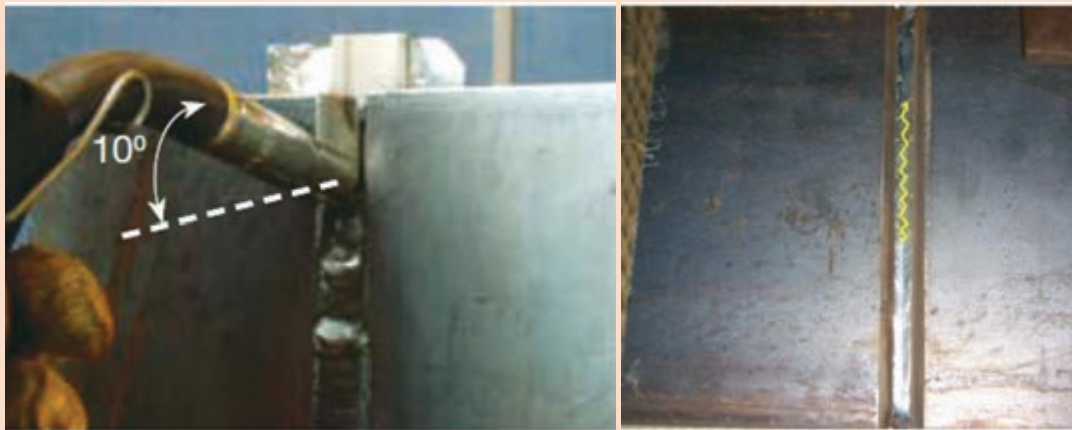
شکل ۲۴- زاویه تورچ و جهت حرکت آن
