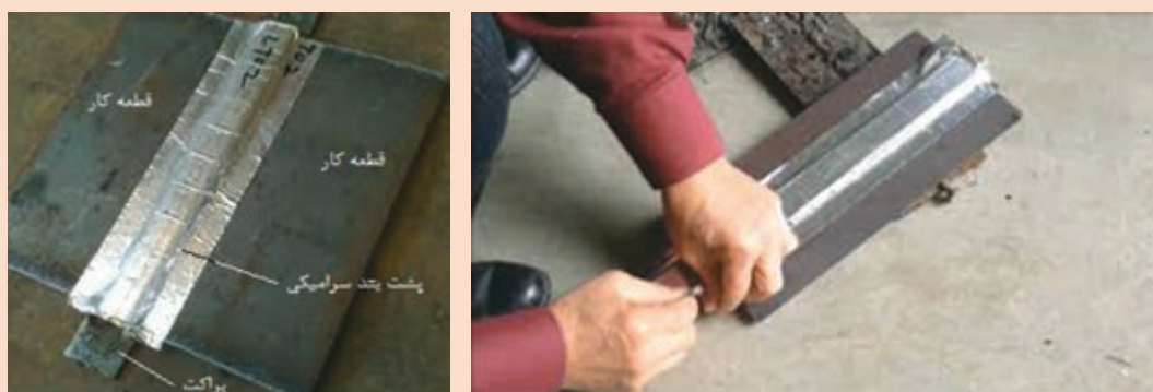
شکل ۱۸- نصب پشت بند سرامیکی
