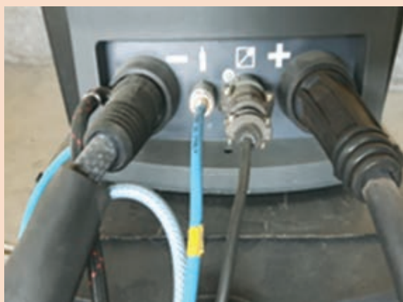
شکل ۹- کابل اتصال سوئیچی
