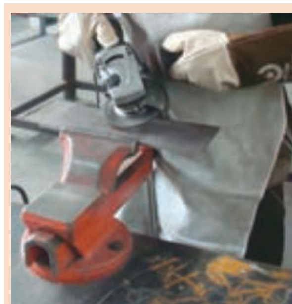
شکل ۱۲- سنگ زدن پشت ورق (ریشه جوش)
