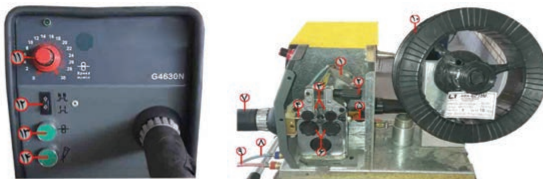
شکل ۱۵- اجزای منبع تغذیه سیم جوش
