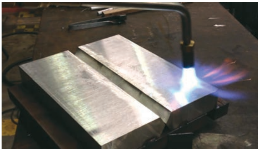
شکل ۵- پیش گرم کردن قطعه ضخیم توسط شعله
