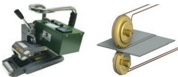
شکل ۷- جوشکاری با غلتک‌های داغ (Hot Rollers Welding) و دستگاه جوش آن
