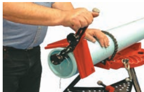
شکل ۲۴- پخ زدن قطعات پلاستیکی برای جوشکاری
