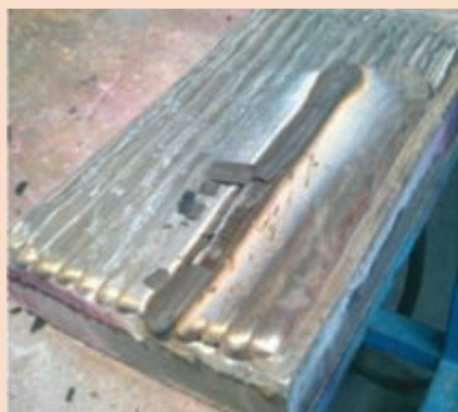
شکل ۲۰ - شکل نهایی قطعه کار پوشش شده با جوش پوششی
