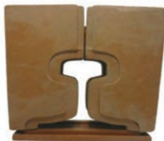
شکل ۷- قالب جوشکاری ترمیت و قرارگیری آن در اطراف ناحیه اتصال
