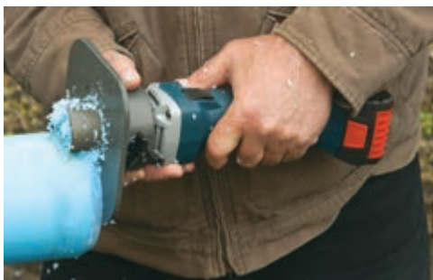
شکل ۲۴- پخ زدن قطعات پلاستیکی برای جوشکاری
