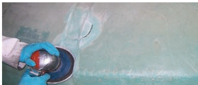
شکل ۲۶- آماده‌سازی سطوح پلاستیکی قبل از جوشکاری
