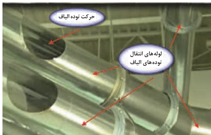
شکل ۸- لوله‌های انتقال الیاف در سیستم شوت فید
