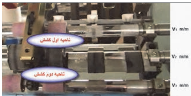
شکل ۲۳- نواحی کشش در رینگ
