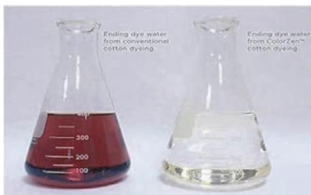
شکل ۲۶- تفاوت پساب حاصل از رنگری پنبه در حالت معمولی و در حالت استفاده از تکنولوژی Colorzen
