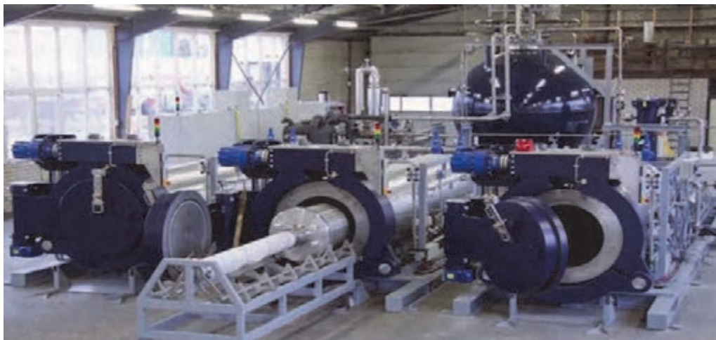
شکل ۲۵- یک نمونه ماشین رنگریزی فوق بحرانی CO ۲
