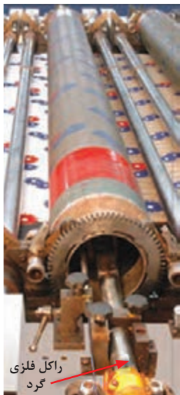
شکل ۲۱- اندرینگ و نحوه قرارگیری آن روی شابلون روتاری و محل قرارگیری
