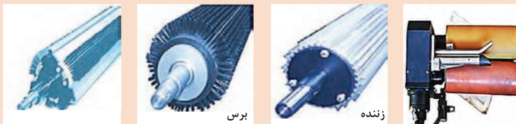
شکل ۲- یک حاشیه‌گیر پارچه و بخشی از برس مویی و زننده و برس و زننده با همدیگر در ماشین پرسوزی
