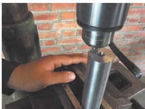
شکل ۲۳ - مته‌مرغ‌زنی به وسیله ماشین مته ستونی
