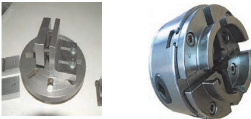
شکل ۱۹ - فیکسچرهای مخصوص لنگ تراشی
