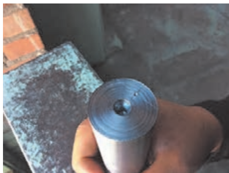
شکل ۲۲ - سنبه‌نشان‌زدن پیشانی قطعه کار
