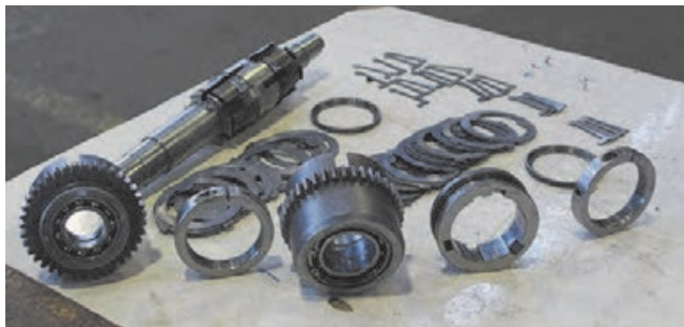
شکل ۴۰- اجزای مجموعه کلاچ
