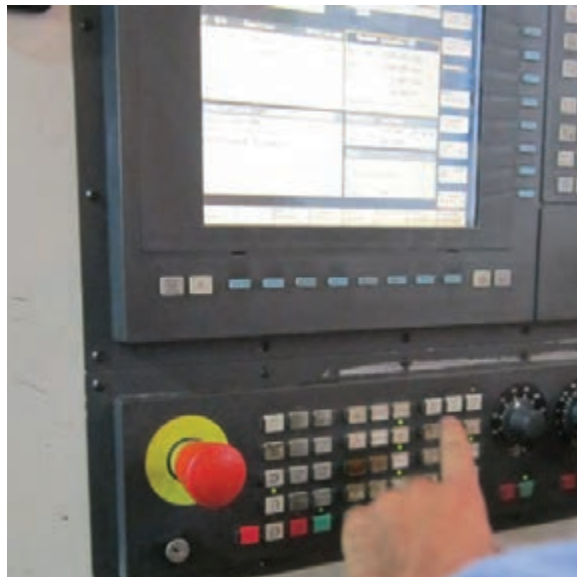
شکل ۲۴- زدن کلید TURRET
