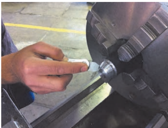
شکل ۱۲- کنترل فرم به وسیله شابلون
