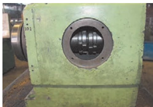
شکل ۵- سفت کردن یاتاقان جلوی دستگاه
