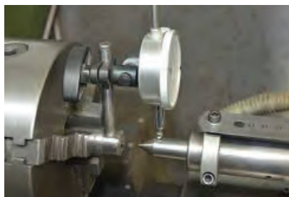
شکل ۳۰- اندازه‌گیری انحراف مرغک
