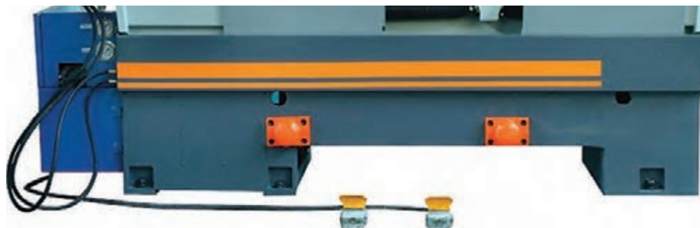
شکل ۵- مجموعه پایه و بدنه دستگاه تراش
