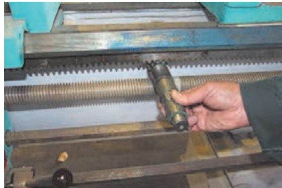
شکل ۱۵- درگیری چرخ‌دنده با دنده شانهای
