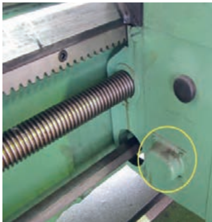
شکل ۲۰- پیچ تنظیم حساسیت اهرم‌های خودکار
