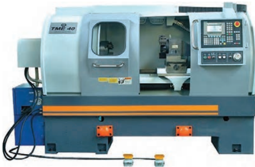
شکل ۴- ماشین تراش CNC TME۴۰
