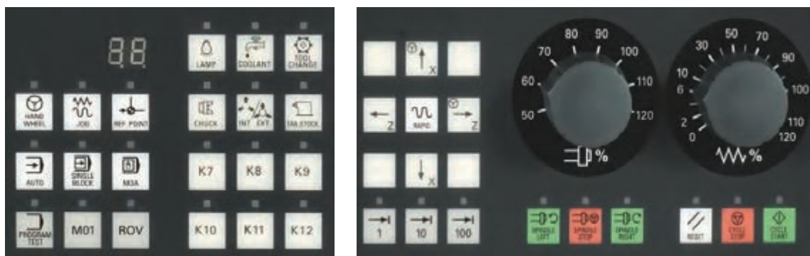
شکل ۱۷- کلیدهای اپراتوری سیستم کنترل
