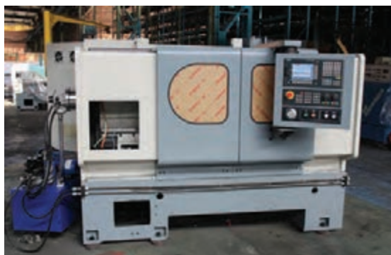
شکل ۱۳- مجموعه سیستم کنترل دستگاه
