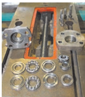
شکل ۹- یاتاقان‌بندی پیچ هادی محور عرضی
