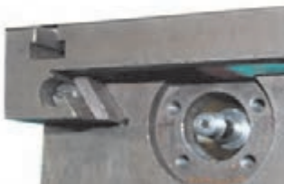
پیچ تکیه‌گاهی انتهای گوه محور عرضی شکل ۱۲- سوپرت عرضی
