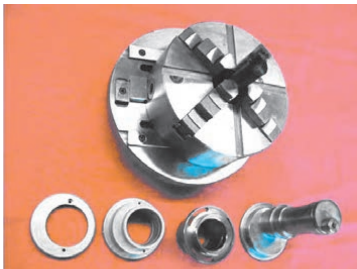
شکل ۱۷- سه‌نظام قابل تنظیم و قطعات تولید شده
