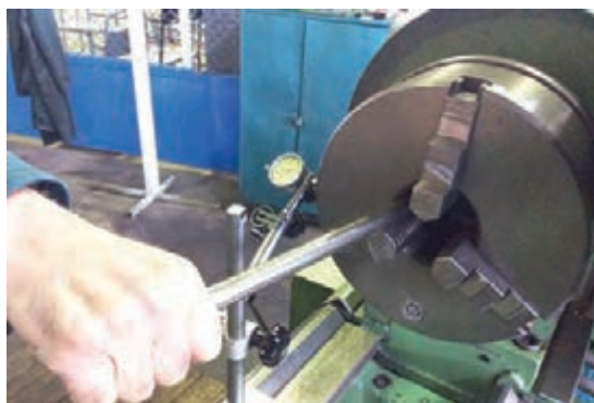
شکل ۳- اندازه گیری لقی شعاعی
