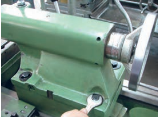
شکل ۲۸- سفت کردن پیچ‌های تثبیت
