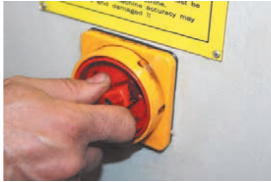
شکل ۱۸- روشن کردن دستگاه
