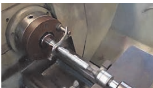
شکل ۲۰ - لنگ تراشی بین دو مرغک
