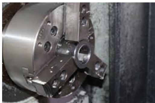
شکل ۹- استقرار سه‌نظام روی مجموعه محور اصلی
