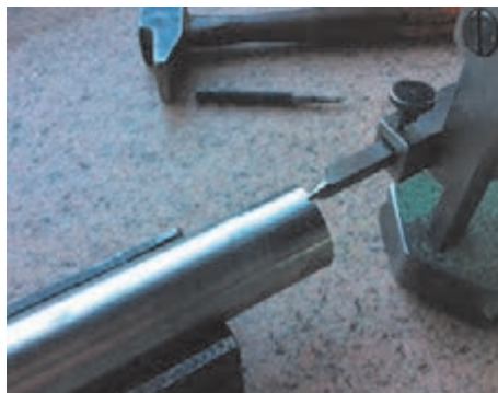
شکل ۲۱ - خط‌کشی و تعیین مراکز لنگ
