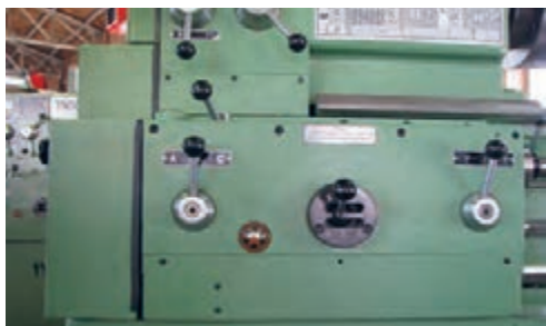
شکل ۲۵- موقعیت جعبه دنده پیچ‌بری
