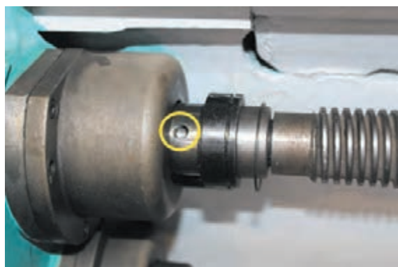
شکل ۳۴- پین فیوز مکانیکی
