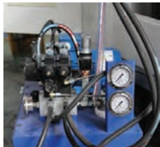
شکل ۱۱- سیستم هیدرولیک ماشین تراش CNC مدل ۴۰ TME
