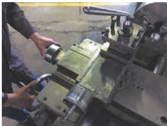
شکل ۱۰- حرکت همزمان سوپرت‌های دستگاه
