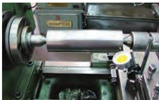
شکل ۲۷- اندازه‌گیری انحراف دستگاه مرگک
