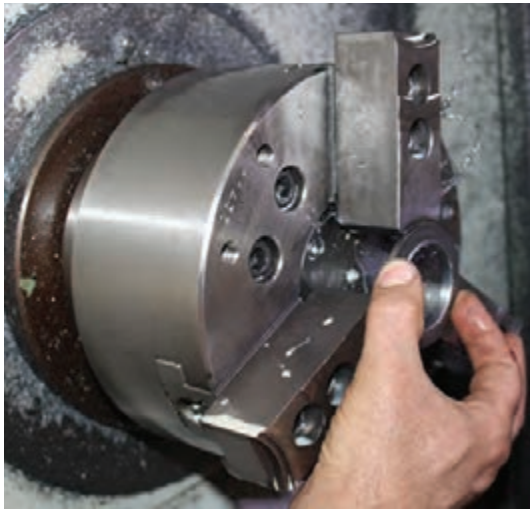
شکل ۳۰- بستن قطعه کار روی سه نظام
