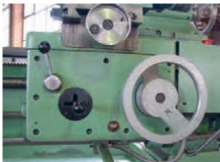
شکل ۱۹- جعبه دنده سوپرت
