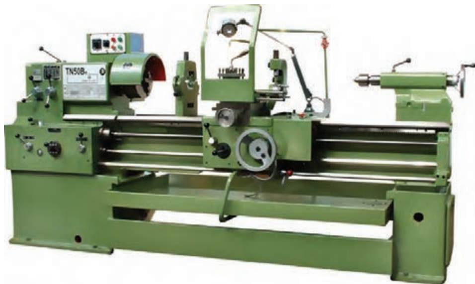
شکل ۱- ماشین تراش دستی TN50B
