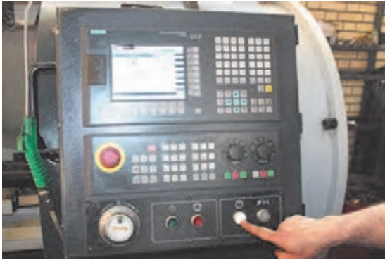
شکل ۲۱- زدن مجدد کلید سیستم هیدرولیک
