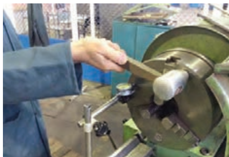
شکل ۷- اندازه‌گیری میزان لقی محوری
