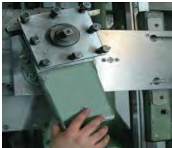
شکل ۱۲- مخروط تراشی به روش انحراف سوپرت بالایی
