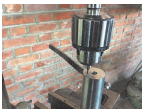
شکل ۲۳ - مته‌مرغ‌زنی به وسیله ماشین مته ستونی
