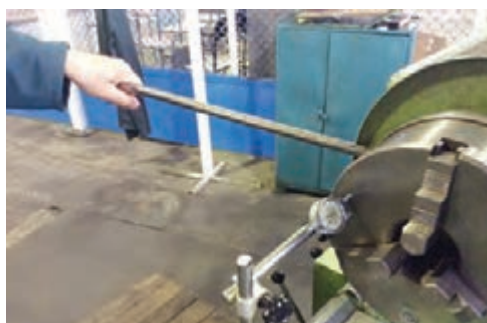
شکل ۷- اندازه‌گیری میزان لقی محوری
