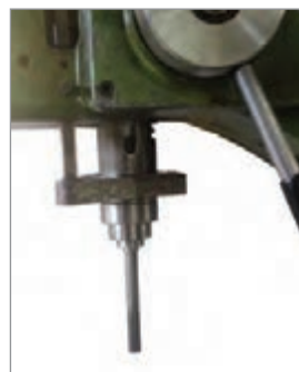
شکل ۱۳- نصب برقوروی محور دستگاه مته
