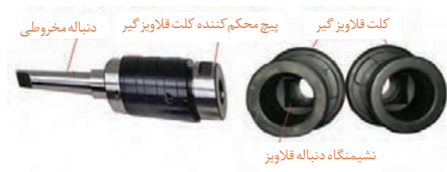
شکل ۶- فشنگی و قلاویز گیر
