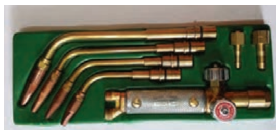
شکل ۲۰- مشعل و سر یک‌های قابل تعویض جوشکاری
