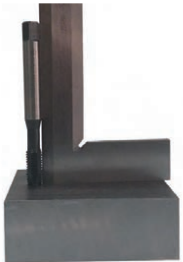
شکل ۷- کنترل عمود بودن قلاویز با سوراخ
