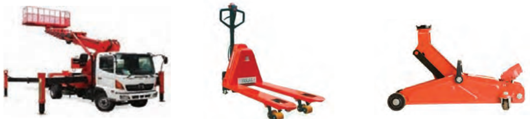
شکل ۲۵- نمونه‌های دیگری از مکانیزم‌های هیدرولیکی
