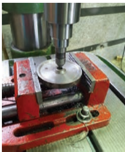
شکل ۹- استفاده از مرغک در ایجاد هم‌مرکزی صحیح
