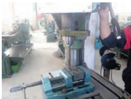
شکل ۱۳- نصب برقوروی محور دستگاه مته
