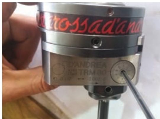
شکل ۱۱- جابه جایی به کمک ورنیه های روی ابزار
