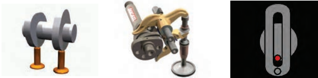
شکل ۲۸- نمونه‌هایی از مکانیزم‌های لنگی و بادامکی
