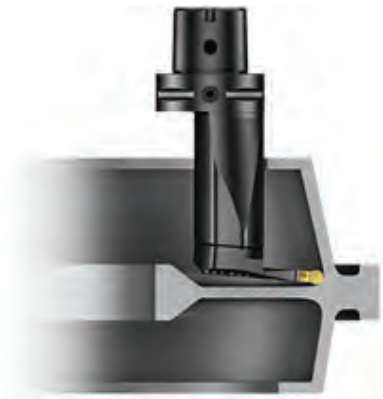
شکل ۵- ایجاد شیار در داخل سوراخ
