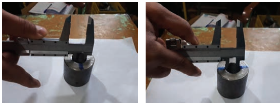
شکل ۱۵- کنترل دایره ای بودن سوراخ
