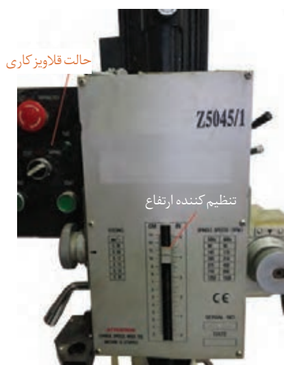
شکل ۴- کُلگی قلاویز ماشینی با قابلیت تنظیم ارتفاع
