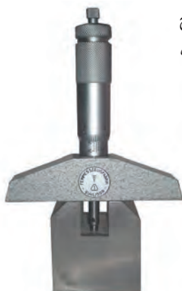
شکل ۵- اندازه گیری با میکرومتر عمق سنج
