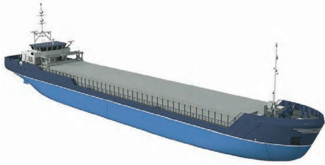
شکل ۱۰- سطح خیس شده شناور (ناحیه آبی‌رنگ)
