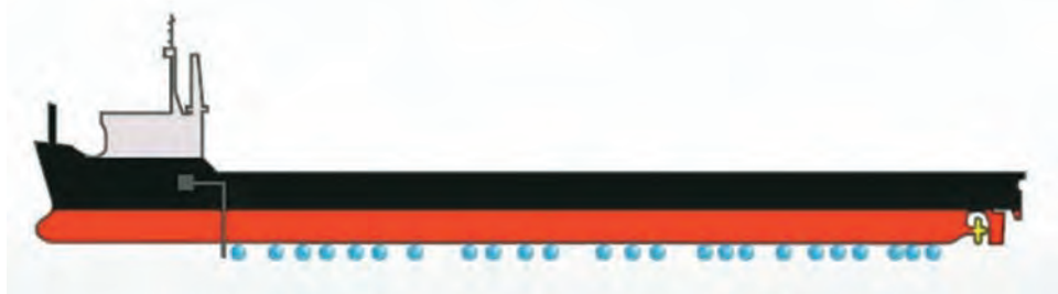
شکل ۲۲-دمیدن هوا در زیر بدنه شناور بجهت کاهش مقاومت شناور
