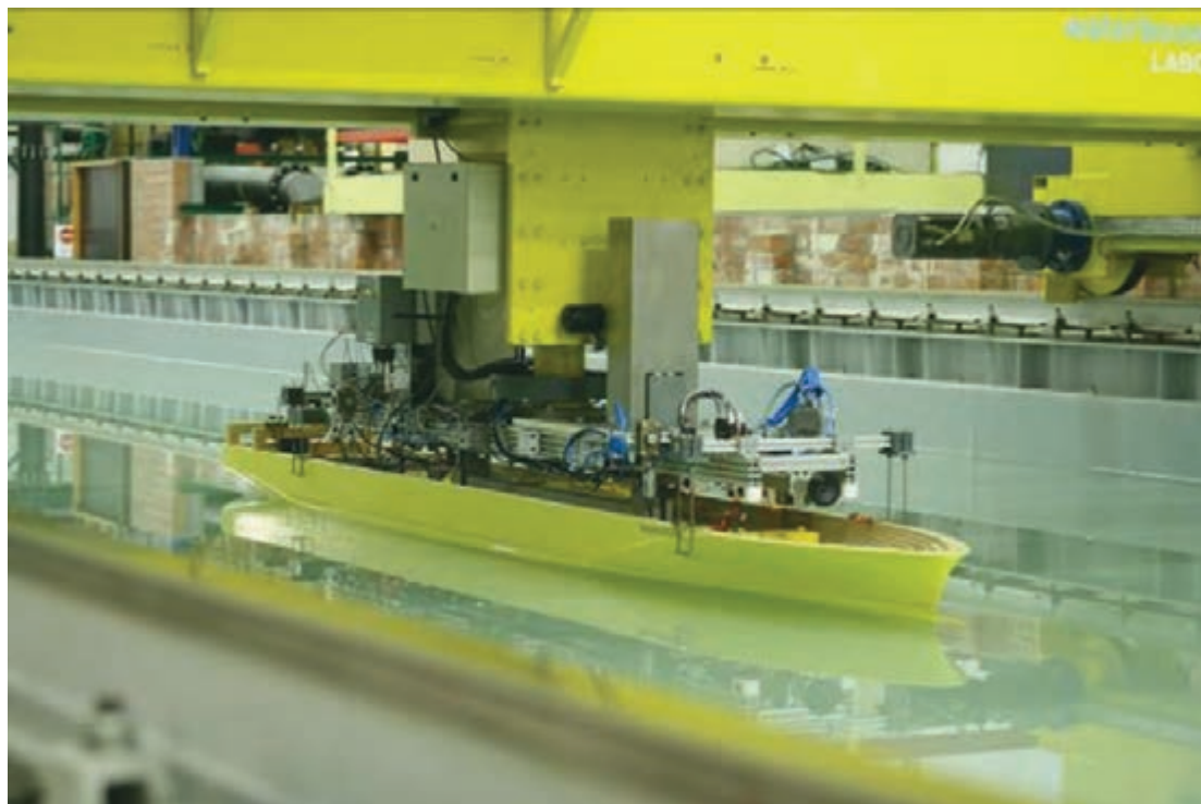
شکل ۱۳- حوضچه کشش و آزمون مدل یک شناور کانتینر بر
