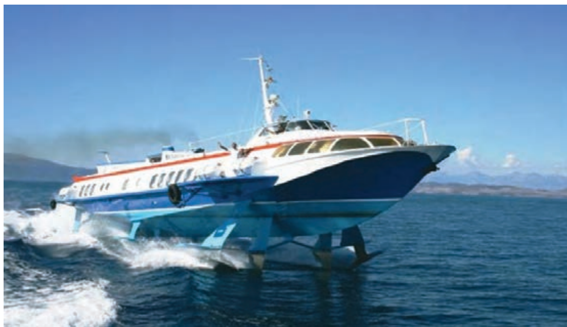
شکل ۲۸- شناور هیدروفیل که هنگام حرکت از سطح آب بالا می‌آید.
