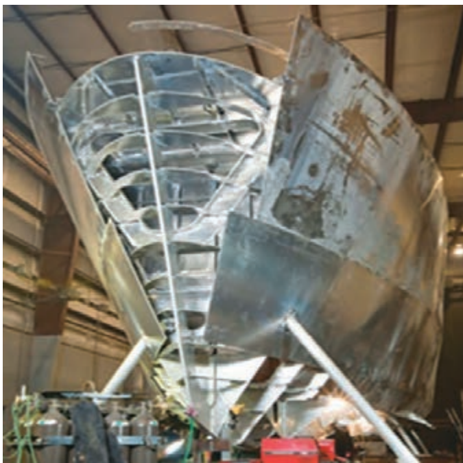
شکل ۲۳- سازهٔ سینهٔ یک شناور در حال ساخت
