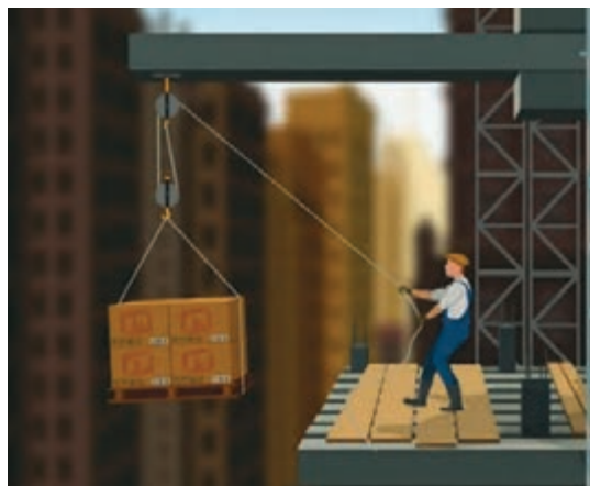
شکل ۲۶- ترکیب دو قرقه برای افزایش بهره مکانیکی
