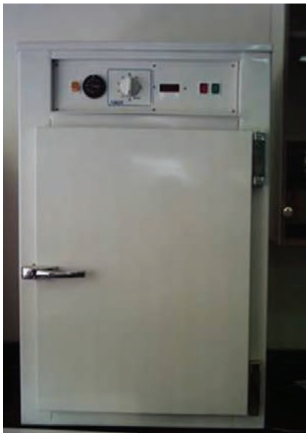
شکل ۱-۳- دستگاه خشک کن (اُون)
