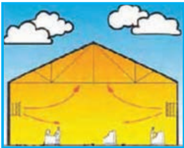
تصویر ۱-۲- مقایسه‌ی سیستم‌های گرمایشی جابه‌جایی و تابشی
