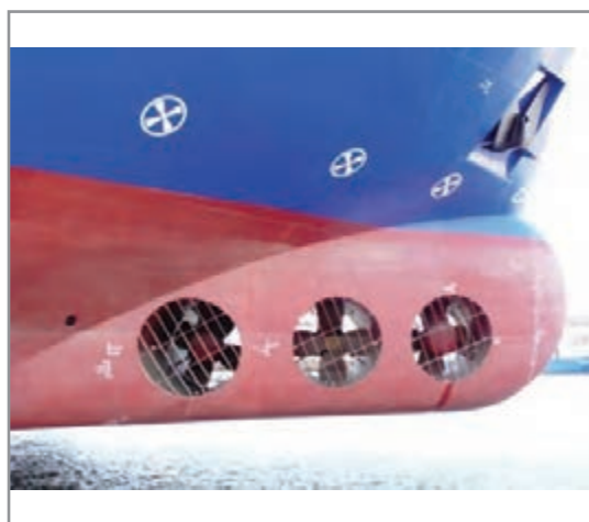
شکل ۵ - سامانه bow thruster
