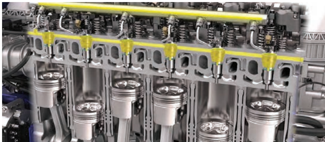
شکل ۲۰- سامانه تزریق سوخت
