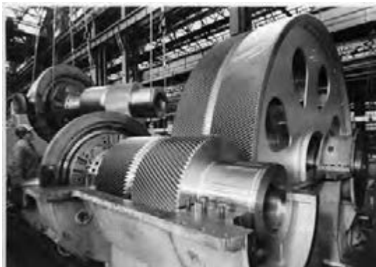
شکل ۲۶ - جعبه دنده یک شناور بزرگ
