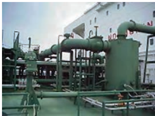
شکل ۲۳- سامانهٔ گاز بی‌اثر
