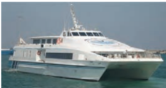
شکل ۱۵- یک شناور کاتاماران با بدنه آلومینیومی
