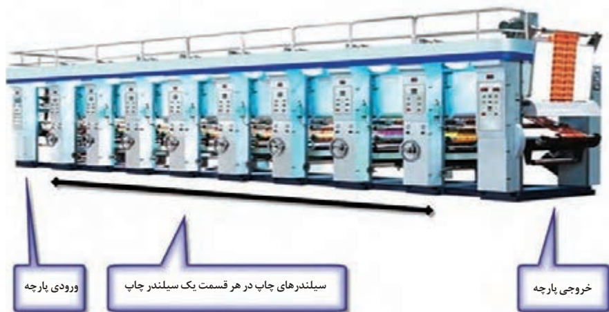
شکل ۸- نمای عملکرد ماشین چاپ غلتکی افقی
