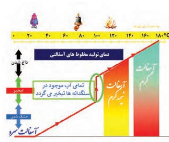
شکل ۲۷- دسته‌بندی آسفالت براساس دمای تولید آسفالت
