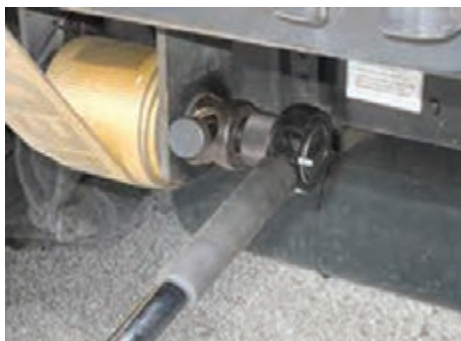
شکل ۸- نمونه‌ای از وینچ برای کشیدن بند
