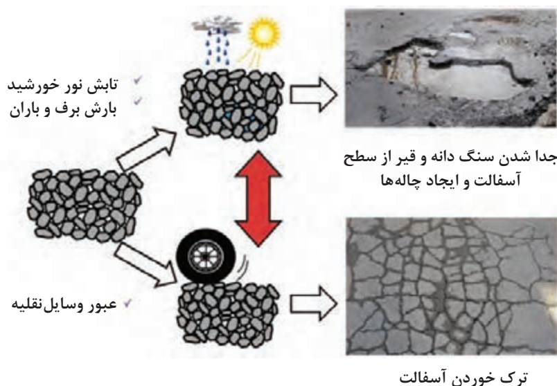
شکل ۱۹- اثر عوامل مختلف بر خرابی آسفالت
