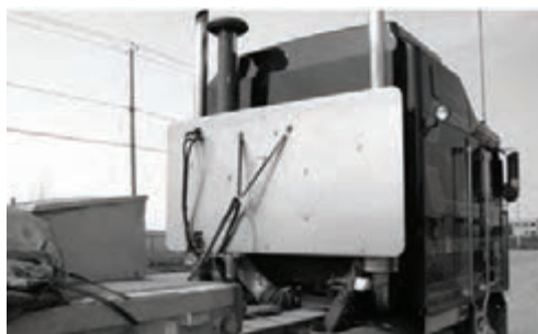
شکل ۲۲- محل نصب سینی جلو در پشت کابین راننده
