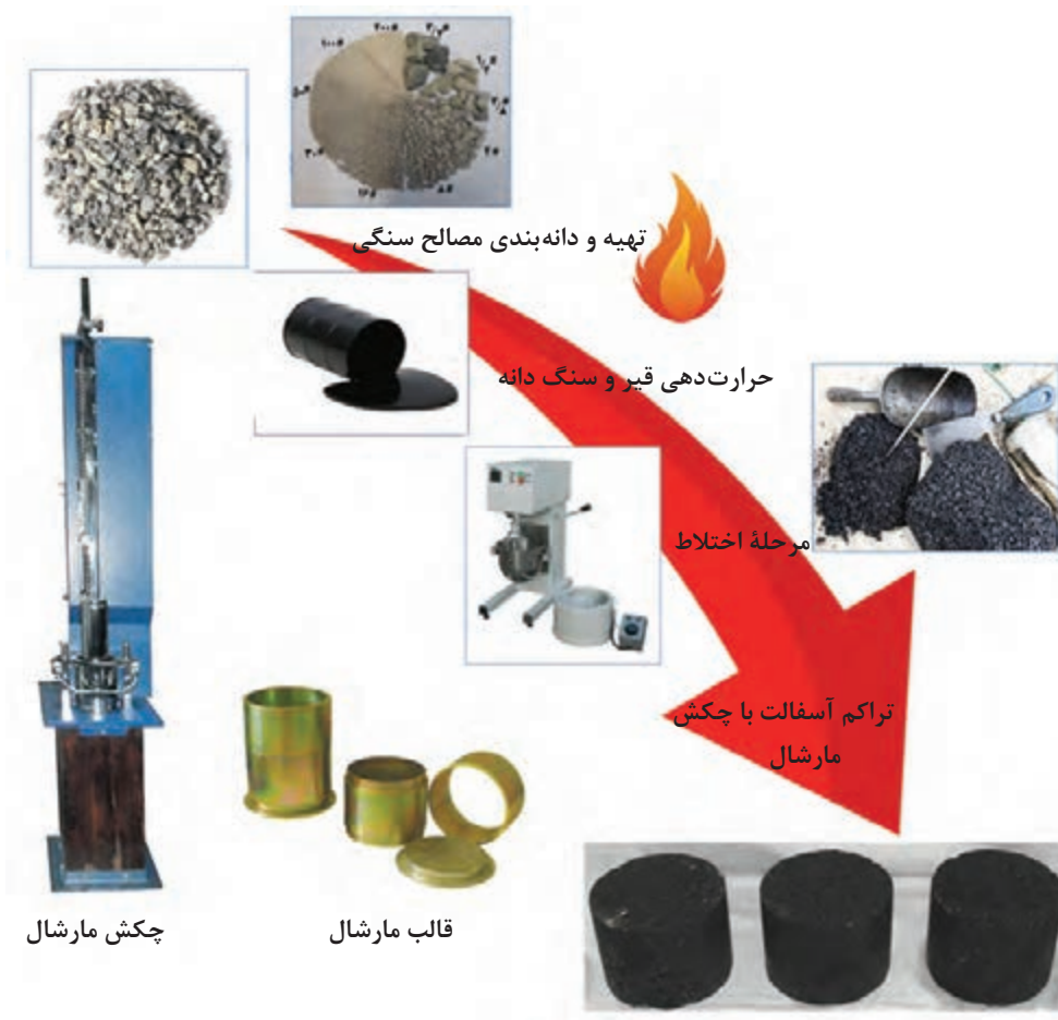
شکل ۲۹- فرایند تولید آسفالت در آزمایشگاه
