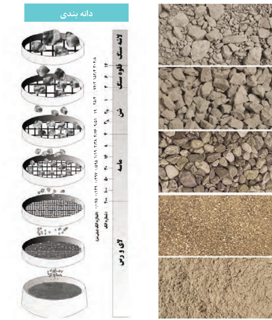
شکل ۸- دسته‌بندی سنگ دانه‌ها براساس آزمایش دانه‌بندی
