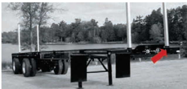
شکل ۲۰- قرار گرفتن ستون‌ها در جاستون‌ها روی کفی
