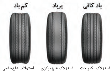
شکل ۱۲- نمایش تایر (باد کافی، پر باد، کم باد)
