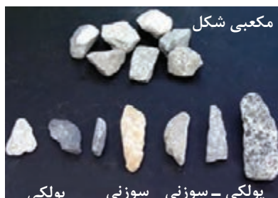
شکل ۶- انواع سنگ دانه‌ها از لحاظ شکل ظاهری
