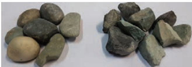
شکل ۵- سنگ دانه درشت، شن گرد (چپ) و شن گوشه‌دار (راست)
