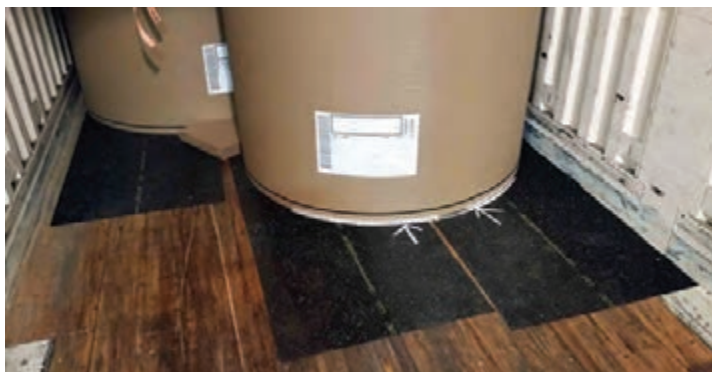
شکل ۱۴- نمونه ای از لایه های افزایشده اصطکاک
