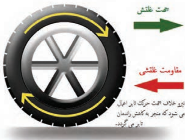
شکل ۱- جهت غلتش تایر و مقاومت غلتشی
