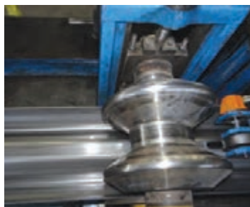
شکل ۴- ساخت و تولید گاردریل به روش نورد
