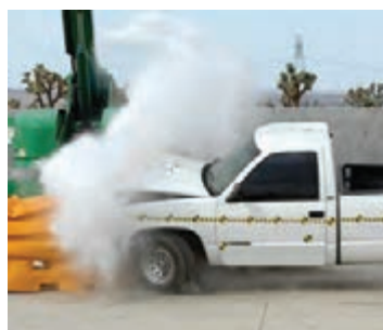
شکل ۱۲- تخریب ضربه‌گیرهای وزنی بشکه‌ای بعد از برخورد
