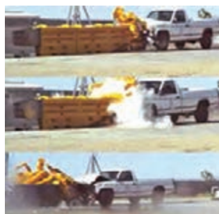
شکل ۱۱- عملکرد ضربه‌گیر وزنی بشکه‌ای شکل در هنگام برخورد
